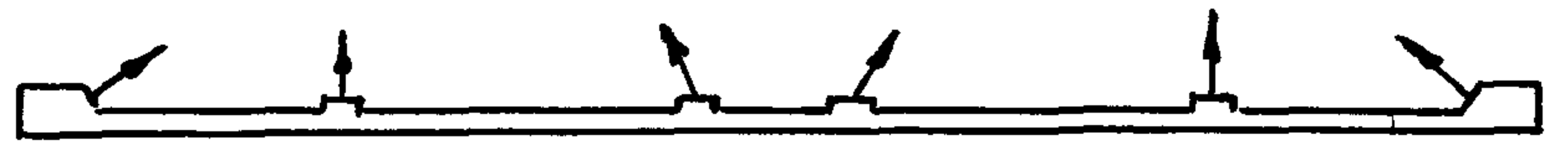
Схема строповки нижнего пояса при подъеме
