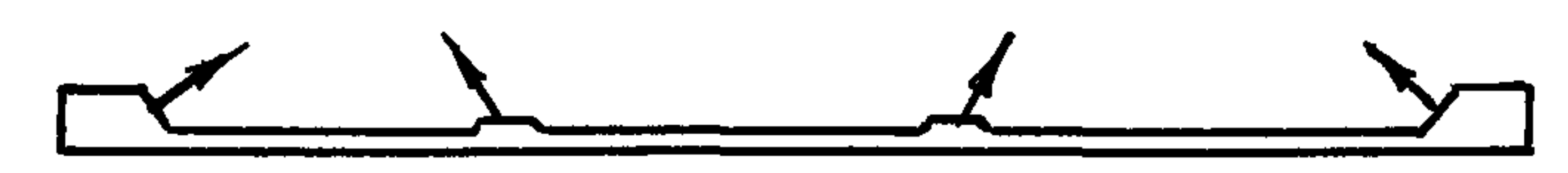
Схема строповки нижнего пояса фермы при подъеме
