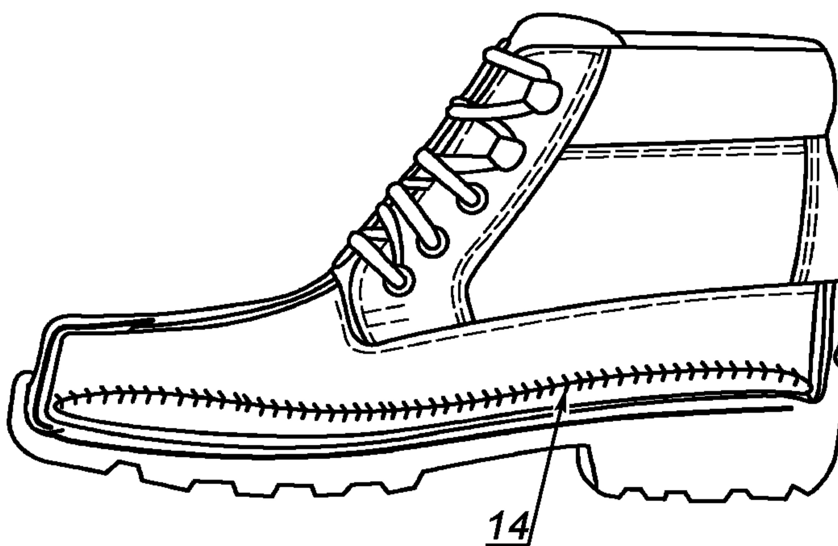
1 — передняя часть; 2 — язычок; 3 — мягкий кант; 4 — верх обуви; 5 — подкладка союзки; 6 — вкладная стелька; 7 — подносок; 8 — покрытие края, например полоса из поролона; 9 — подошва; 10 — протектор; 11 — антипрокольная стелька; 12 — основная стелька; 13 — каблук; 14 — ниточное крепление ;15 — задник; 16 — союзка
