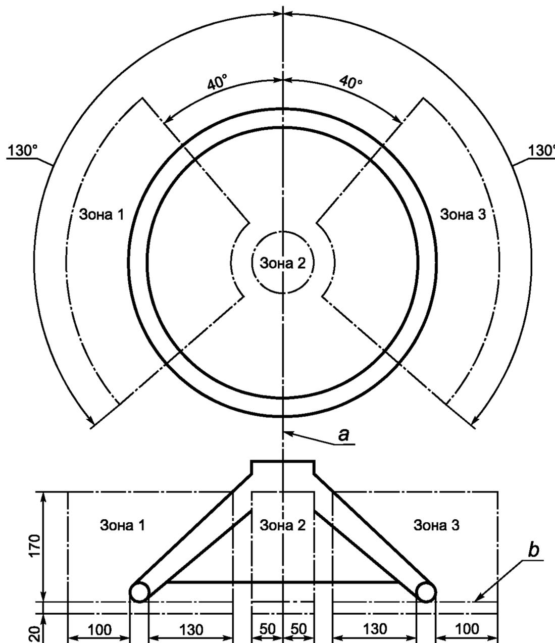
*a* — ось рулевого колеса; *b* — плоскость рулевого колеса
