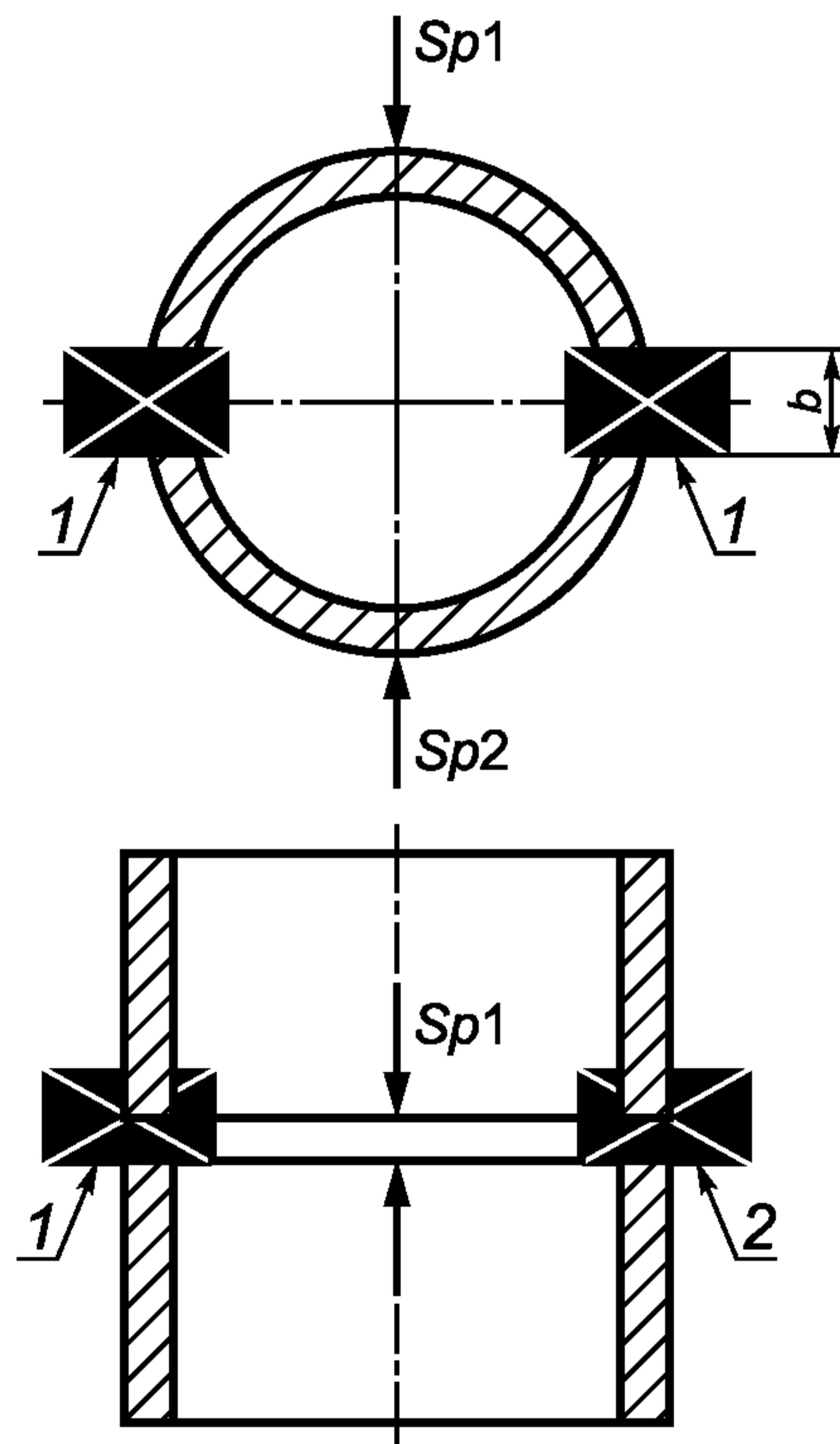
1, 2 — зажимы (эксцентрично расположенные под углом  $90^\circ$  относительно направляющих);  $Sp1$  — верхняя точка измерения;  $Sp2$  — нижняя точка измерения;  $b$  — ширина зажима;  $b = (d_n - e)\pi/100$  (минимум 10 мм), где  $d_n$  — номинальный наружный диаметр трубы;  $e$  — толщина стенки трубы
