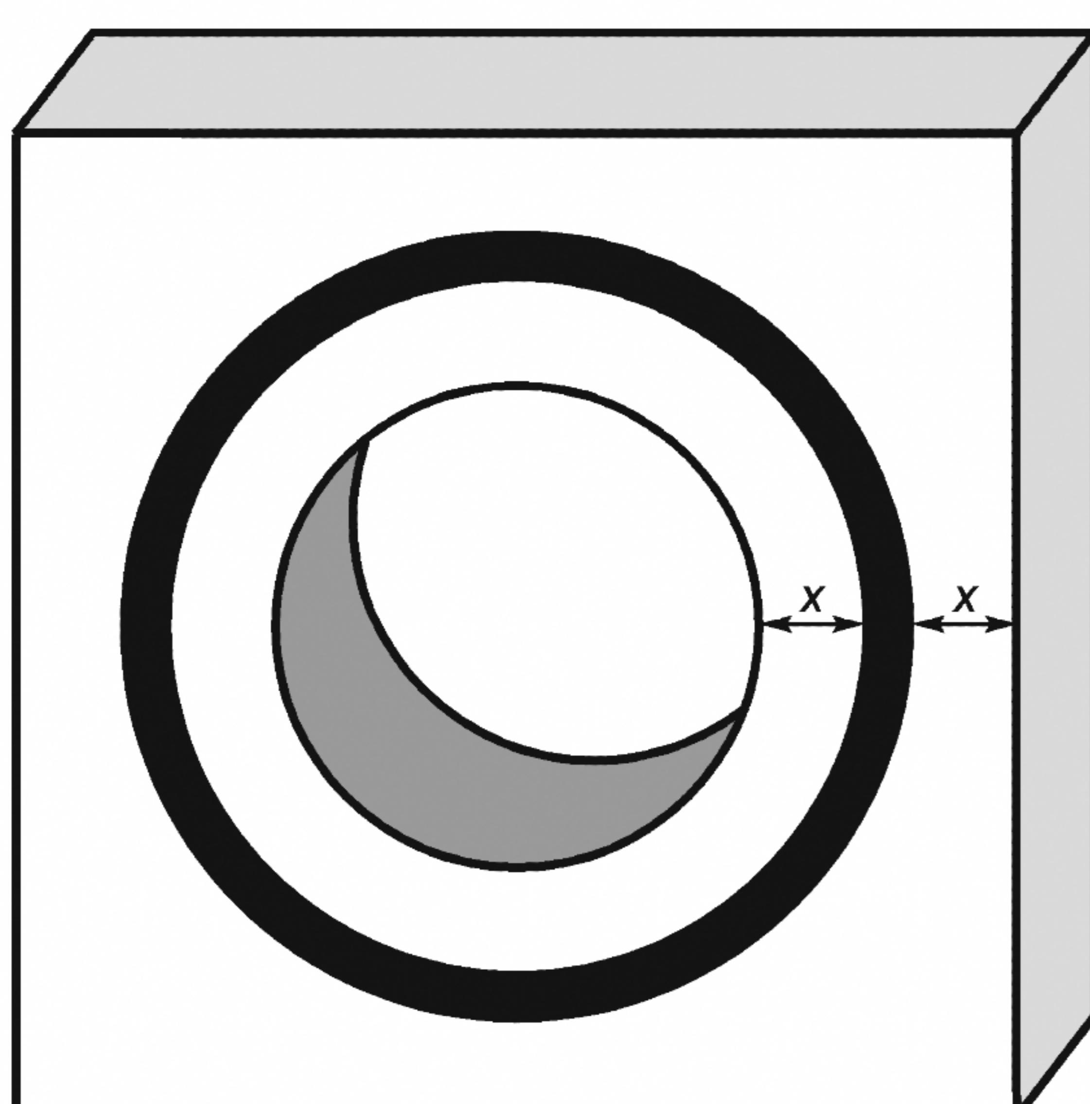
$x \geq 10$  мм для  $d_h \leq 250$  мм и  $x \geq 15$  мм для  $d_h > 250$  мм
