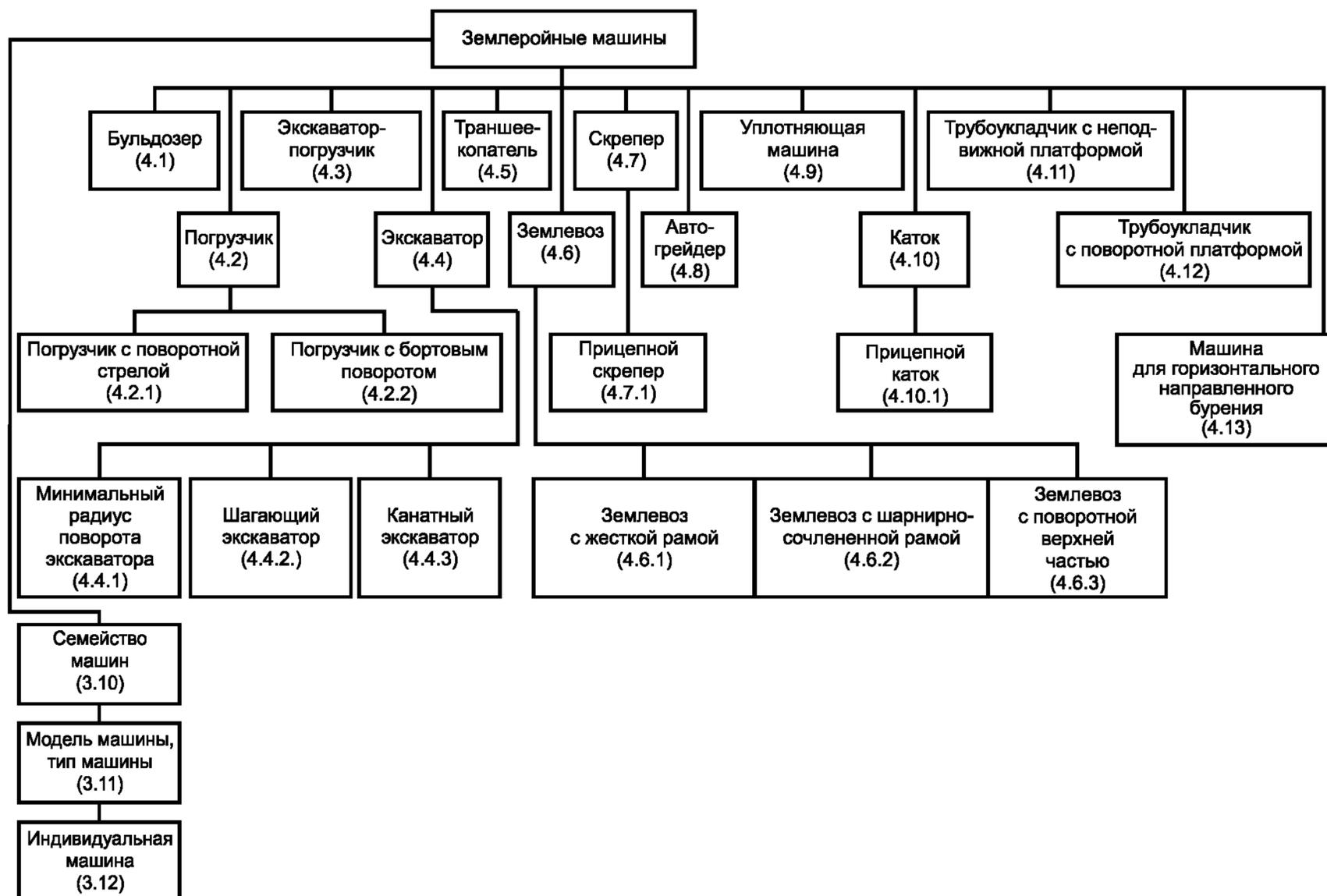
Рисунок А.1 — Схема идентификации землеройной машины
