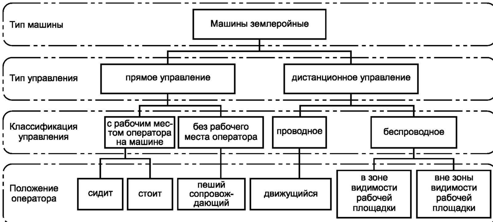
Рисунок В.1 — Варианты управления землеройной машиной
