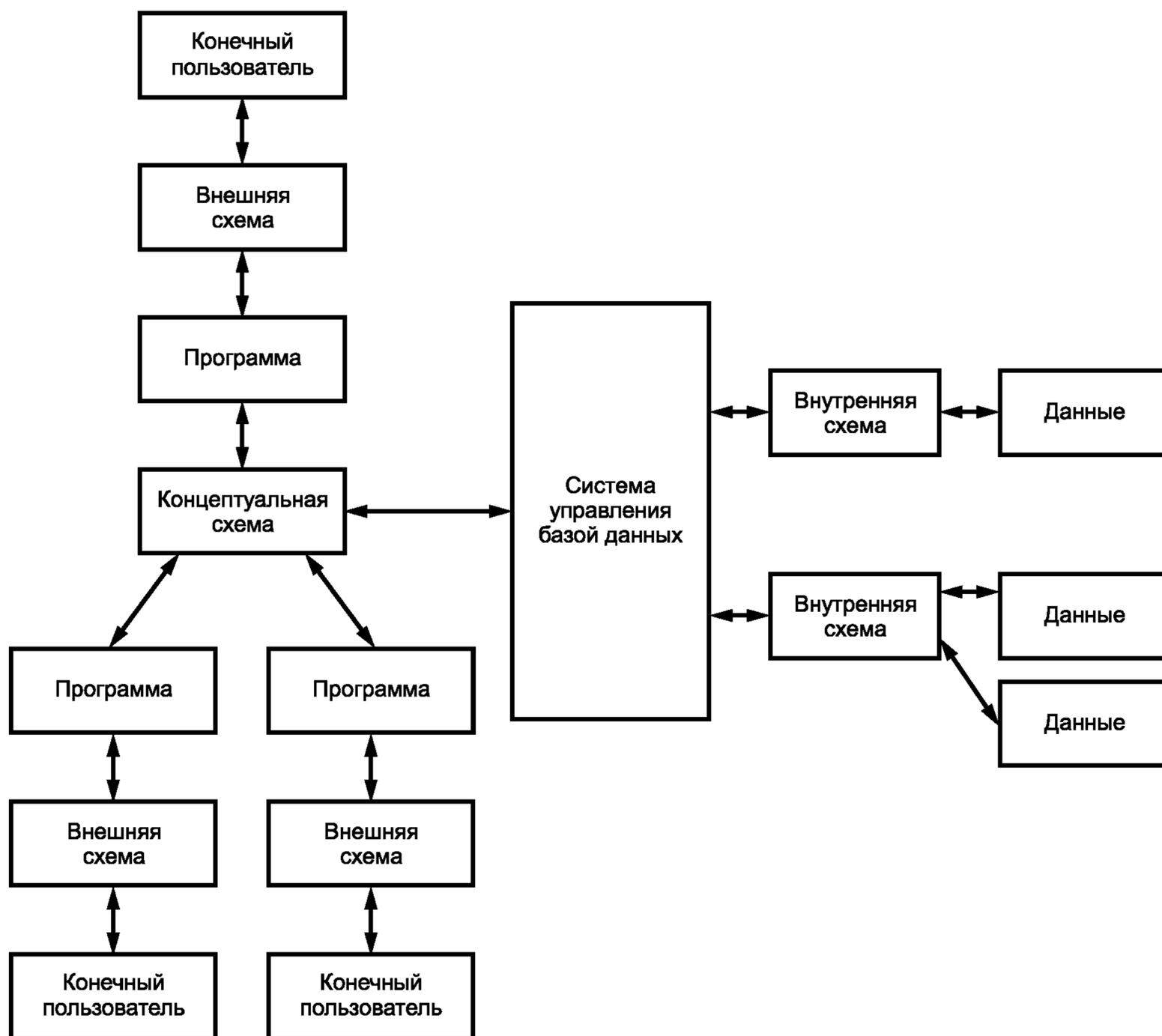
Рисунок 2 — Трехсхемная архитектура информационной системы
