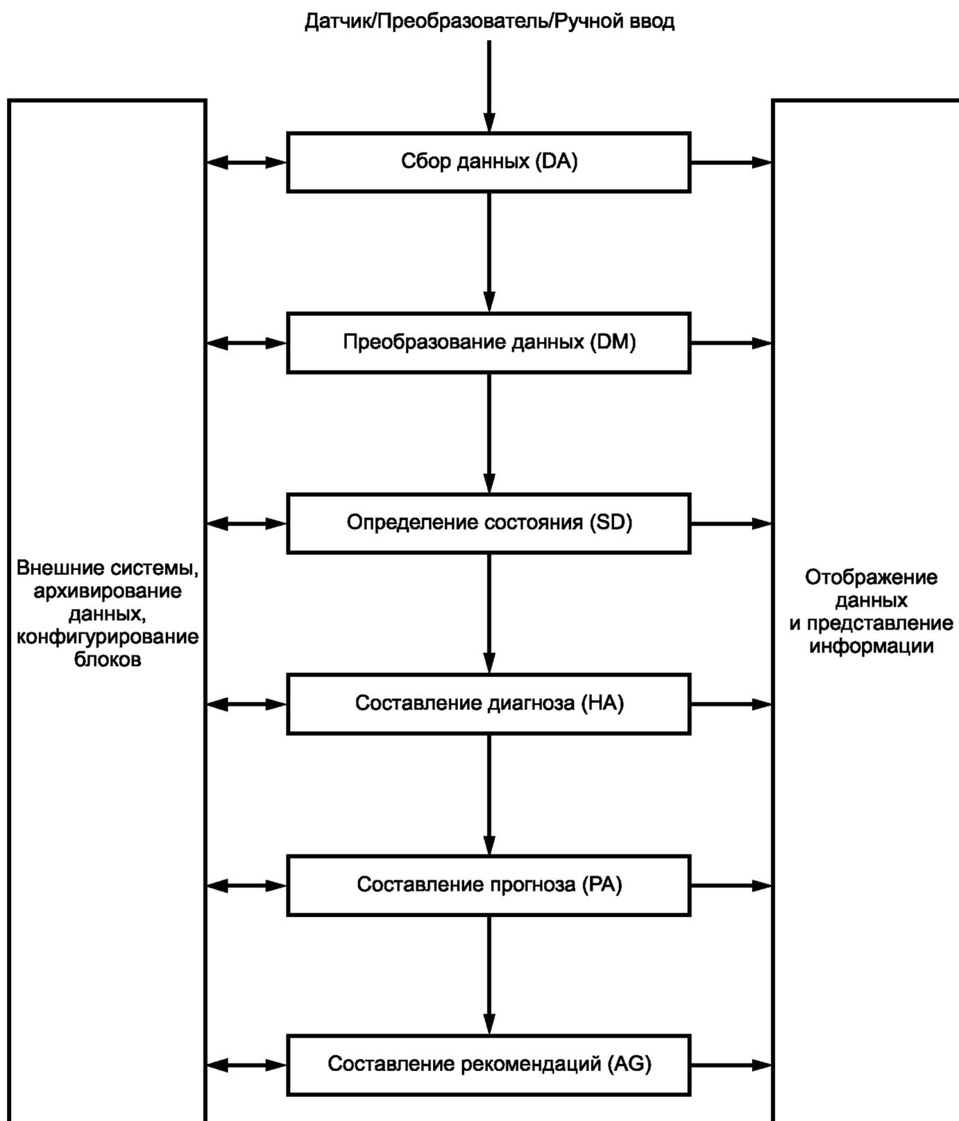
Рисунок 1 — Блок-схема потока информации и этапов обработки данных
