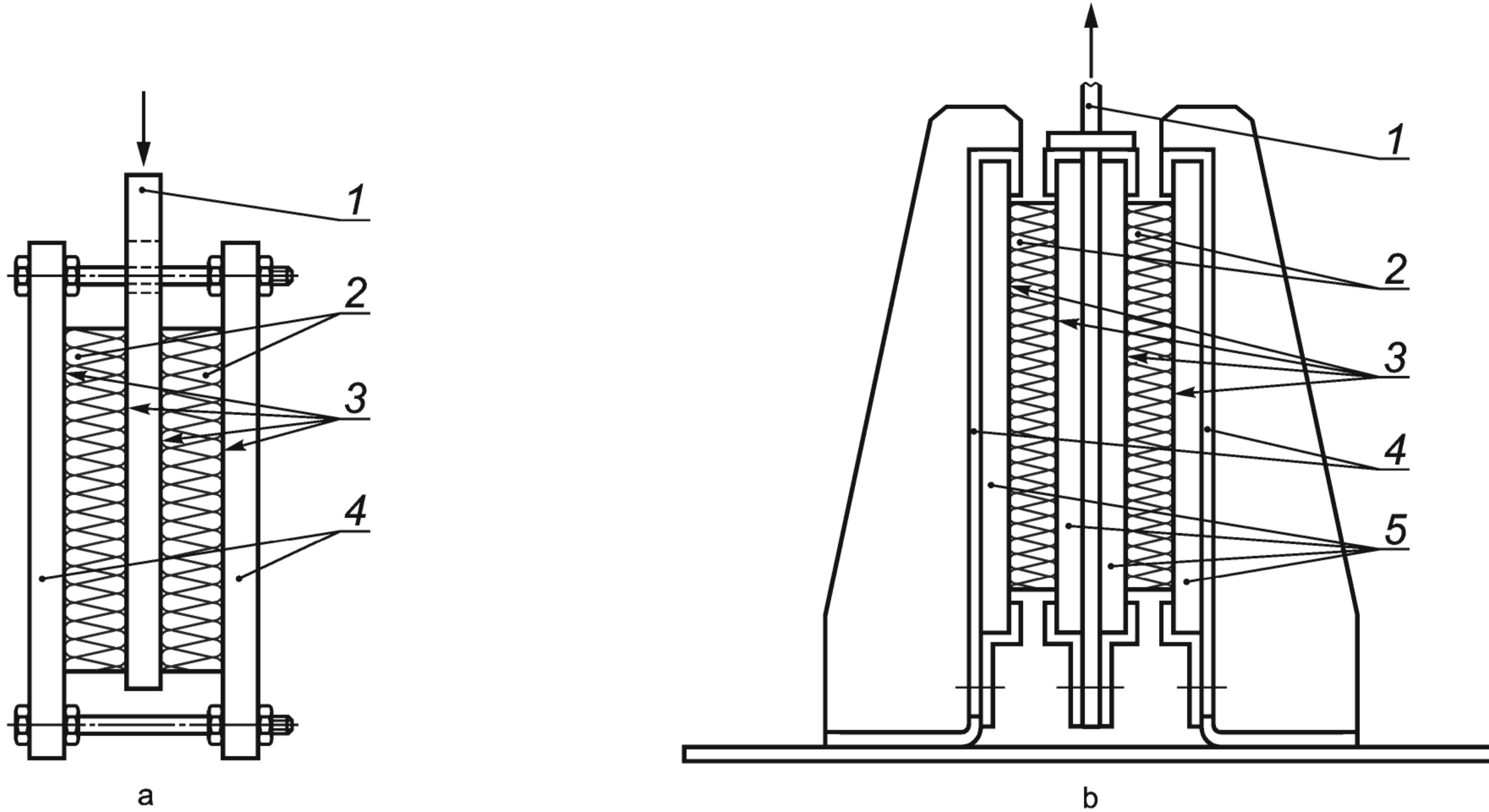
1 — нагружающая пластина (длина 300, ширина 100, толщина 16 мм); 2 — образцы (длина 200, ширина 100 мм); 3 — kleящее вещество; 4 — металлические держатели для образцов (длина 300, ширина 100, толщина 16 мм)
