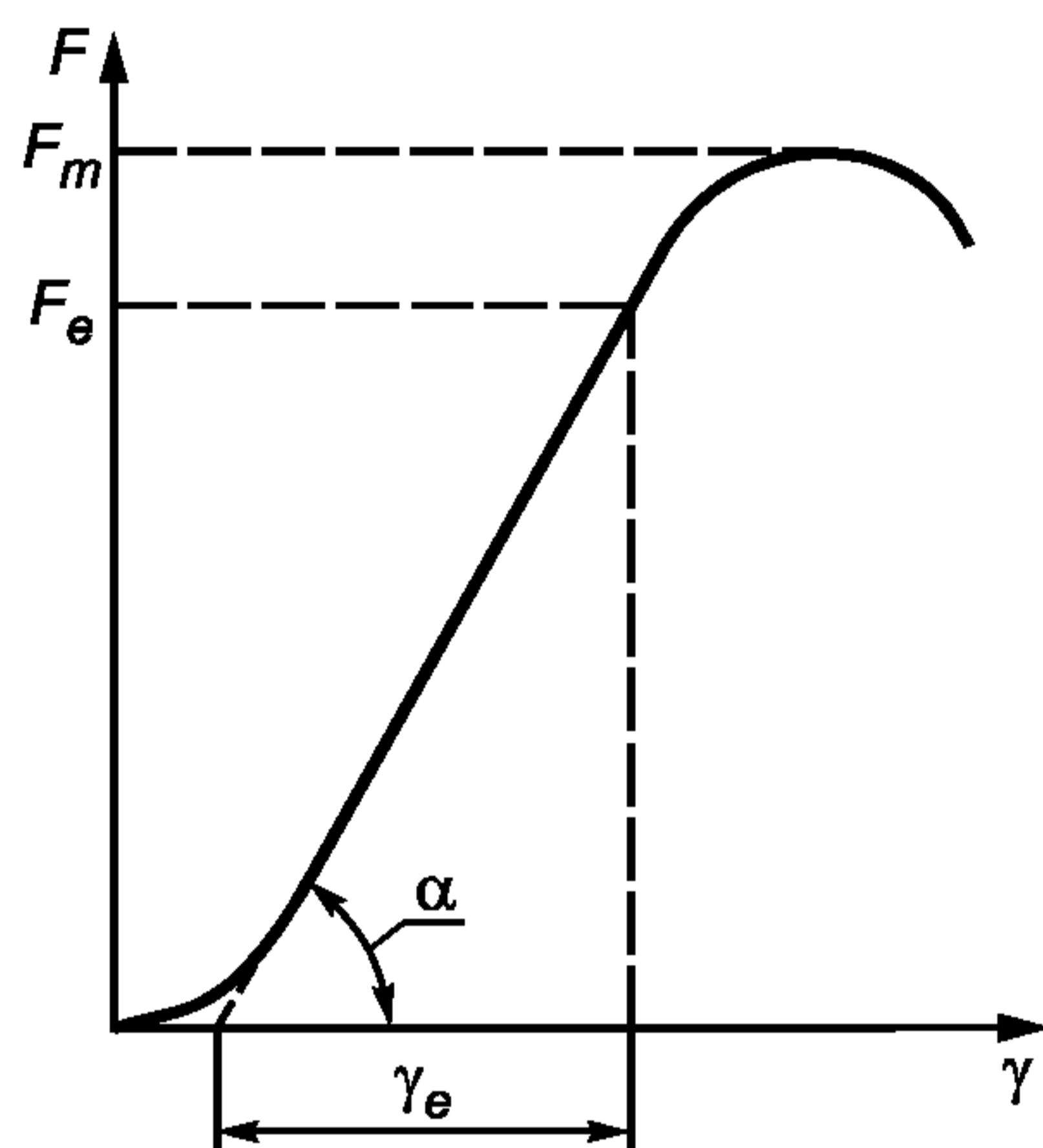
Рисунок 3 — Кривая зависимости сдвига от силы
