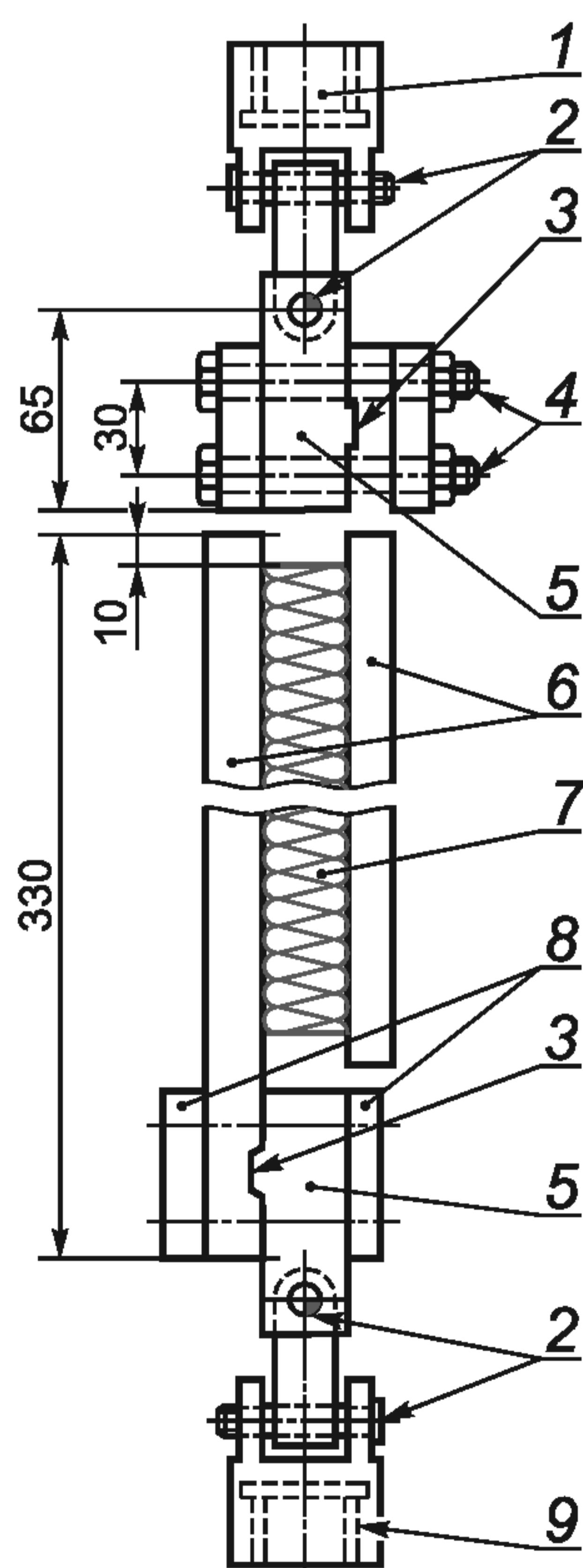
1 — неподвижный захват испытательной машины; 2 — соединительные шипы универсального соединения; 3 — гребень и паз; 4 — крепление из гаек и болтов; 5 — адаптер; 6 — держатели для образца (длина 330, ширина 50, толщина 16 мм); 7 — образец (длина 250, ширина 50 мм); 8 — пластины распределения нагрузки; 9 — подвижный захват испытательной машины
