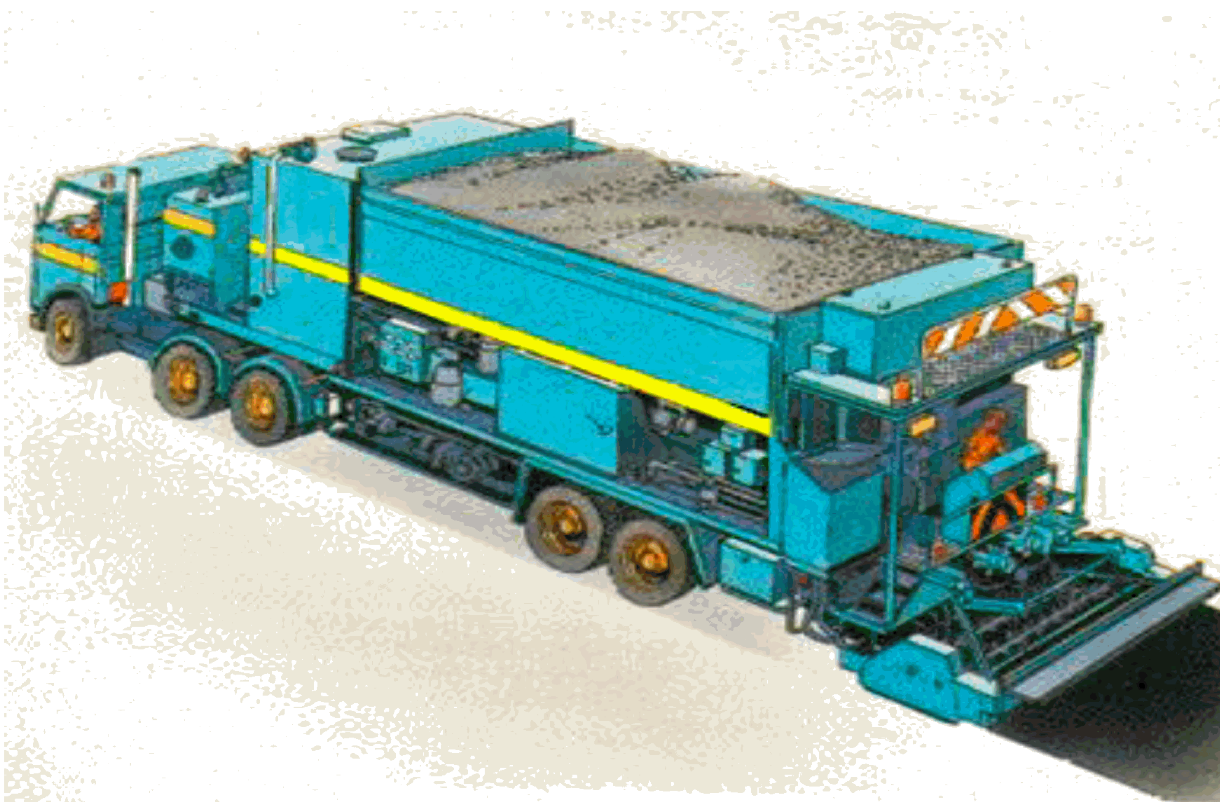
Рисунок Ф.2 - Общий вид машины для устройства литой эмульсионно-минеральной смеси
