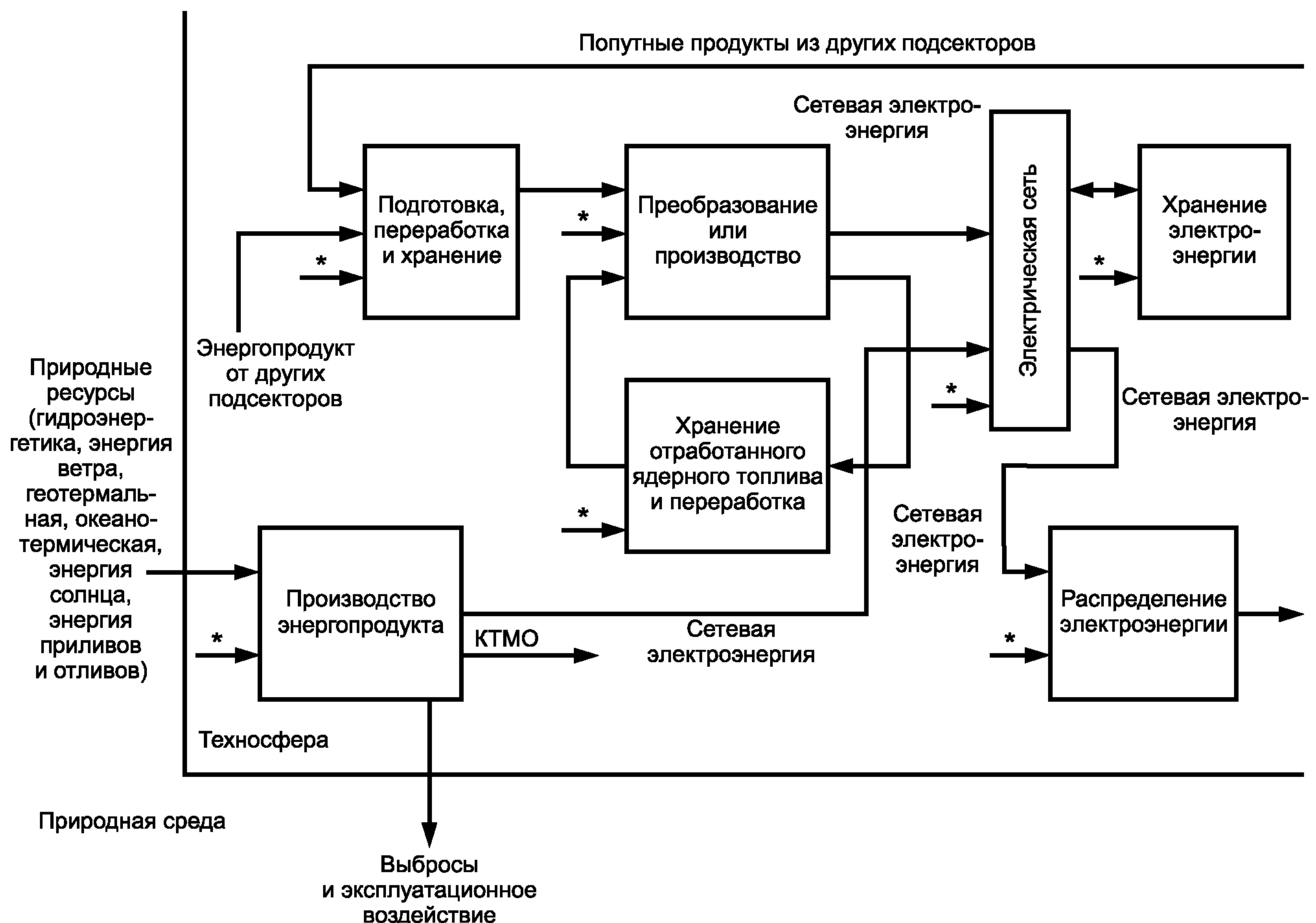
Рисунок 12 — Модельная структура технических энергетических систем в подсекторе получения электроэнергии от энергосистемы
