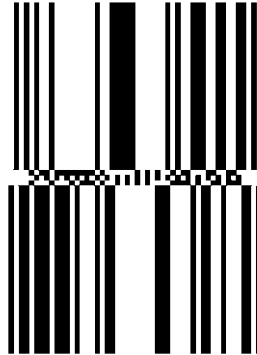
Рисунок 6 — Символ GS1 DataBar Двустрочный Всенаправленный, представляющий номер (01)00034567890125
