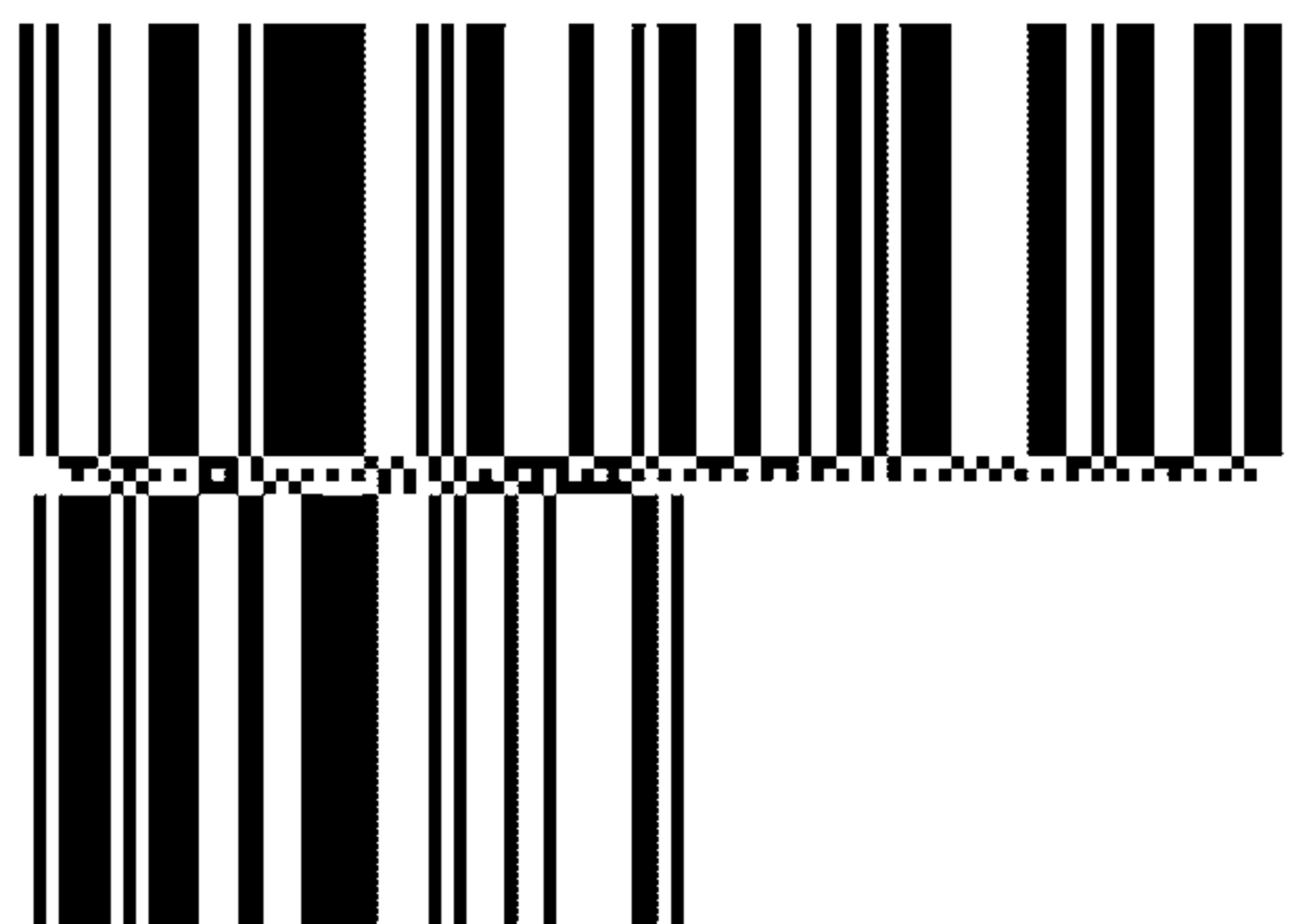
Рисунок 13 — Символ GS1 DataBar Расширенный Многострочный, представляющий номер (01)95012345678903(3103)000123
