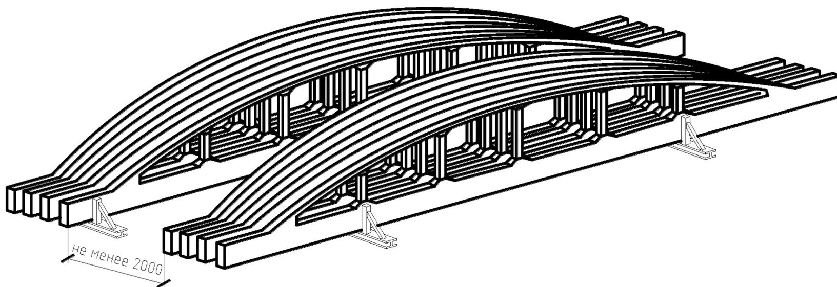
Рисунок 6 – Схемы опирания при транспортировке и хранения ферм
