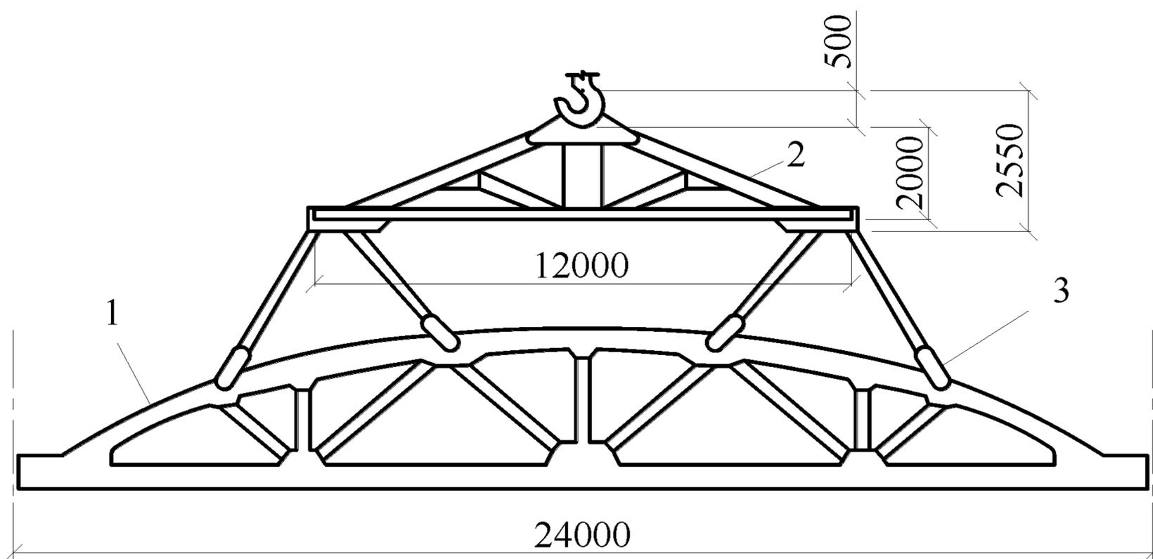
1 – ферма, 2 – траверса, 3 – полуавтоматический металлический захват
