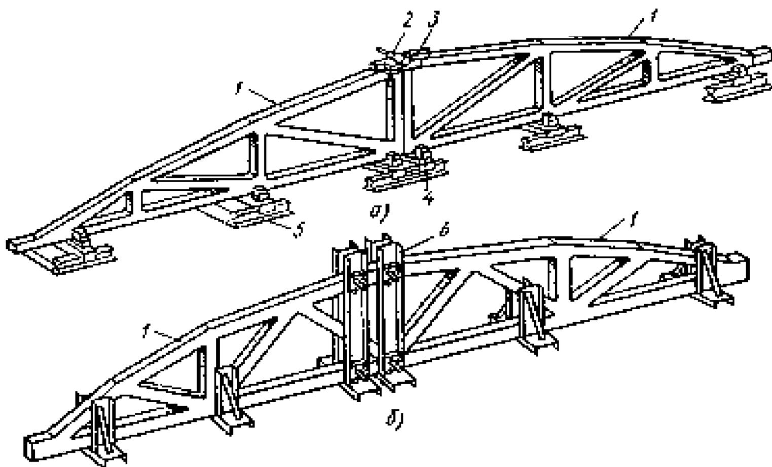
*a)* на специализированном стенде, *б)* в кассетах с парными стойками
