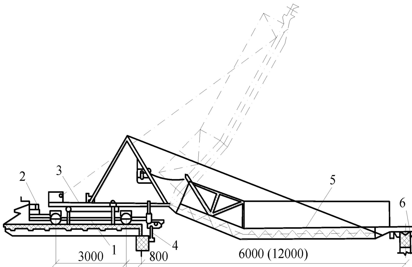
1 – тележка, 2 – натяжное устройство, 3 – каретка, 4 – фиксирующий упор, 5 – стрела, 6 – монтируемая ферма
