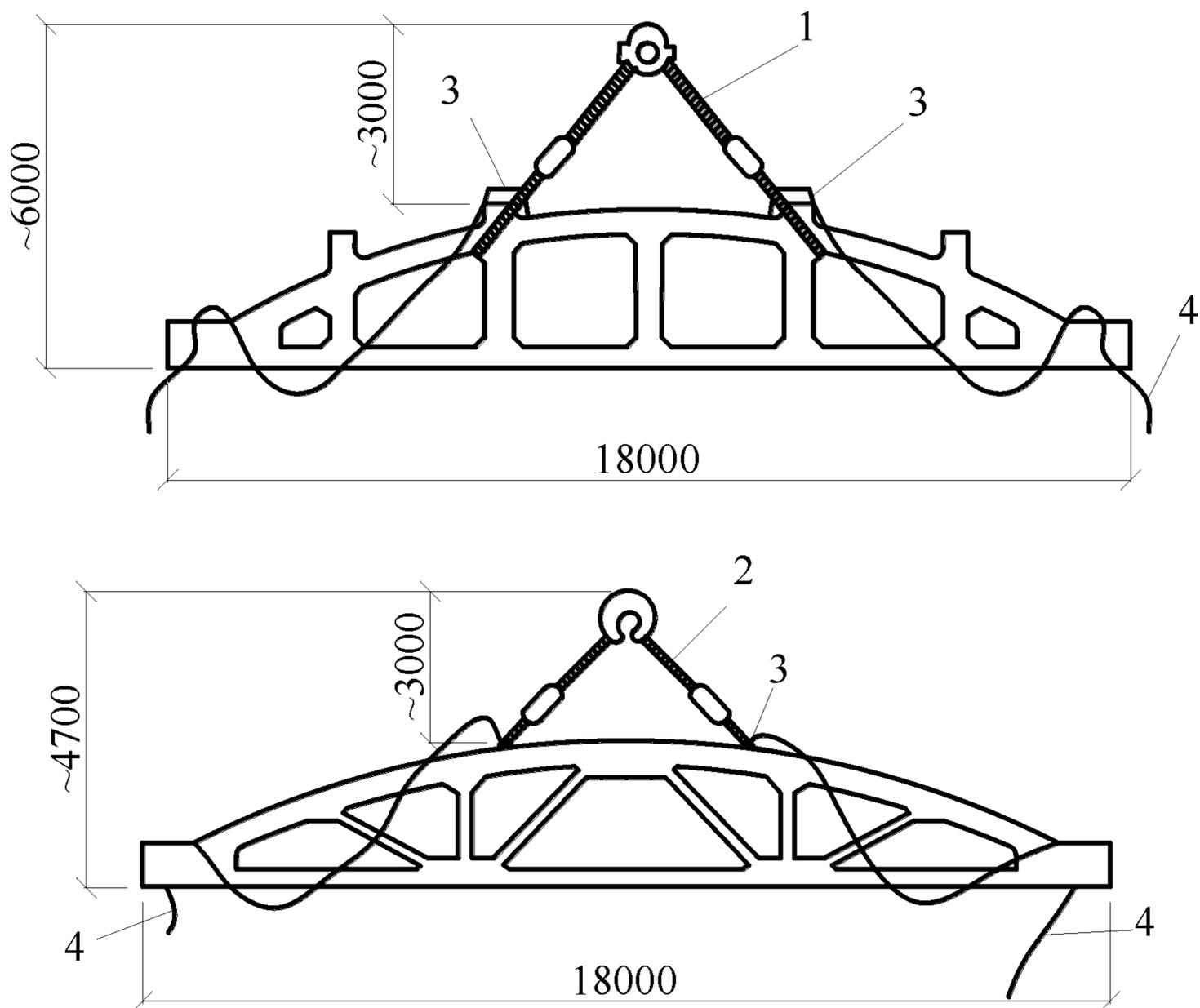
1 – строп 2СТ-10/4000, 2 – строп СККІ-8/3200, 3 – пружинный замок Пр8;
