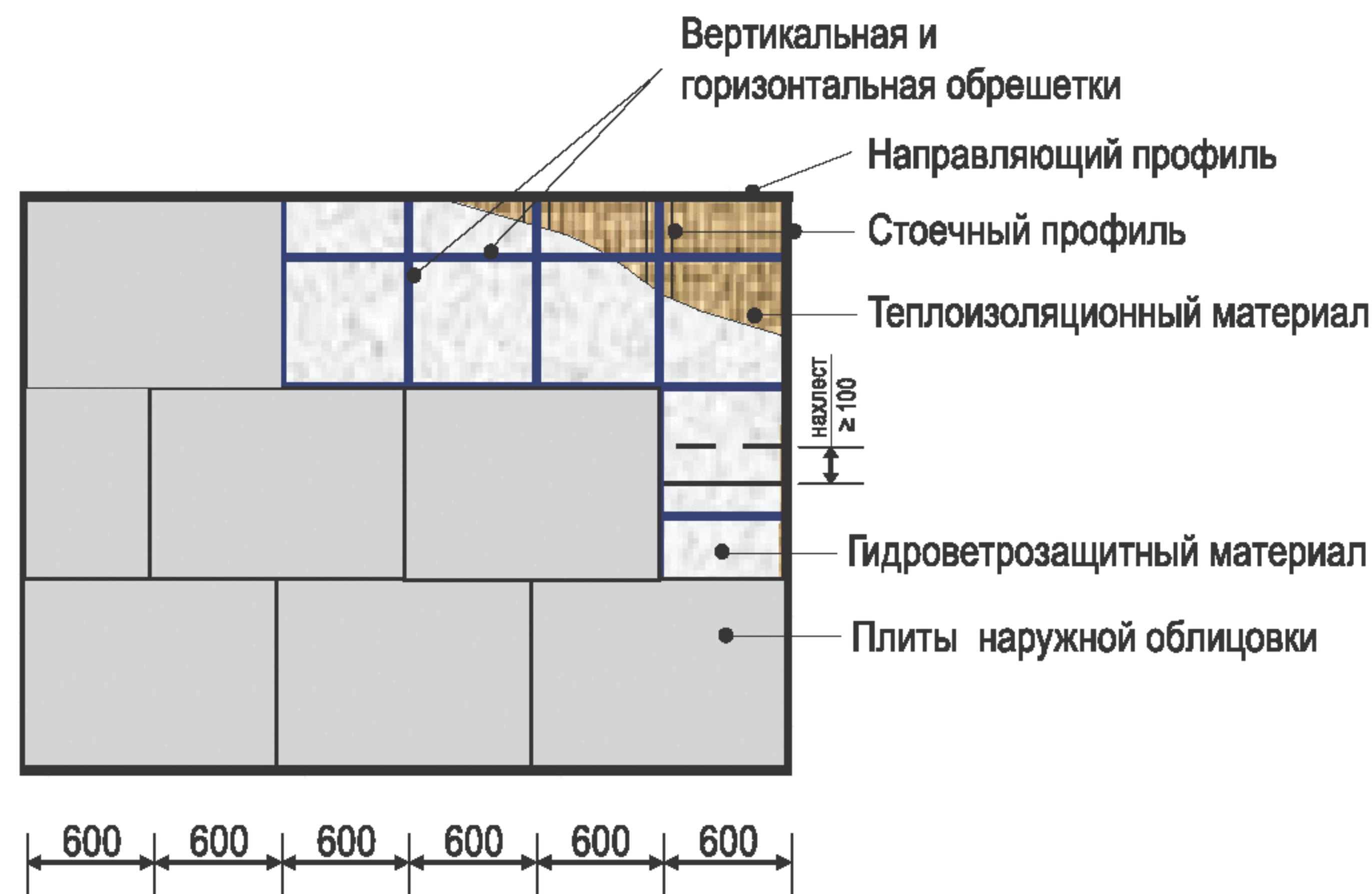
Рис. 13. Крепление наружной облицовки к каркасу
