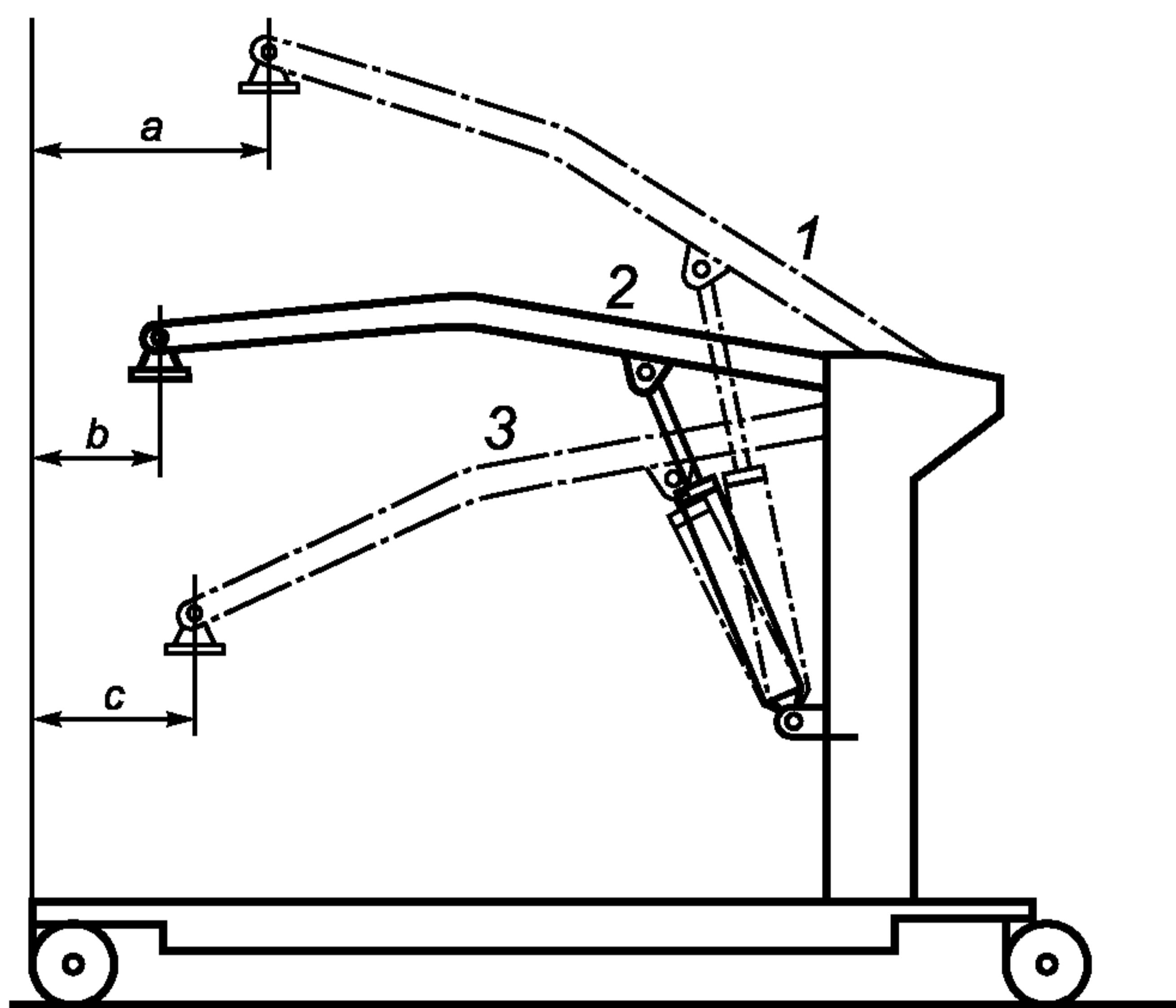
1 — самое высокое положение; 2 — среднее положение; 3 — самое низкое положение; a — минимальное расстояние от стены до ЦТП при максимальной высоте (со стороны ног); b — минимальное расстояние от стены до ЦТП при максимальном выносе вперед (со стороны ног); c — минимальное расстояние от стены до ЦТП при минимальной высоте (со стороны ног)
