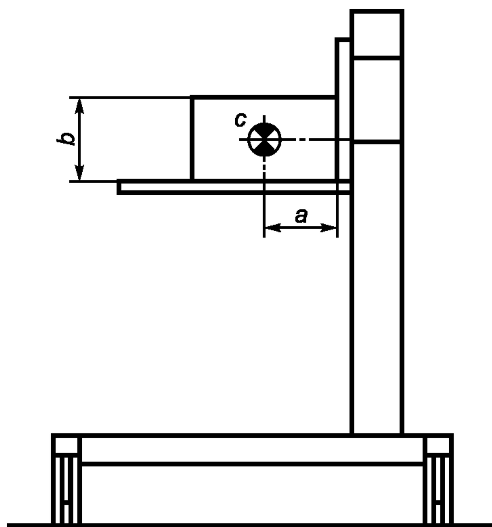
*a* — ширина, в миллиметрах, = 2 × максимальная нагрузка, в килограммах; *b* — высота = 200 мм; *c* — центр тяжести
