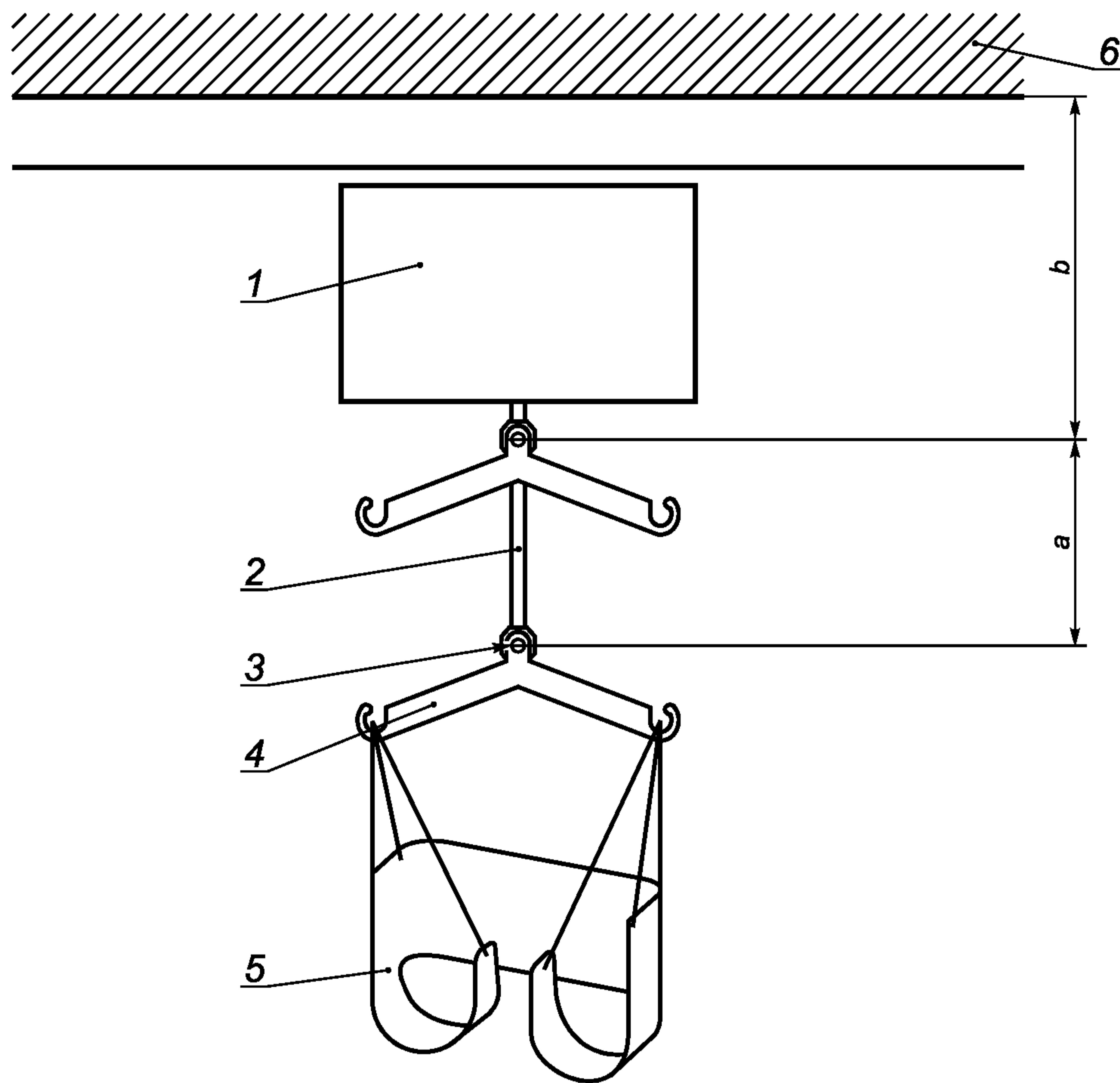
1 — подъемный механизм; 2 — гибкий элемент; 3 — ЦТП; 4 — распорка; 5 — нежесткая система опоры тела; 6 — потолок;
