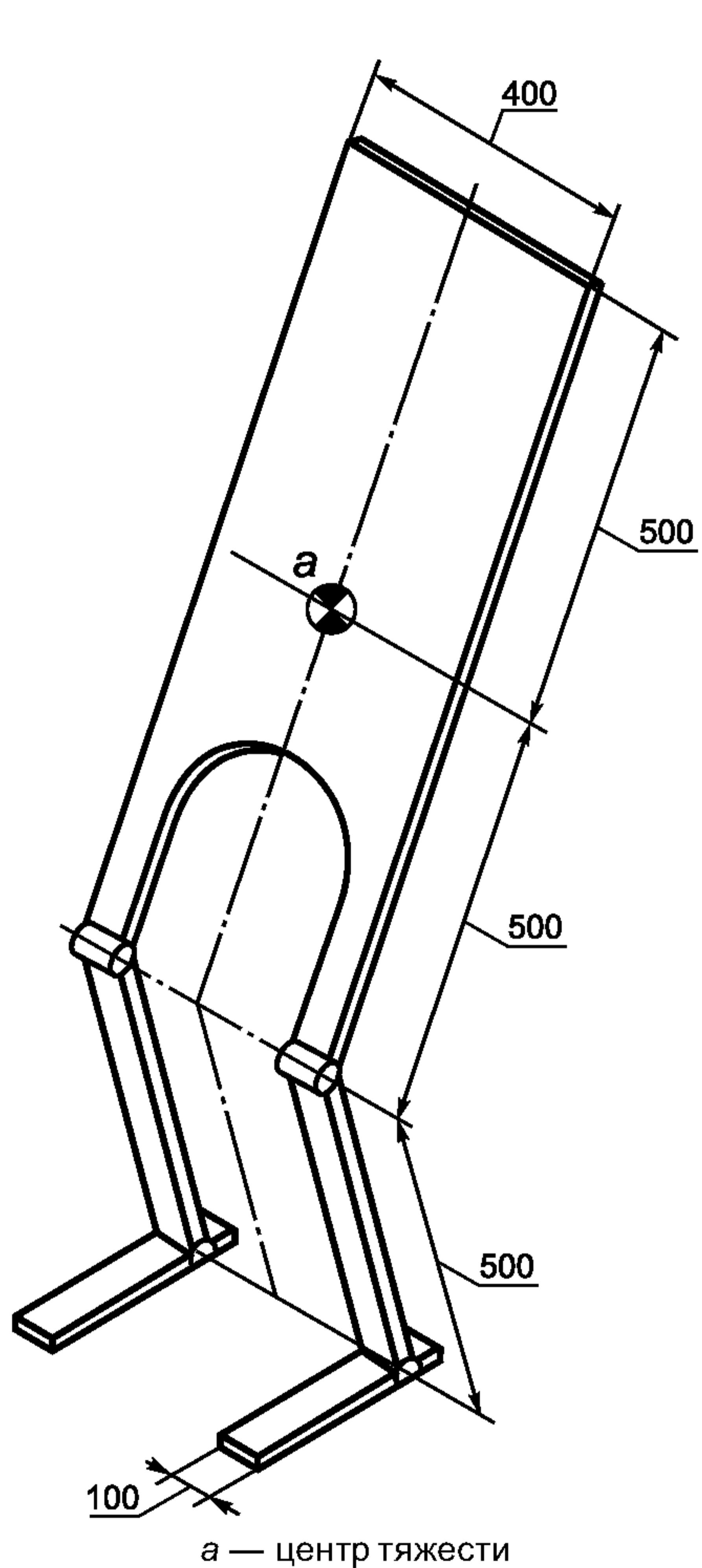
Рисунок 2 — Испытательный макет для поддерживающих и/или приподнимающих подъемников
