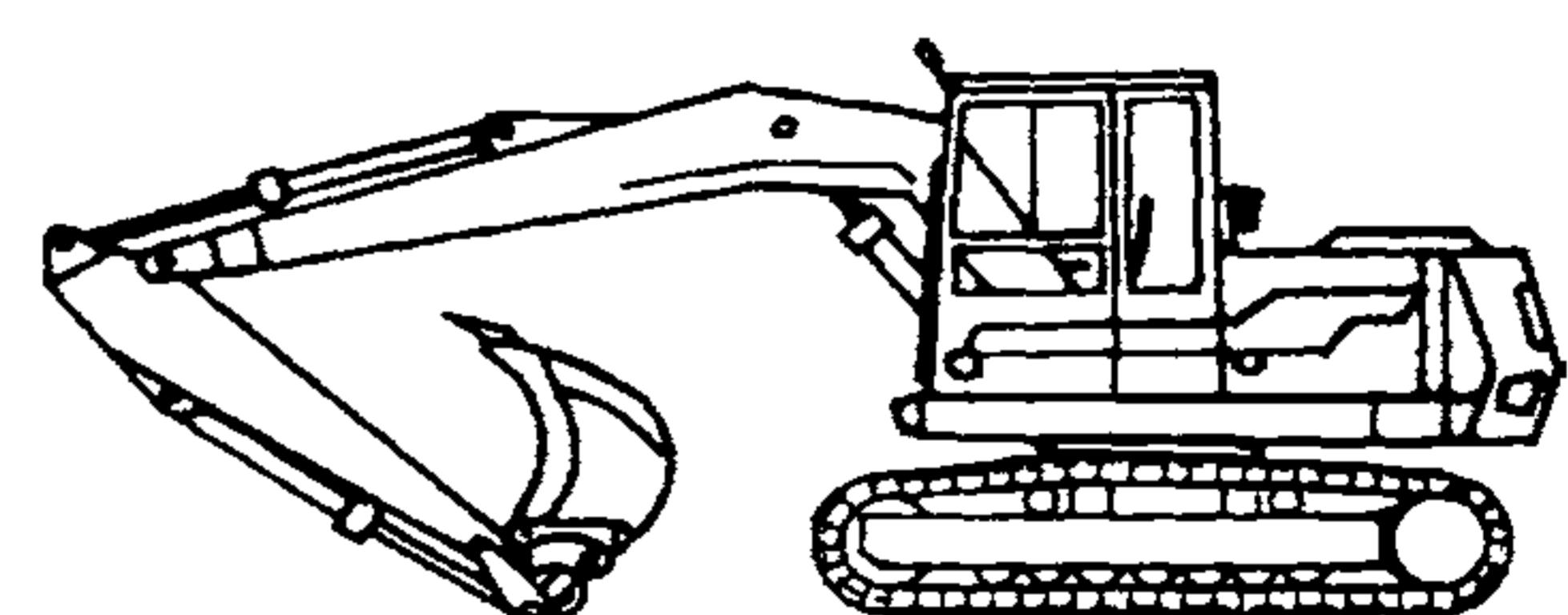
Рисунок G.10 — Гидравлический гусеничный экскаватор
