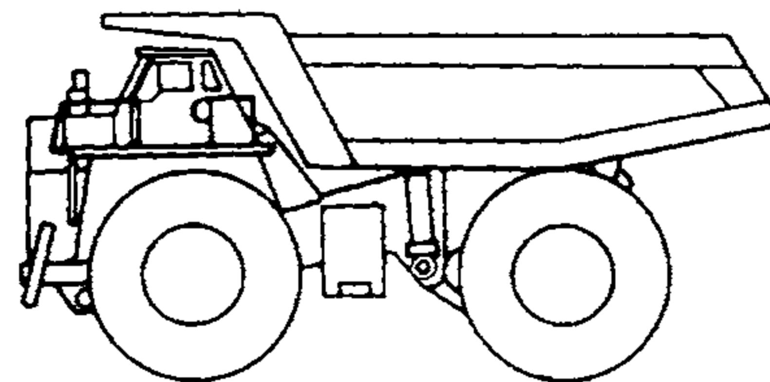
Рисунок G.6 — Землевоз с жесткой рамой
