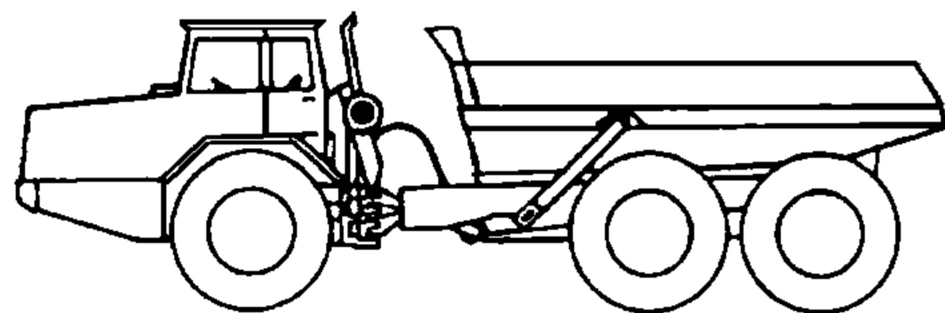
Рисунок G.5 — Землевоз с шарнирно-сочлененной рамой
