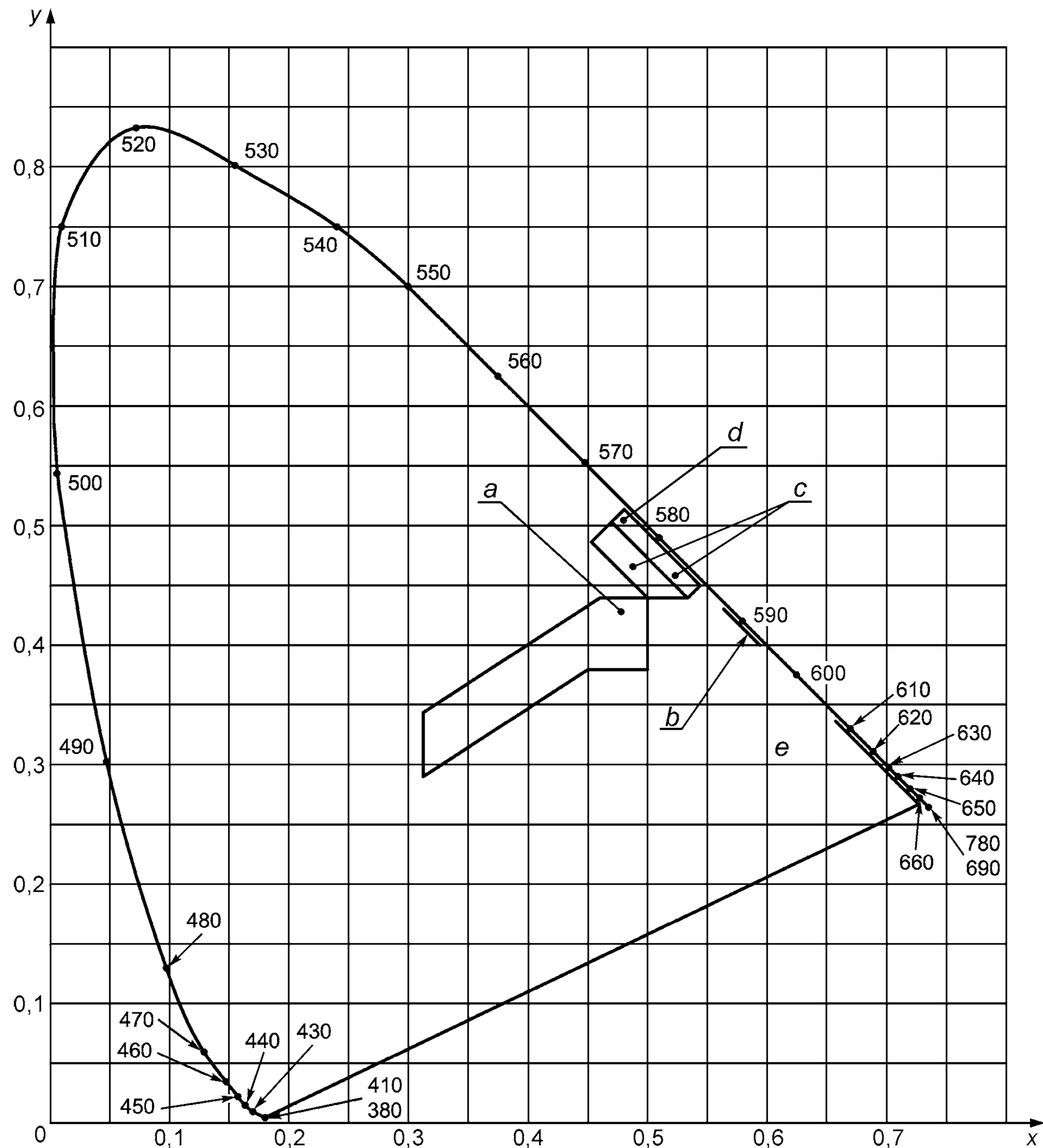
Диаграмма, отображающая зоны СИЕ цветового треугольника, построенная в соответствии с пределами таблицы D.1
