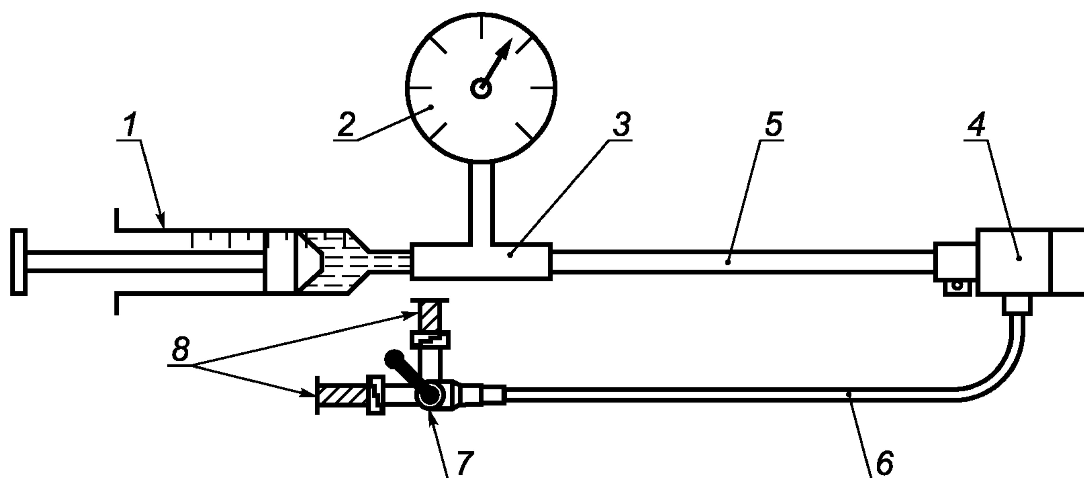
1 — шприц объемом 10 мл (D.3.2.); 2 — манометр; 3 — герметичное соединение (D.3.3); 4 — кровоостанавливающий клапан (выходное отверстие перекрыто); 5 — оболочка интродьюсера; 6 — боковое устройство ввода; 7 — запорный кран; 8 — закрытые выходные отверстия (D.3.3)
