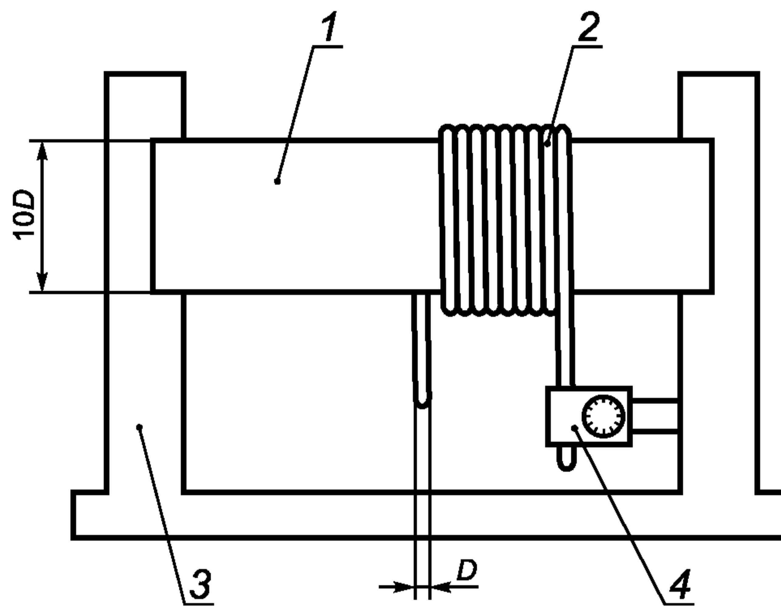
1 — цилиндрический валик; 2 — проводник; 3 — опоры; 4 — зажим
