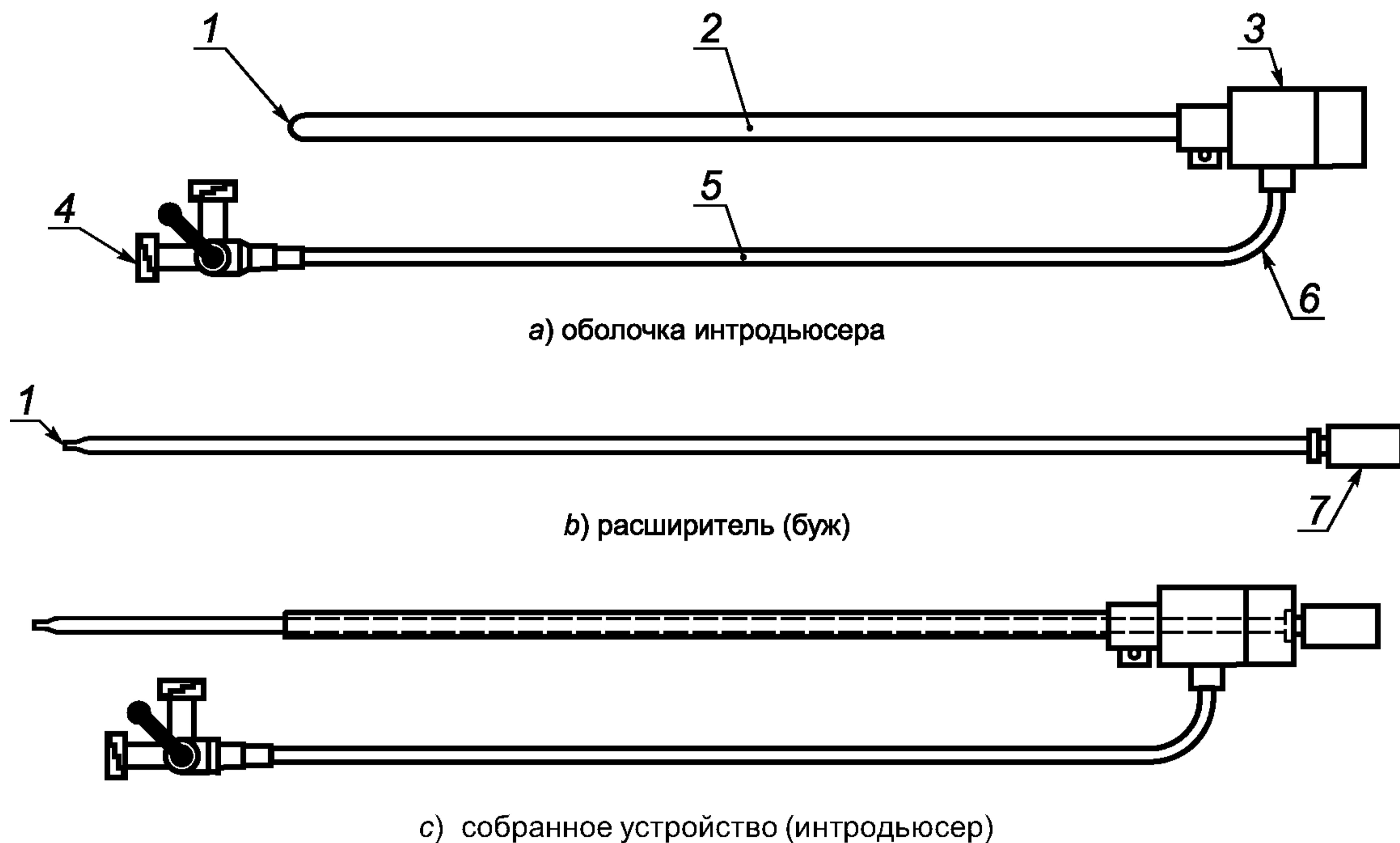
1 — дистальный конец; 2 — оболочка; 3 — кровеостанавливающий клапан; 4 — клапан с замком типа «Люэр»; 5 — боковое устройство ввода; 6 — соединительное устройство (опция); 7 — соединительная втулка
