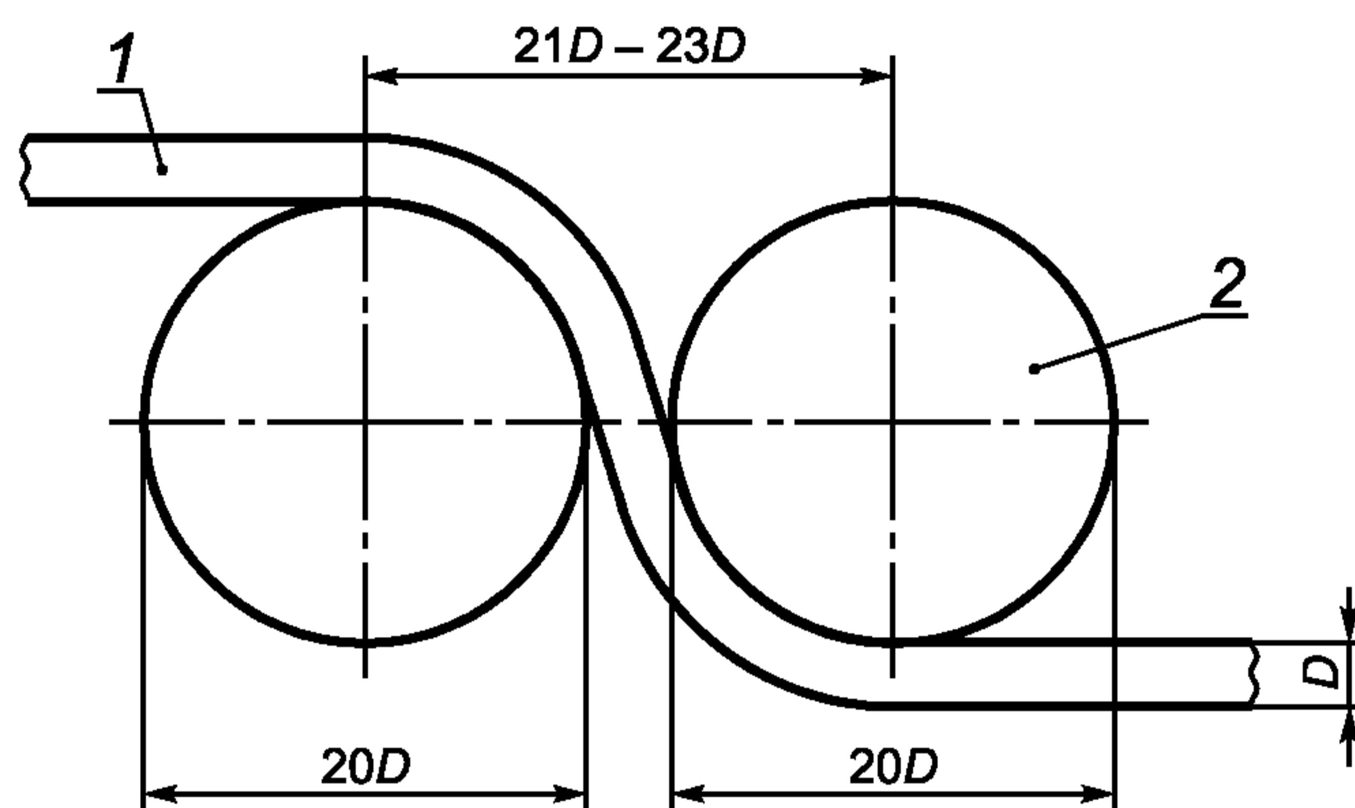
1 — проволочный проводник; 2 — цилиндрический валик
