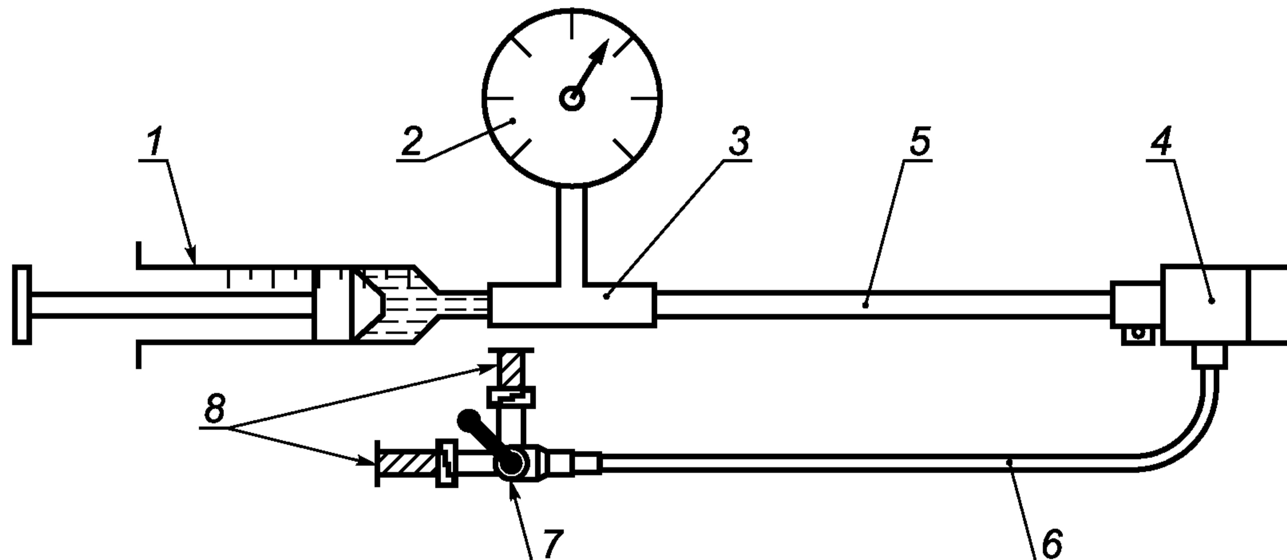
1 — шприц объемом 10 мл (E.3.2.); 2 — манометр; 3 — герметичное соединение (E.3.3); 4 — кровеостанавливающий клапан (выходное отверстие перекрыто); 5 — оболочка интродьюсера; 6 — боковое устройство ввода; 7 — запорный кран; 8 — открытые выходные отверстия (E.3.3)
