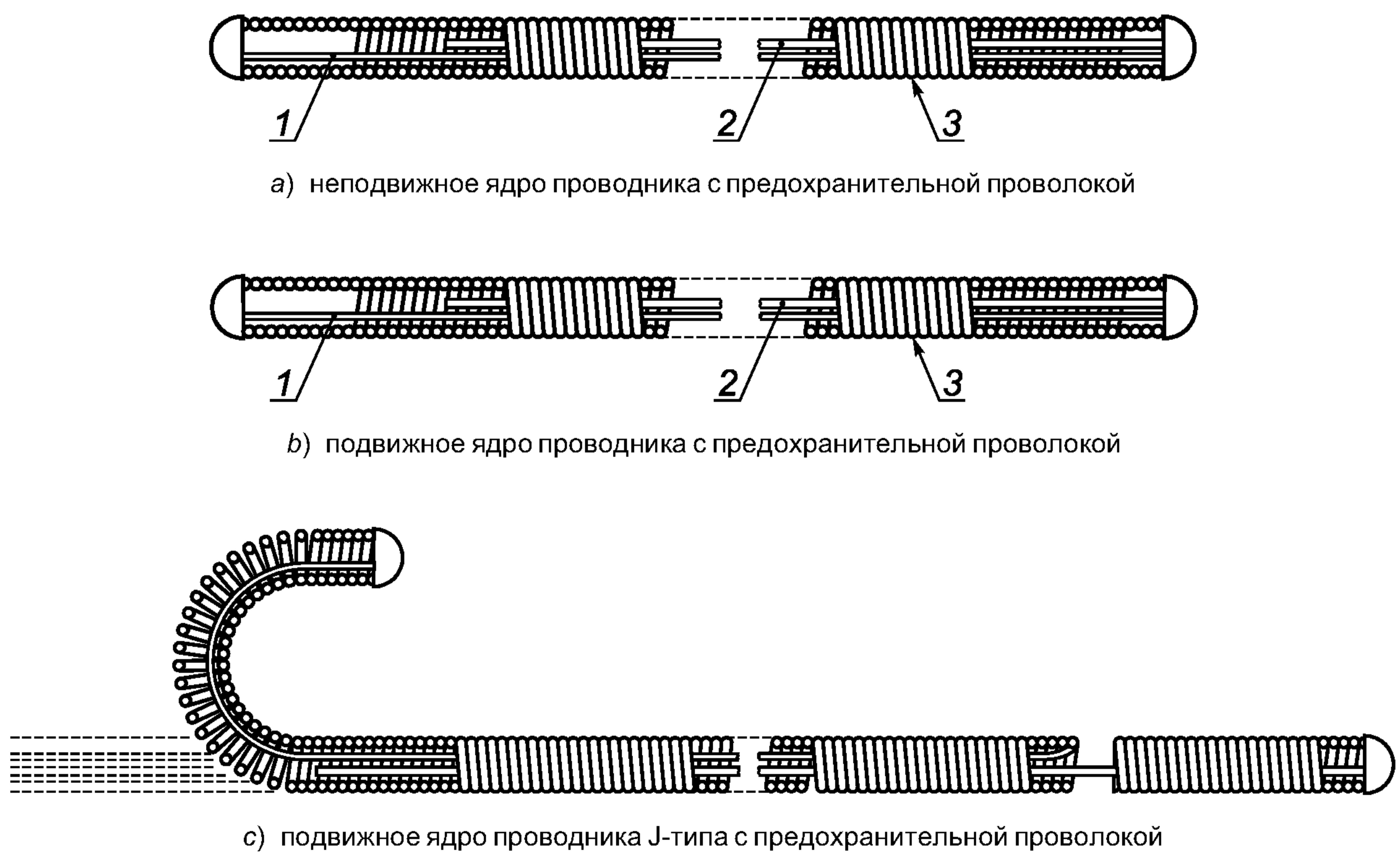
1 — предохранительная проволока; 2 — ядро проводника; 3 — оболочка проводника
