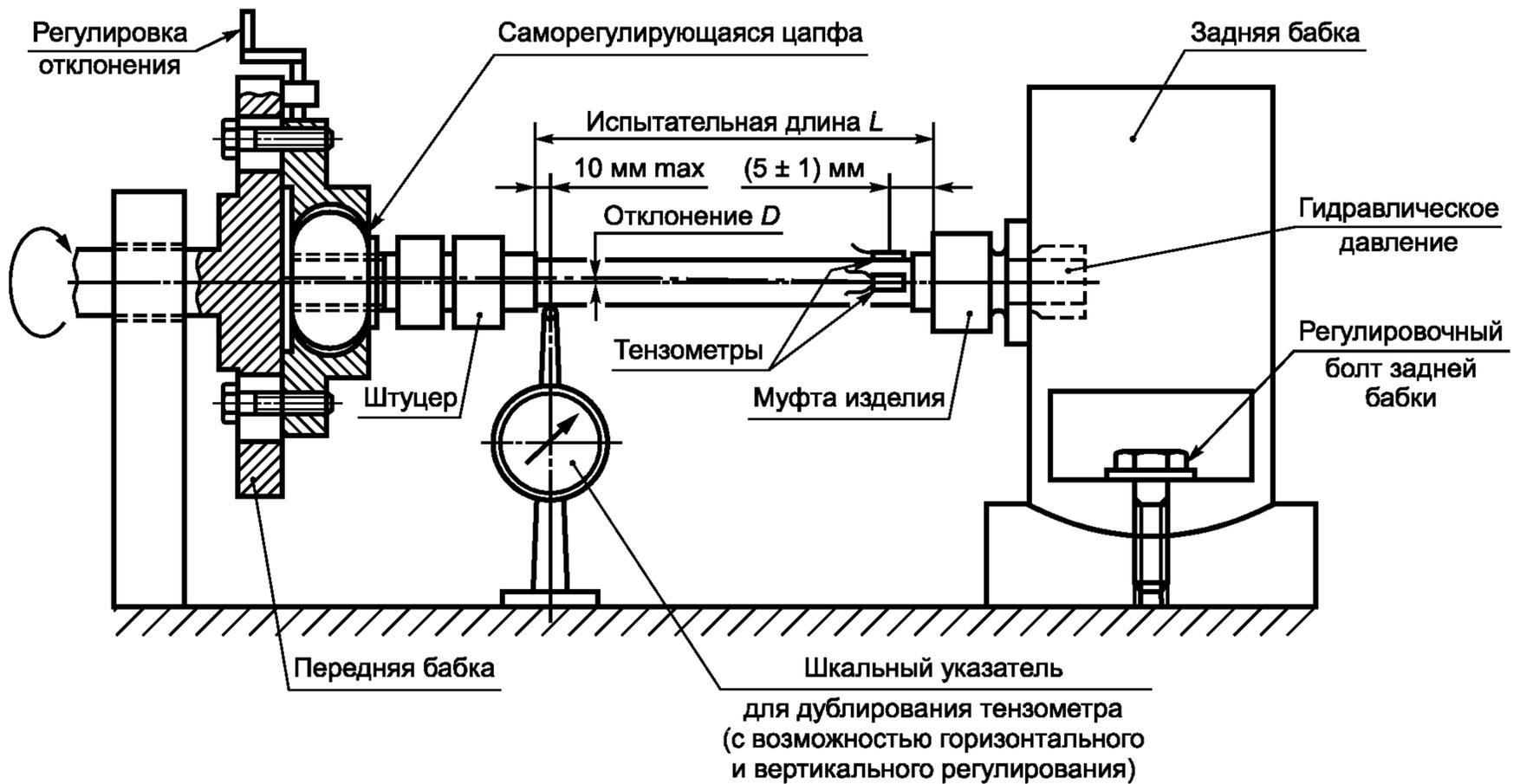
Рисунок 1 — Схема стандартного стенда для испытаний на изгиб
