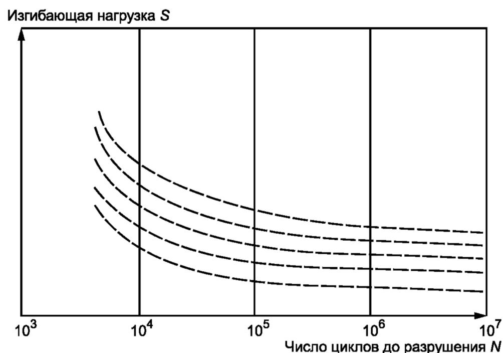
**П р и м е ч а н и е** — Подобные кривые допускается проводить для демонстрации различий, которые могут наблюдаться при сравнительных испытаниях соединений, отличающихся по типу конструкции и материалам изготовления.
