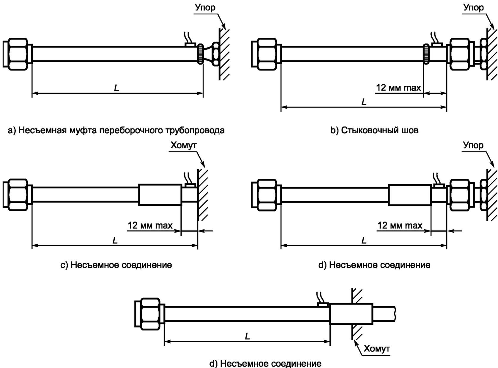
Рисунок 3 — Способы установки образцов с несъемной муфтой
