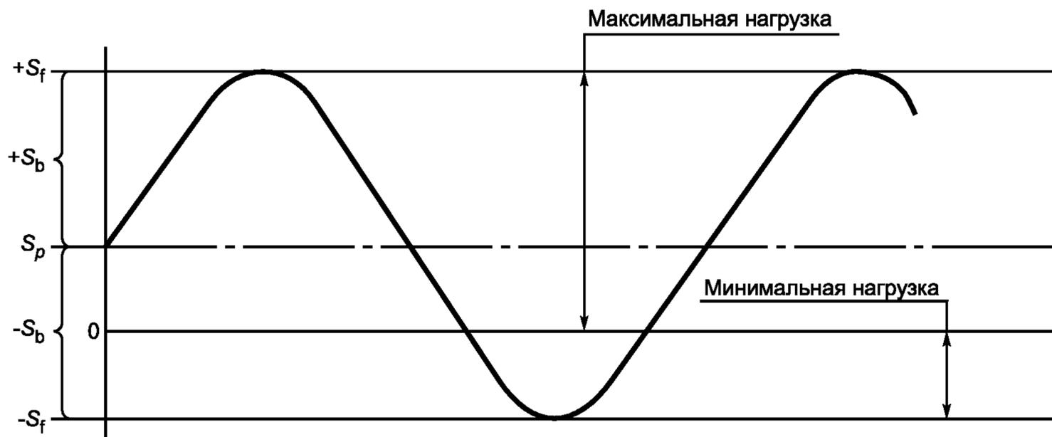
$S_p$  — средняя осевая нагрузка, создаваемая внутренним давлением;  $S_b$  — нагрузка, создаваемая сгибанием;  $S_f$  — суммарная нагрузка  $S_p + S_b$
