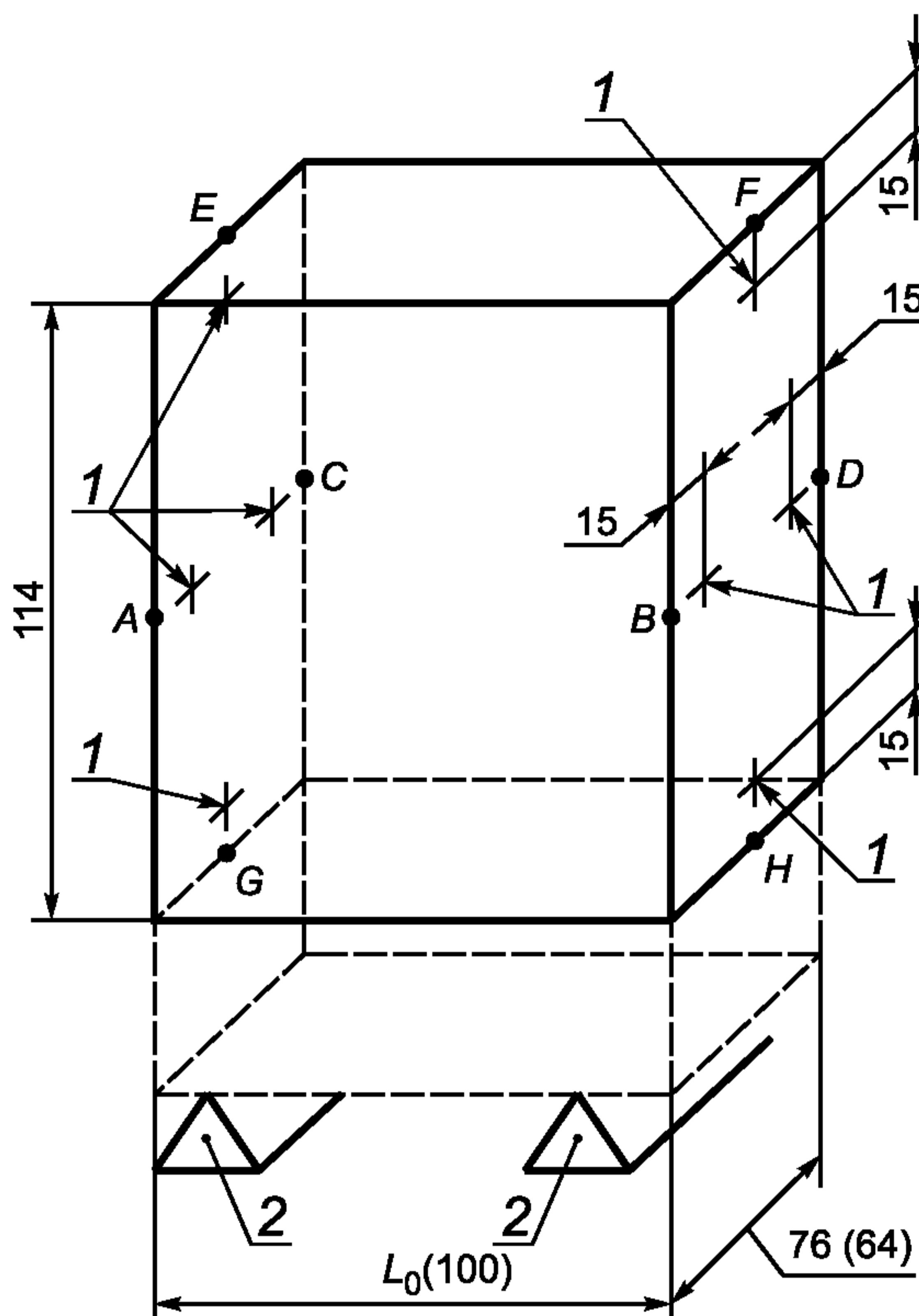
1 — места измерений, расположенные на расстоянии около 15 мм от грани образца; 2 — опоры образца (7.3)
