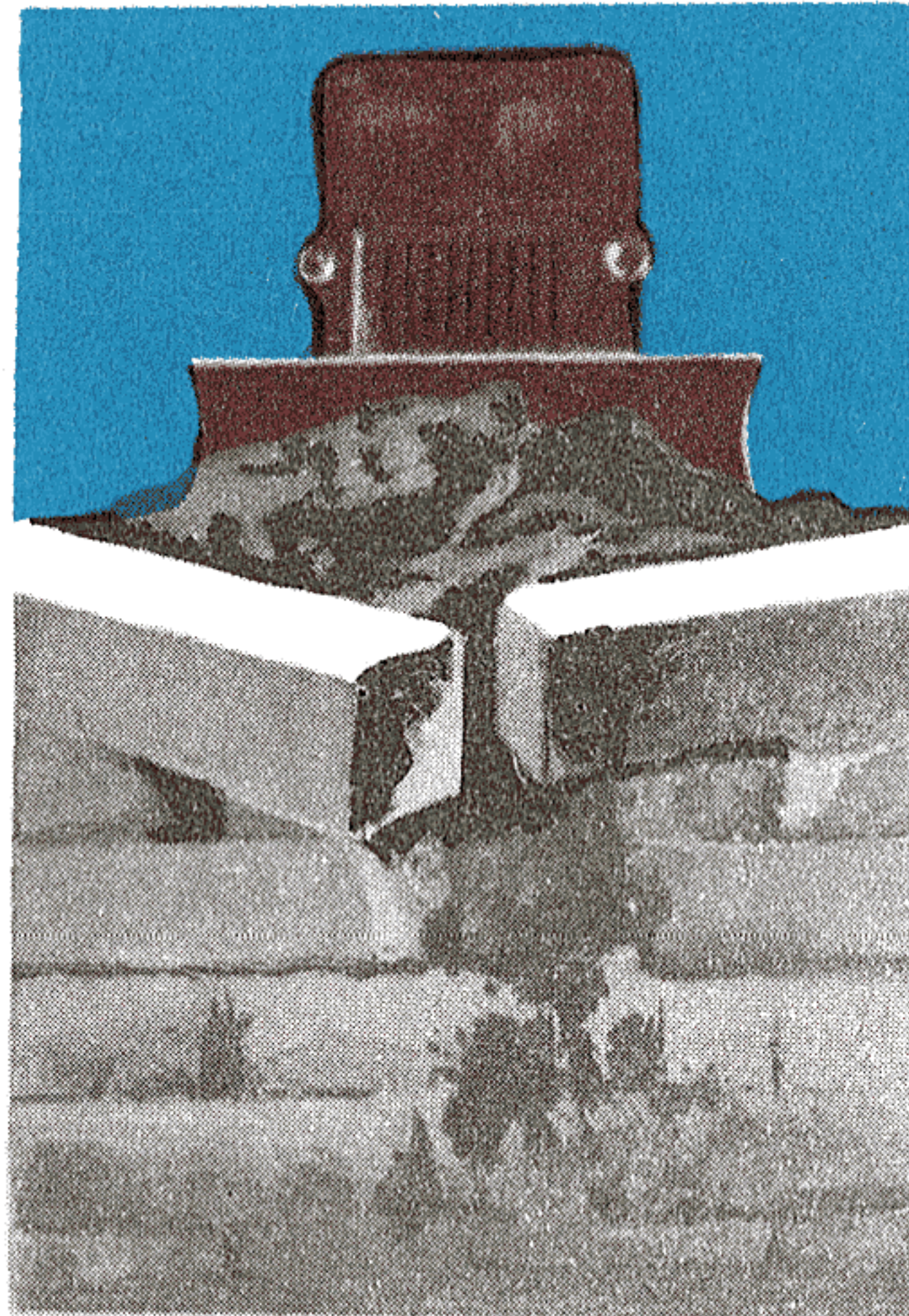
Засыпай после перекрытия подвала
