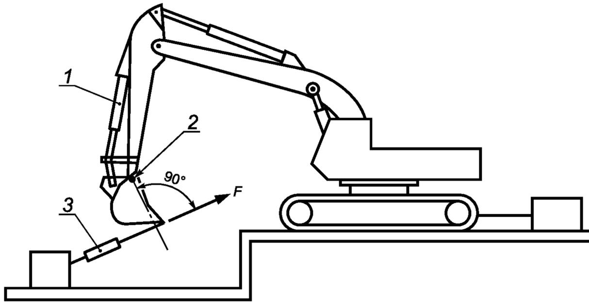
а) Гидравлический экскаватор с ковшом «обратная лопата»
