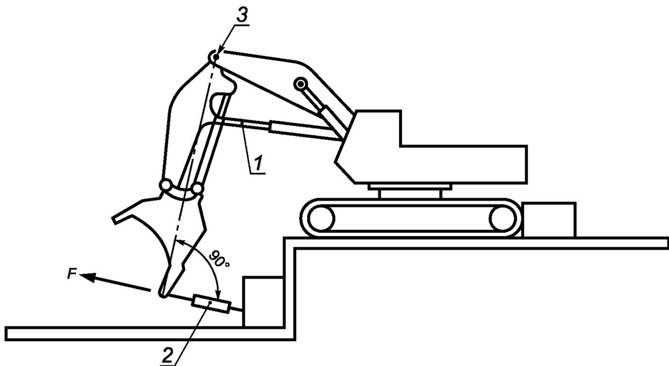
б) Гидравлический экскаватор с ковшом «прямая лопата»
