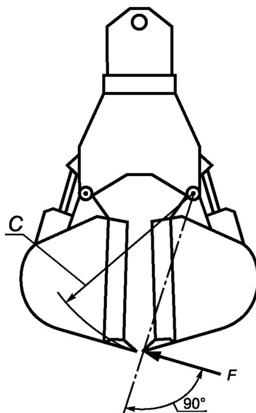
$C$  — радиус усилия на захвате (грейфере),  $F$  — усилие замыкания
