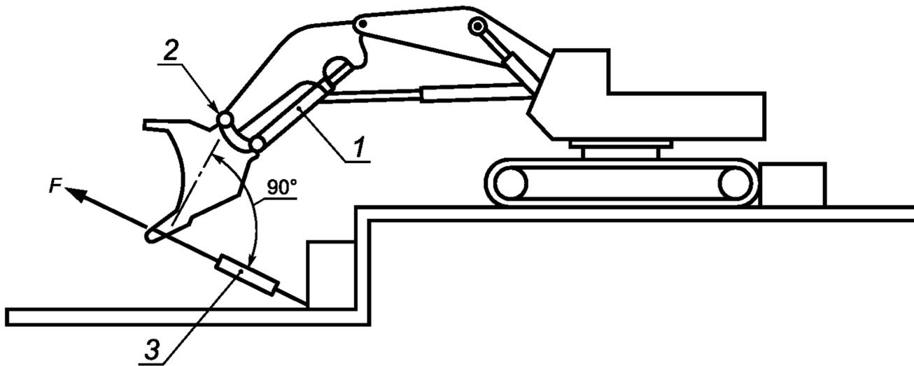
б) Гидравлический экскаватор с ковшом «прямая лопата»
