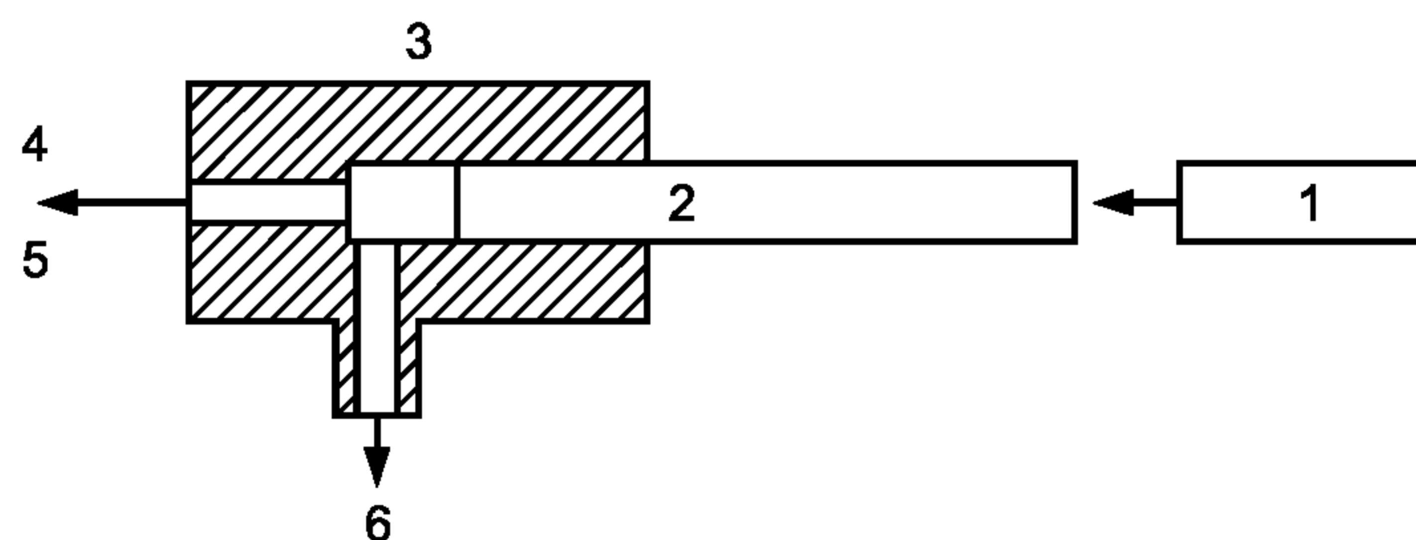
1 — атмосфера испытаний по ГОСТ Р 50021; 2 — сменный калибр; 3 — соединительный патрубок; 4 — объемный поток воздуха; 5 — источник всасывания ( $17,5\pm0,3\text{ см}^3/\text{s}$ ); 6 — место присоединения преобразователя давления
