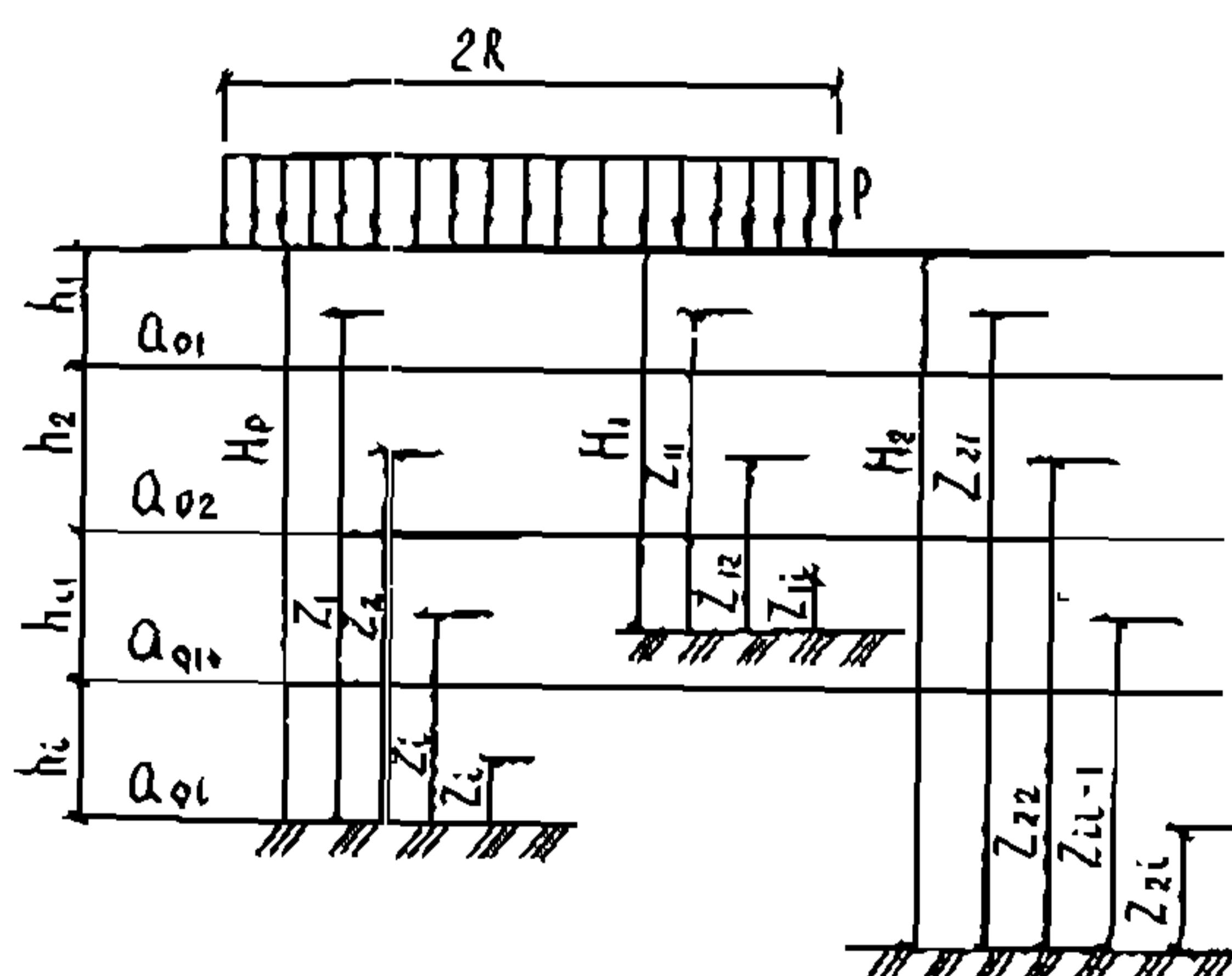
Рис. I. Схема вычисления  $a_{om}$  и  $H_p$
