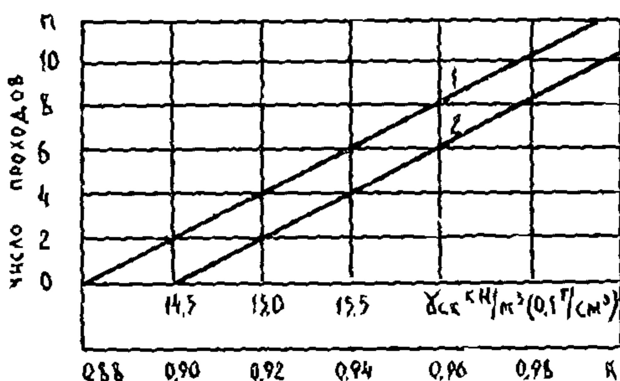
Рис. 5. Зависимость числа проходов катка от типа грунта при постоянной влажности, близкой к оптимальной:
