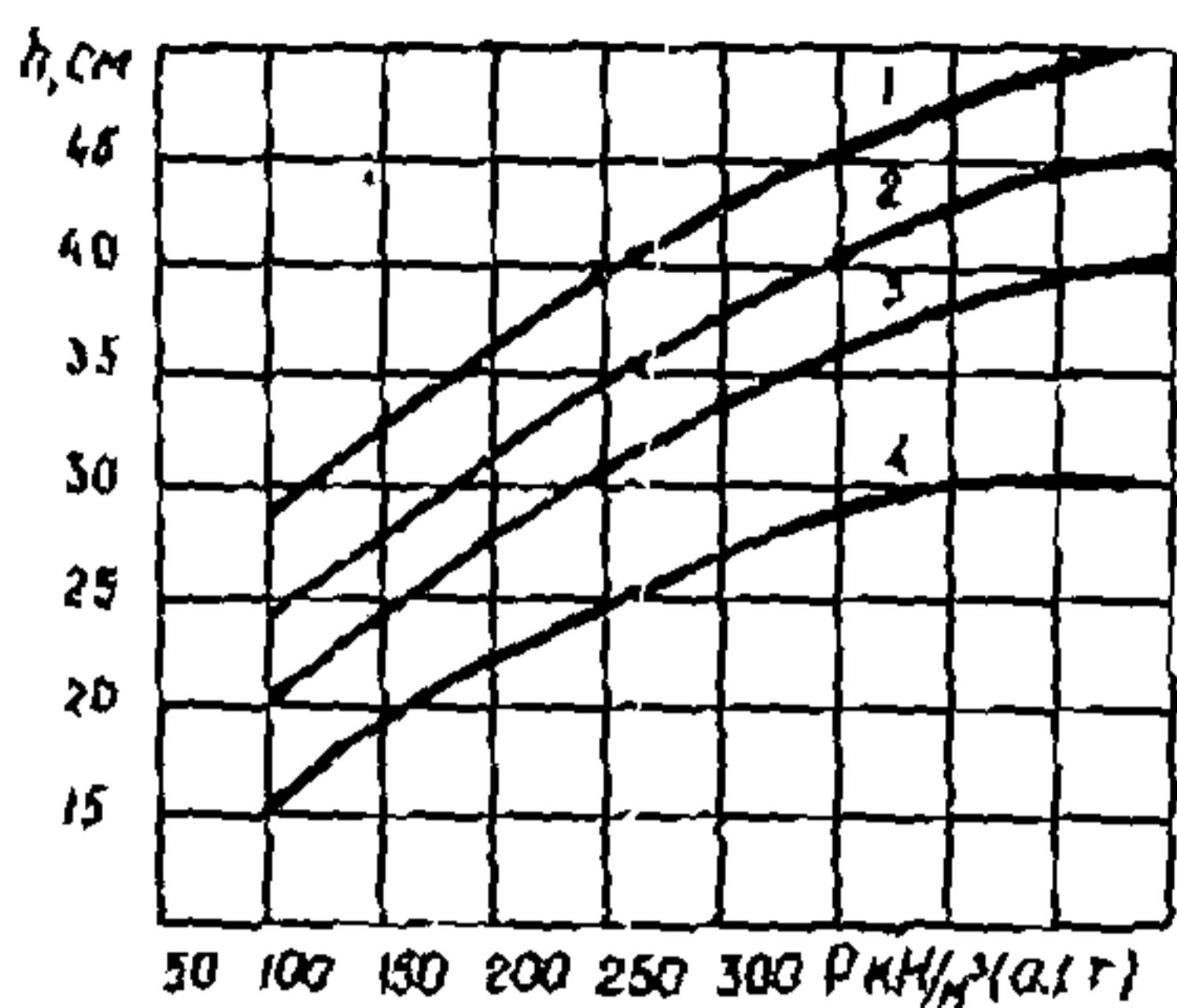
Рис. 6. Зависимость толщины слоя в плотном теле от веса катка: I -  $\gamma_{ck} = 16,0 \text{ кн}/\text{м}^3 (1,60 \text{ тс}/\text{м}^3)$  для несвязных грунтов; 2 -  $\gamma_{ck} = 16,5 \text{ кн}/\text{м}^3 (1,65 \text{ тс}/\text{м}^3)$  для несвязных грунтов; 3 -  $\gamma_{ck} = 16,0 \text{ кн}/\text{м}^3 (1,60 \text{ тс}/\text{м}^3)$  для связных грунтов; 4 -  $\gamma_{ck} = 16,5 \text{ кн}/\text{м}^3 (1,65 \text{ тс}/\text{м}^3)$  для связных грунтов
