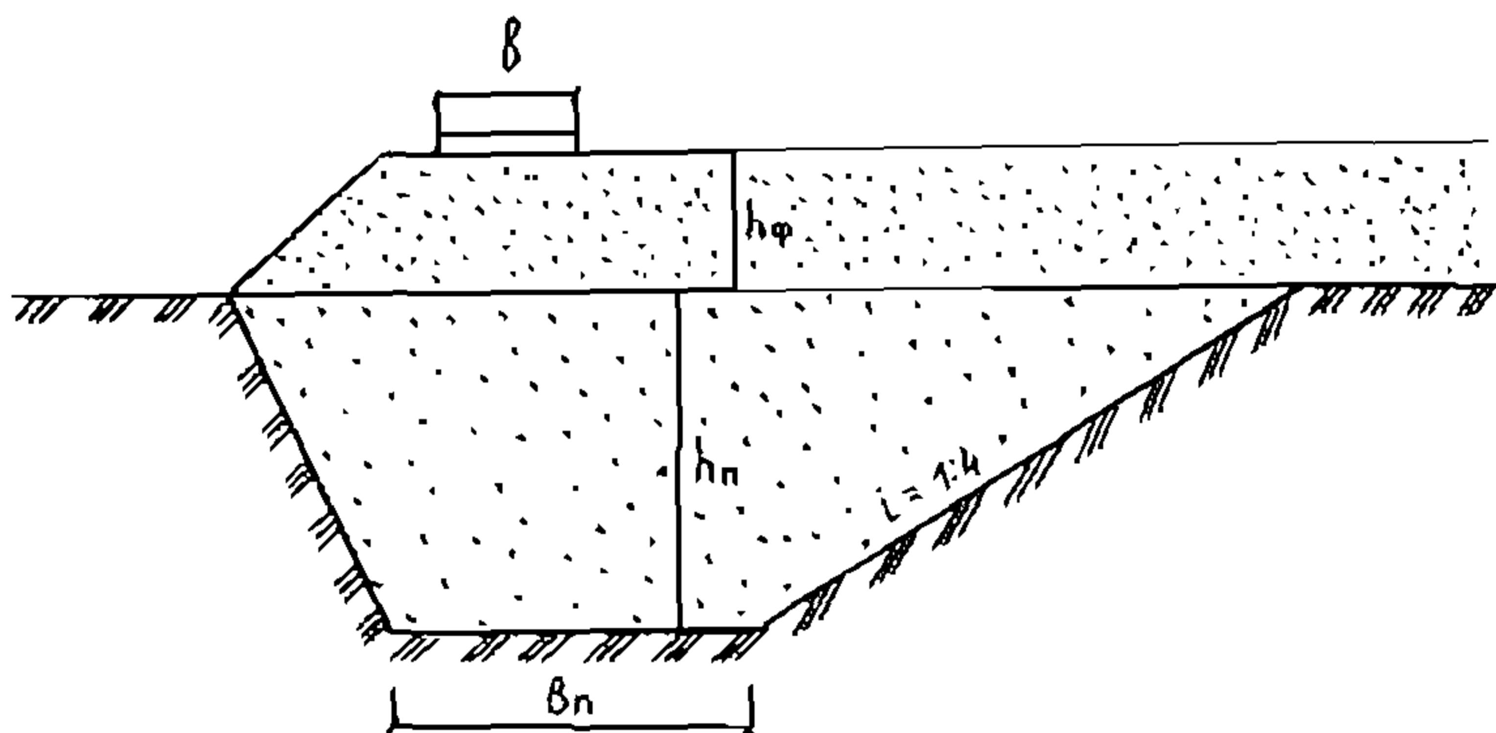
Рис. 2. Устройство кольцевой песчаной подушки под стenkой резервуара
