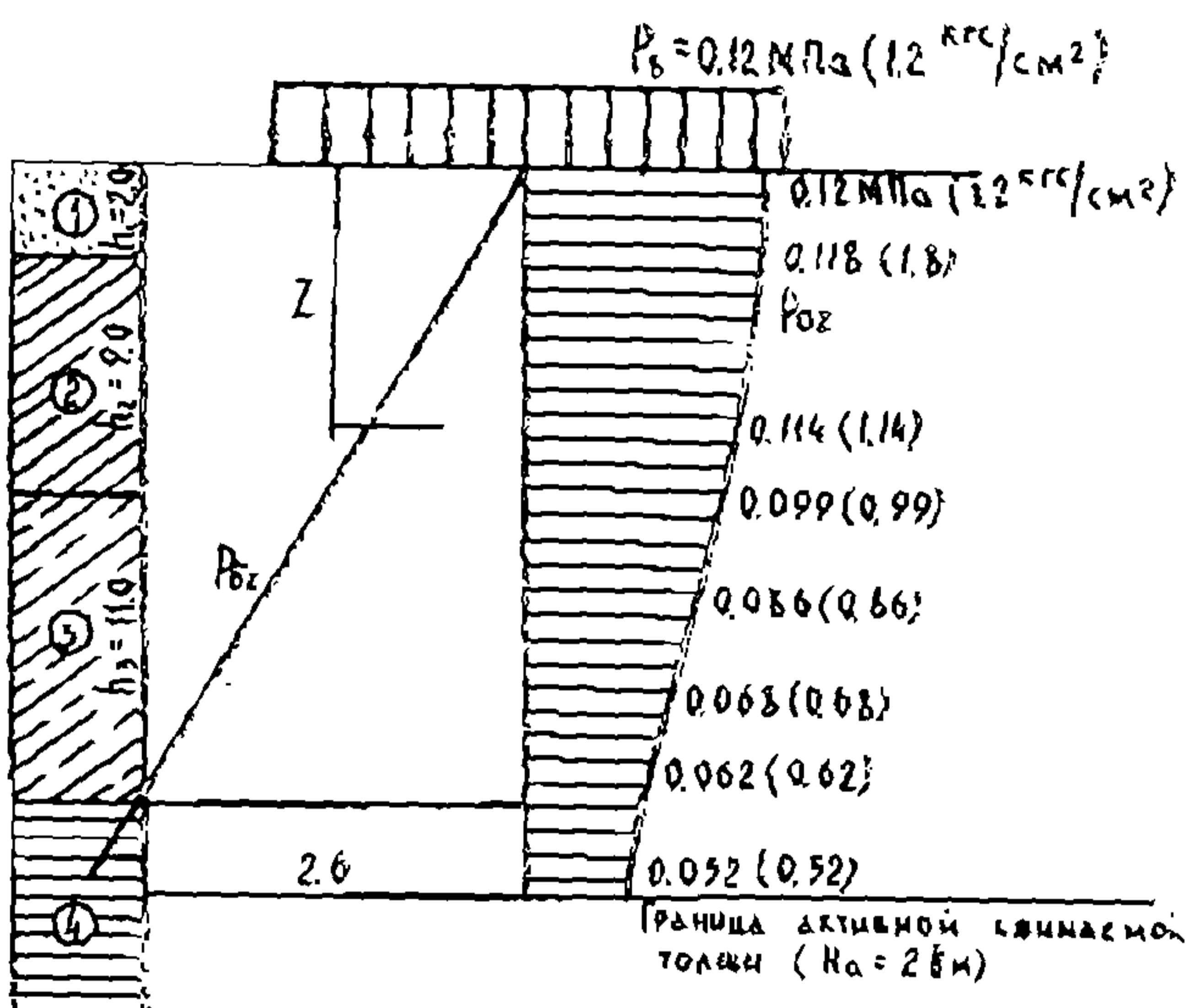
Рис. 2. Схема расчета конечной осадки центра основания резервуара: 1 - песок среднезернистый; 2 - суглиноок пылеватый; 3 - супесь пылеватая, тугопластичная; 4 - суглиноок пылеватый, слоистый и неслоистый
