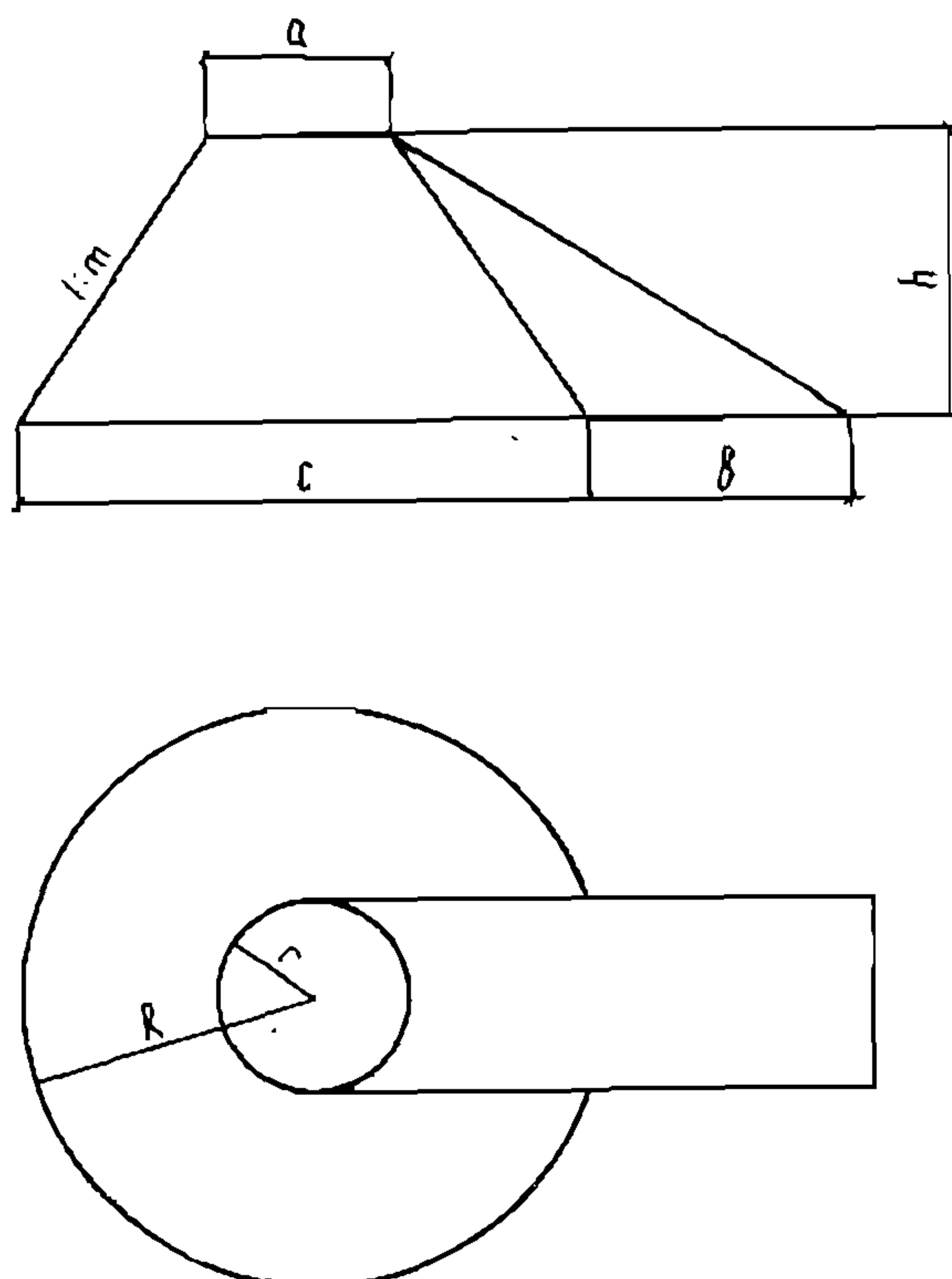
Рис. 3. Размеры временной насыпи
