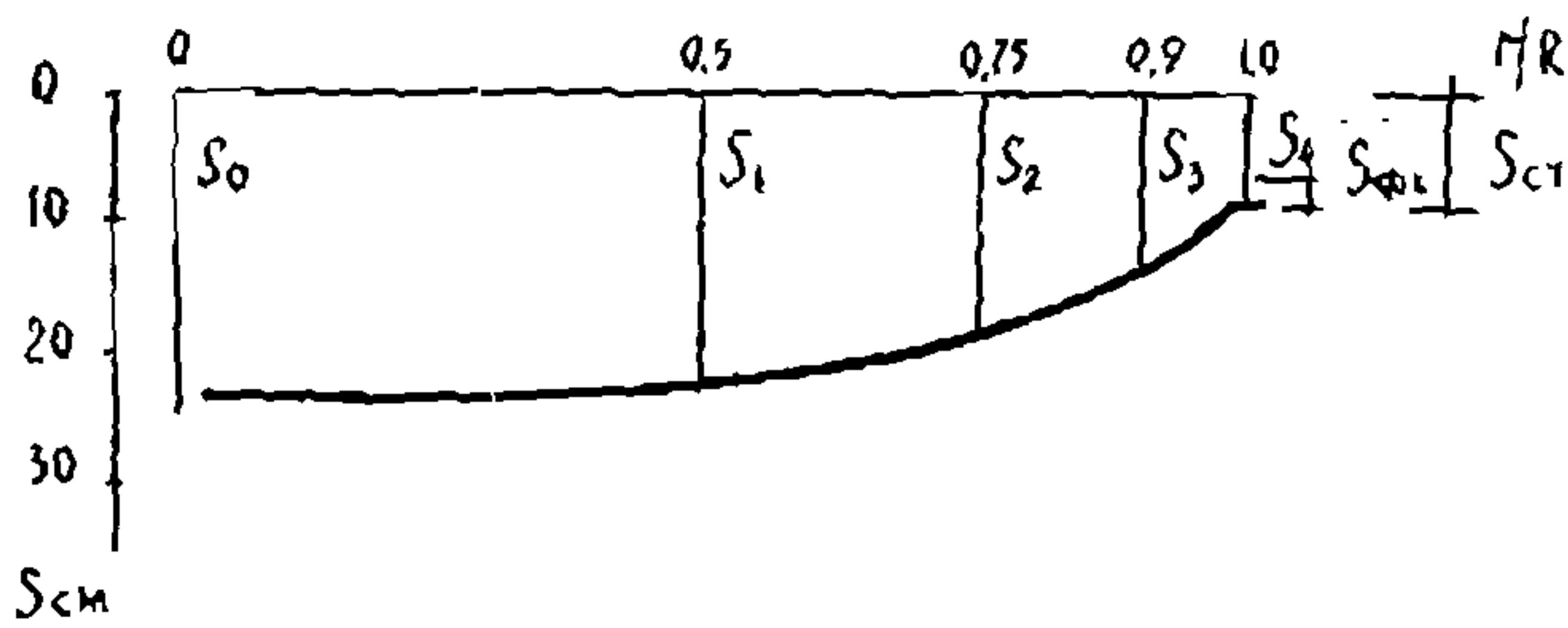
Рис. 4. Профиль осадки основания резервуара
