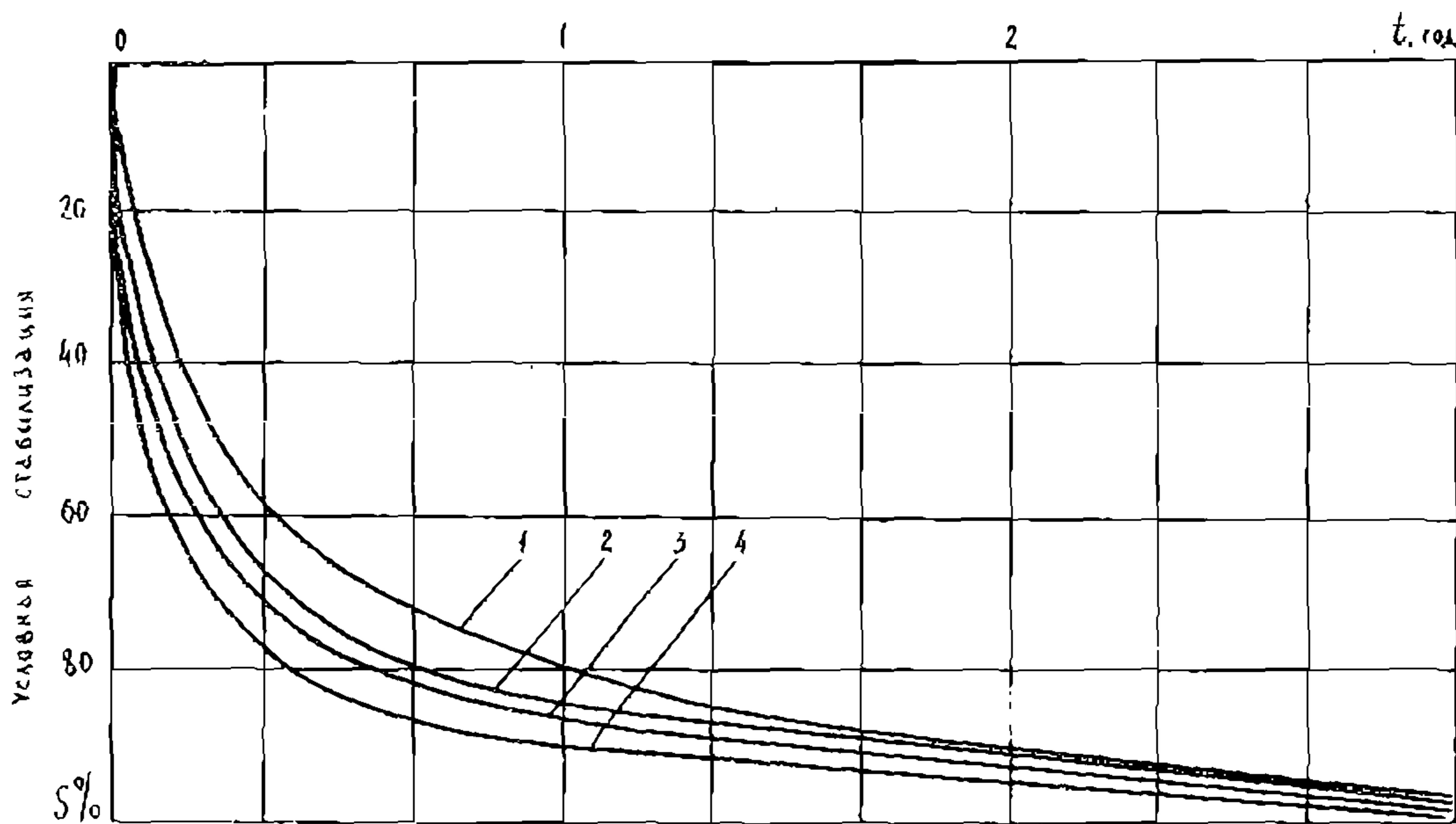
Рис. 4. Обобщенный график осадок основания в % от времени: 1 -  $P = 0,10 \text{ МПа}$
