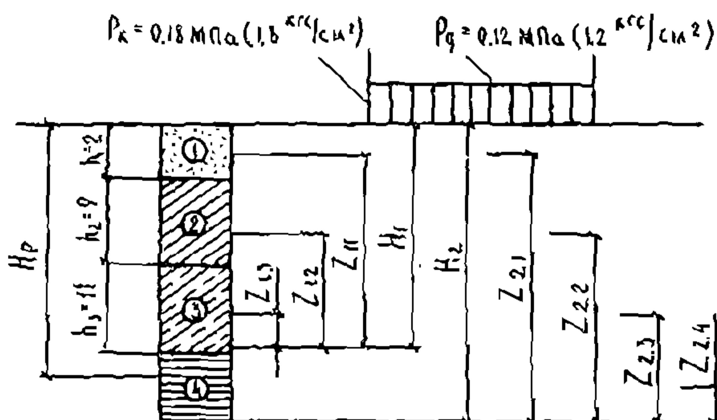
Рис. 5. Схема определения расчетной сжимаемой толщи  $H_p$
