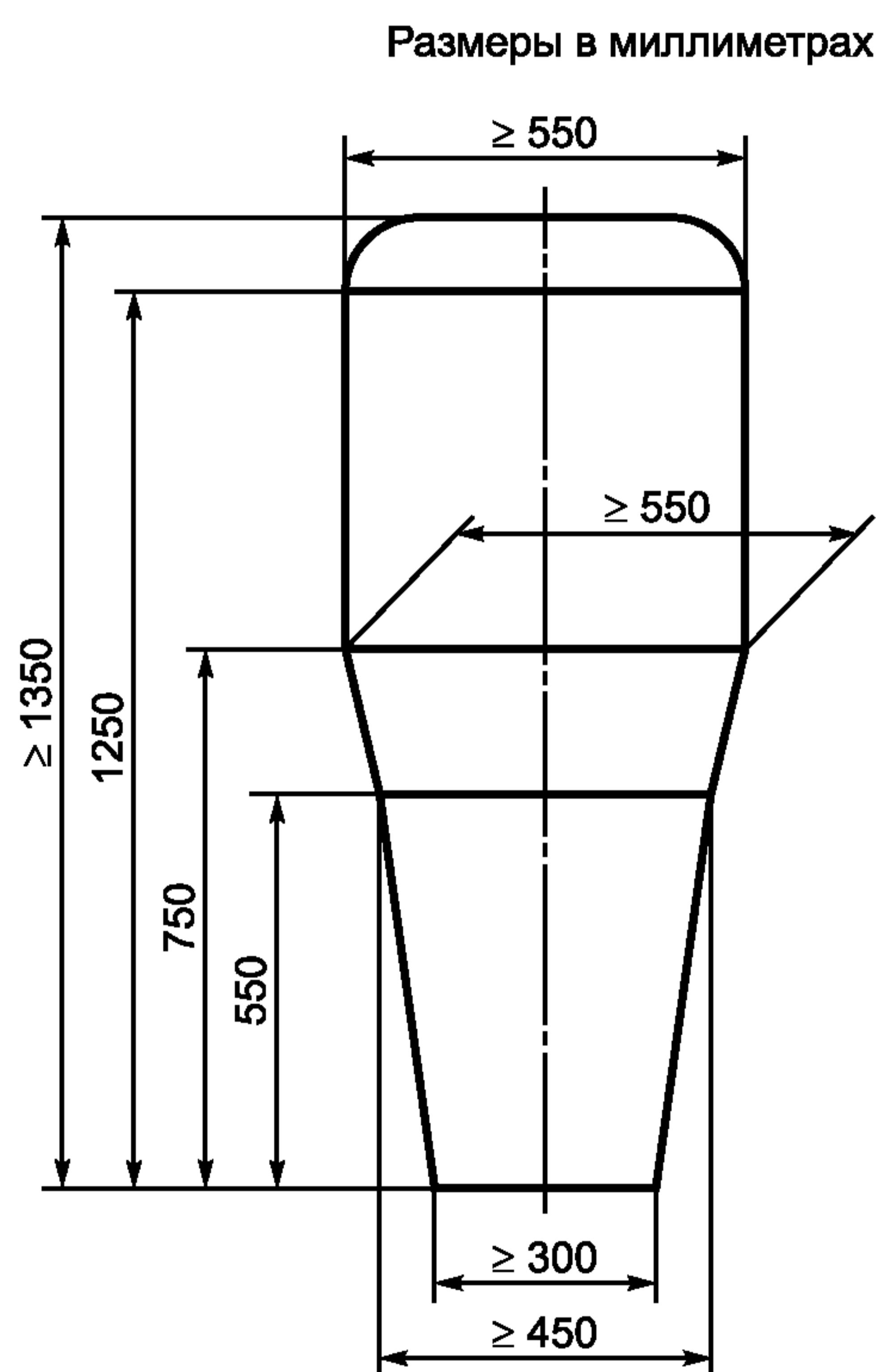
Рисунок 6 — Основные размеры дверных проемов
