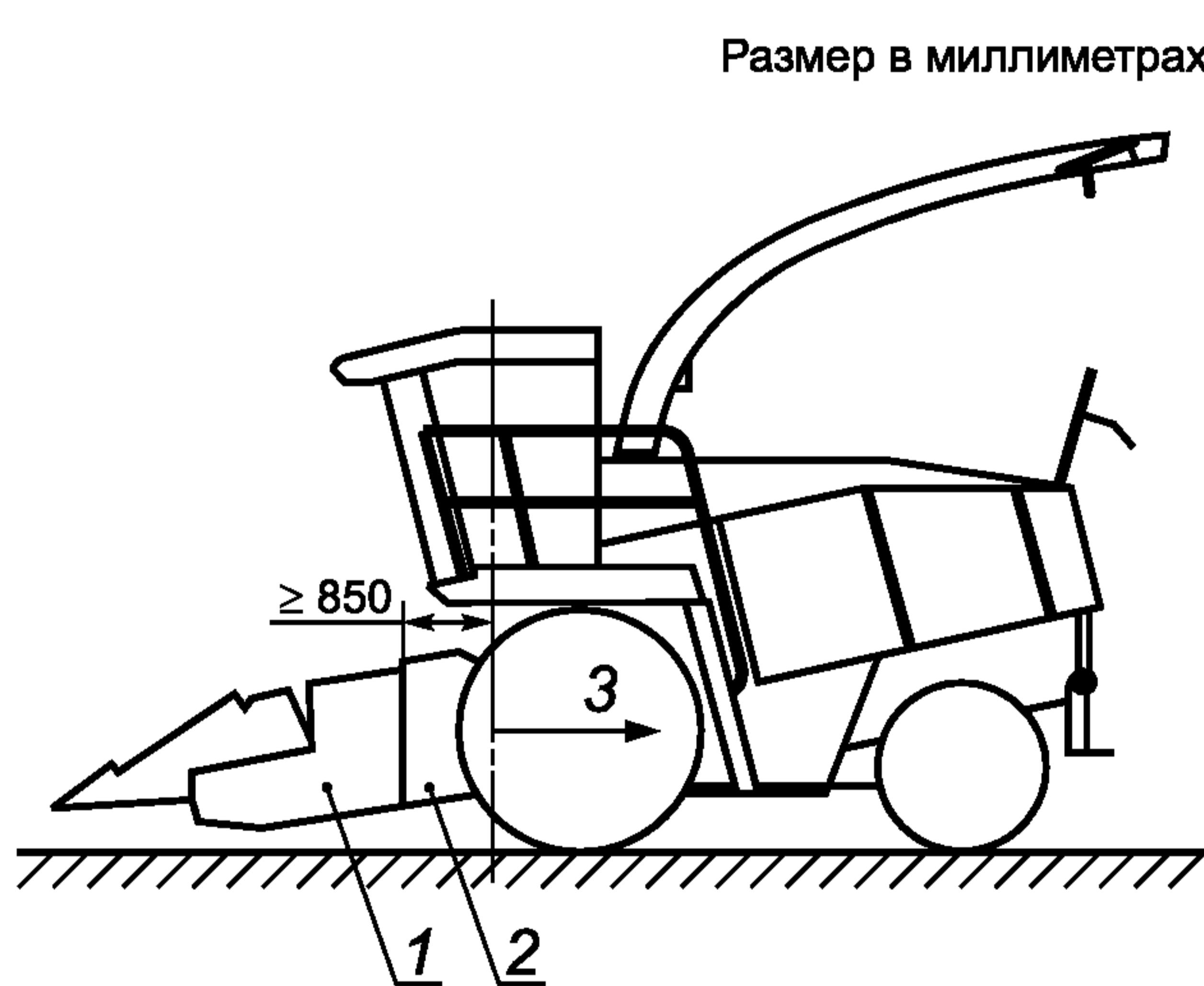
1 — жатка; 2 — кожух подающего аппарата; 3 — зона дополнительного контроля (за пунктирной линией)
