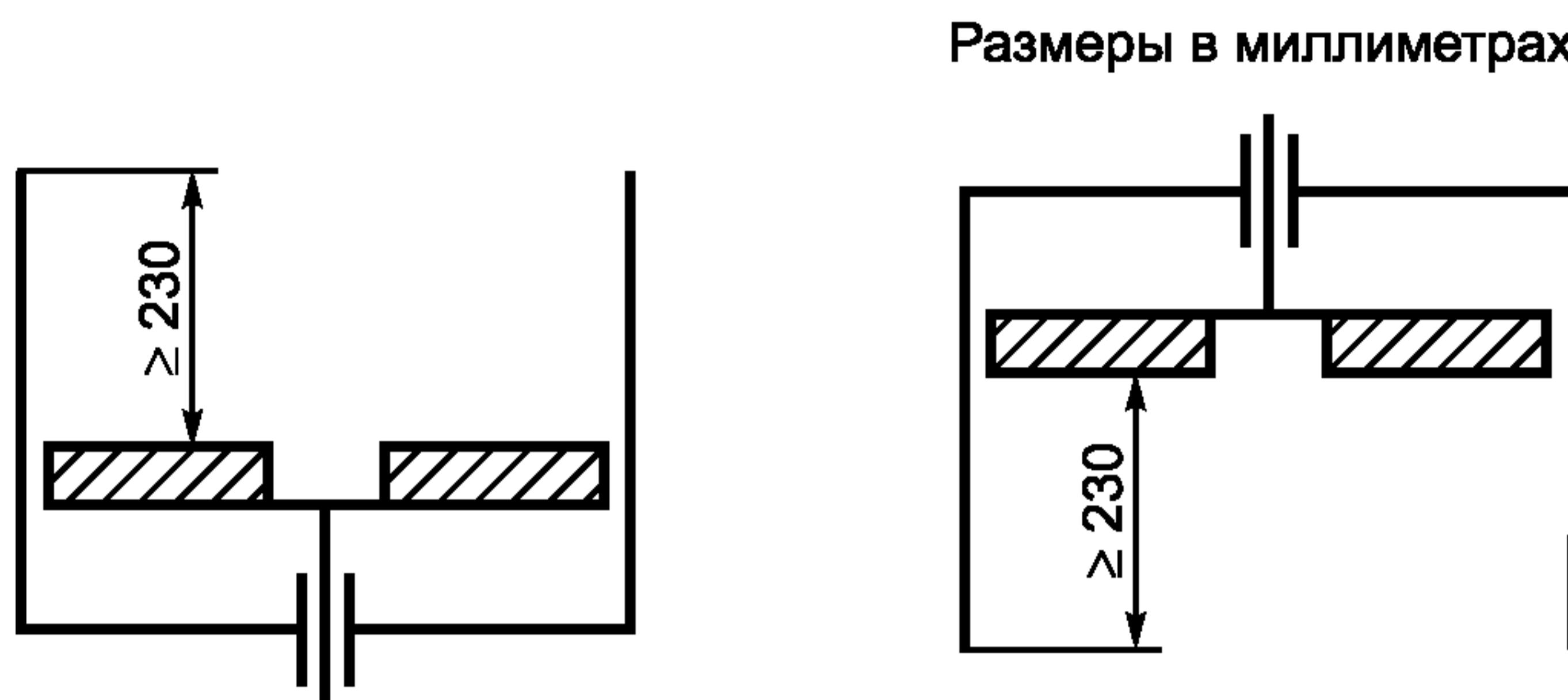
Рисунок 13 — Защитное ограждение привода распределителя
