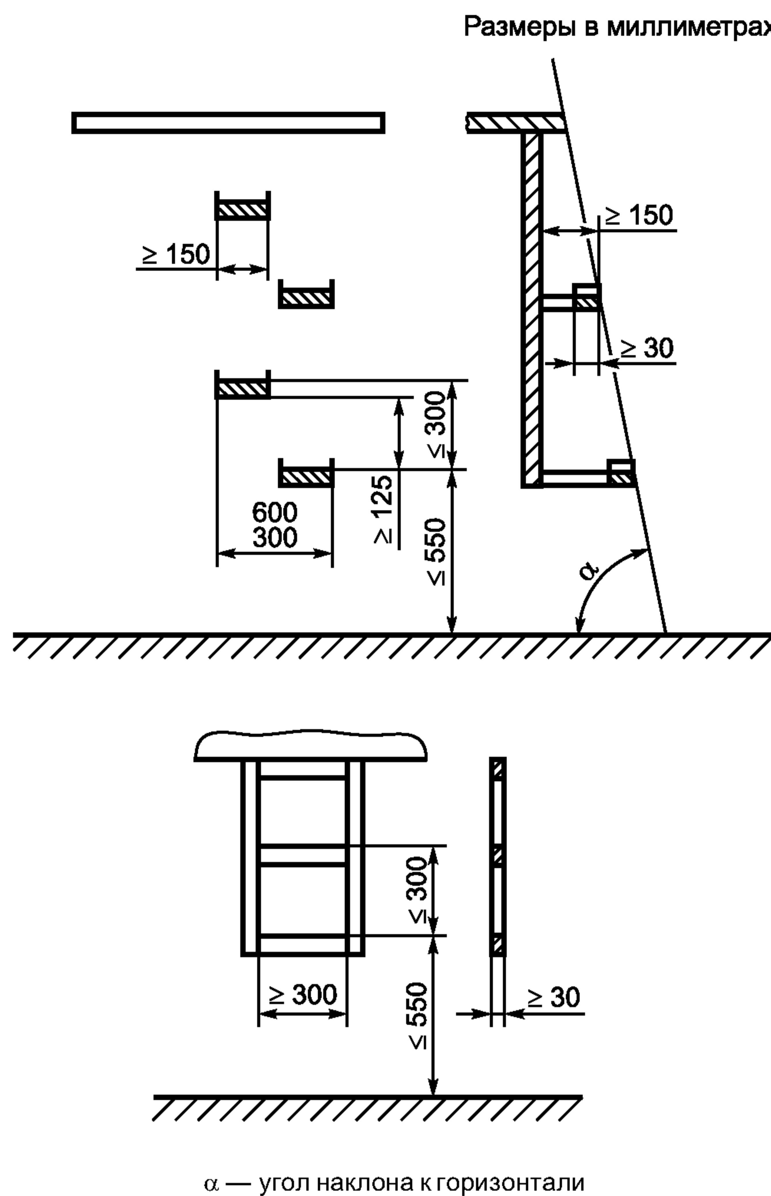
Рисунок 8 — Средства доступа к другим рабочим местам (например, для проведения технического обслуживания)
