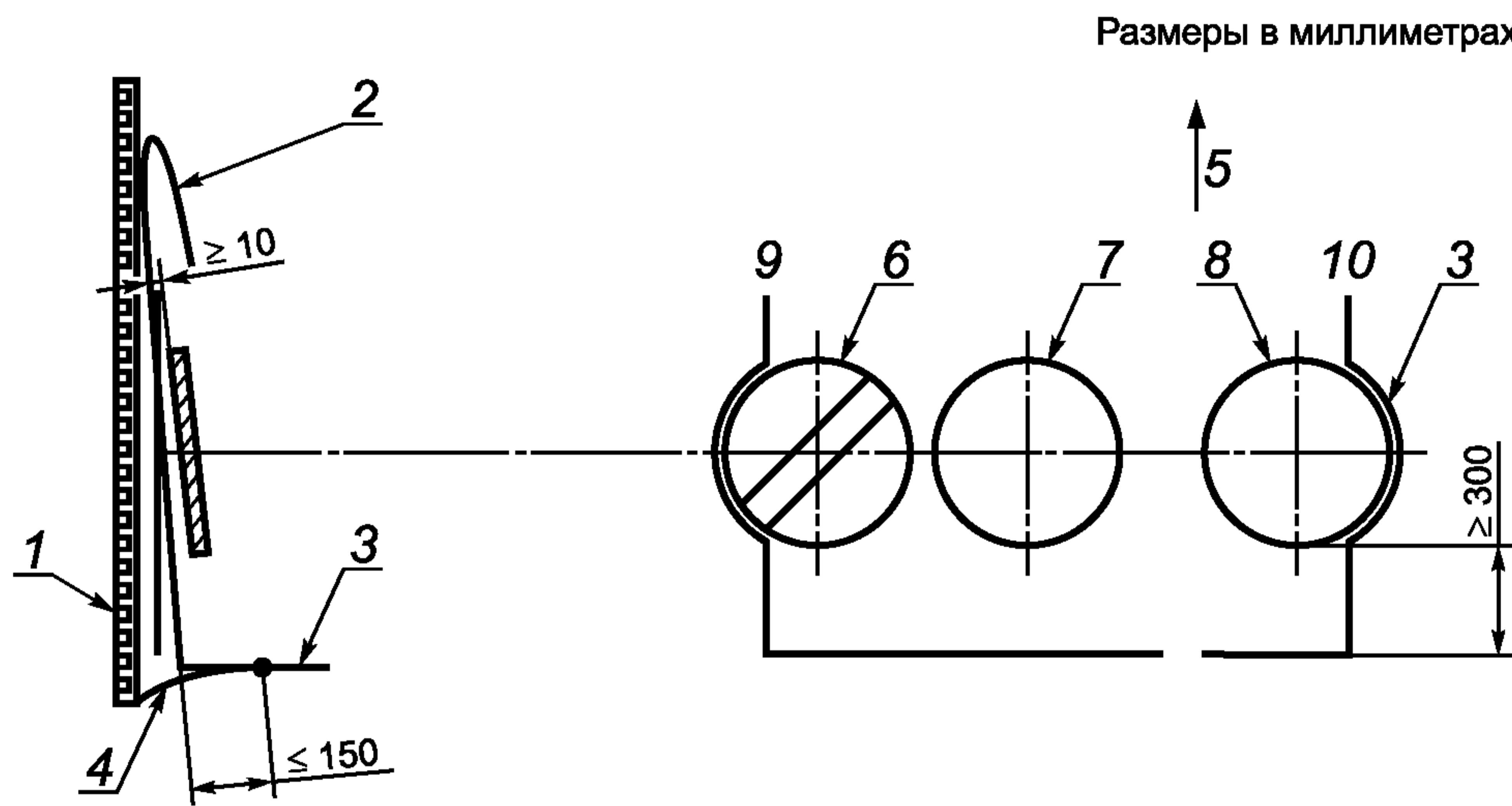
1 — поле; 2 — рабочие органы; 3 — защитное ограждение; 4 — полоса прорезиненного брезента; 5 — направление движения;
