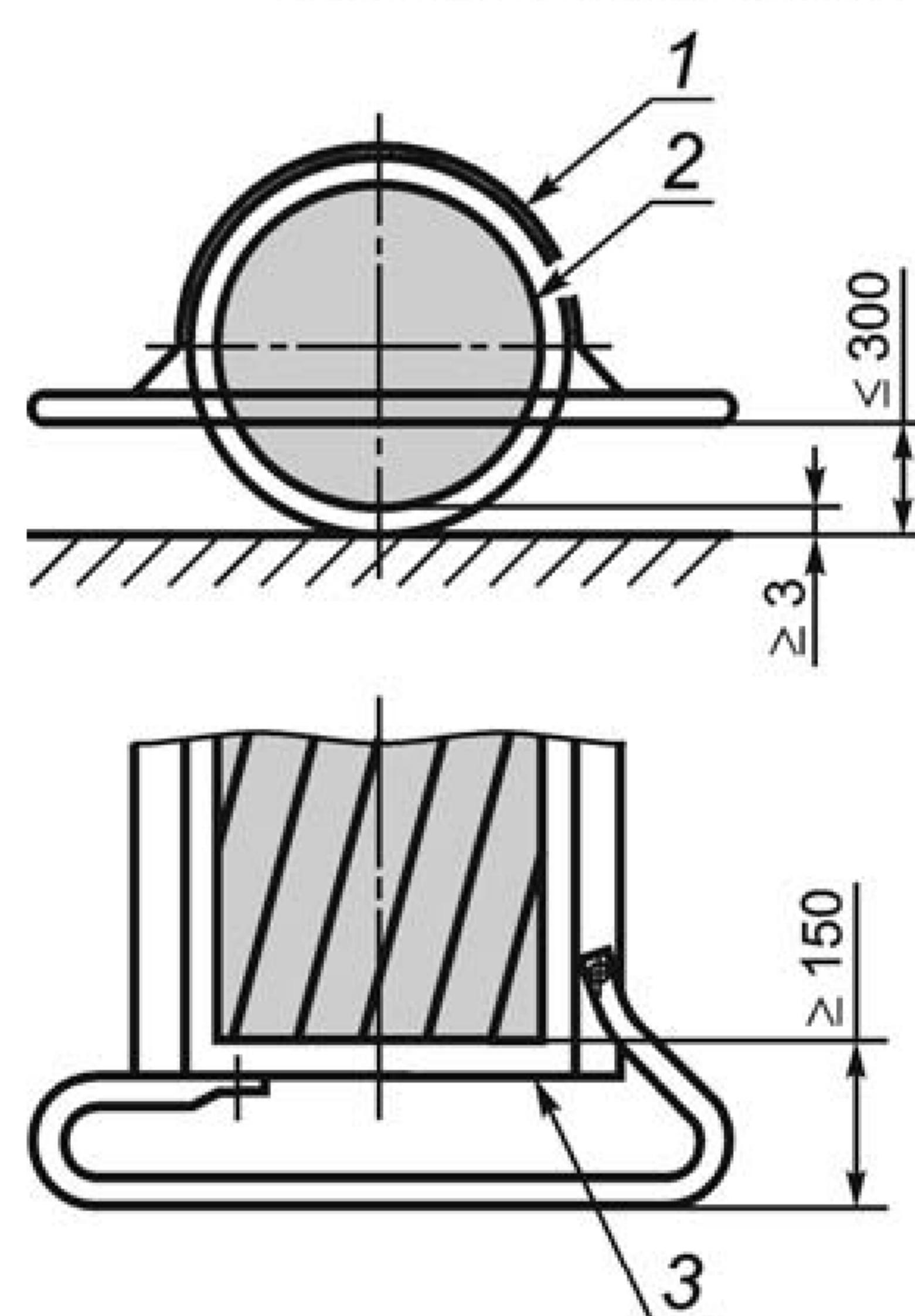
1 — защитное ограждение; 2 — плоскость вращения рабочего органа; 3 — защитное ограждение (переднее)
