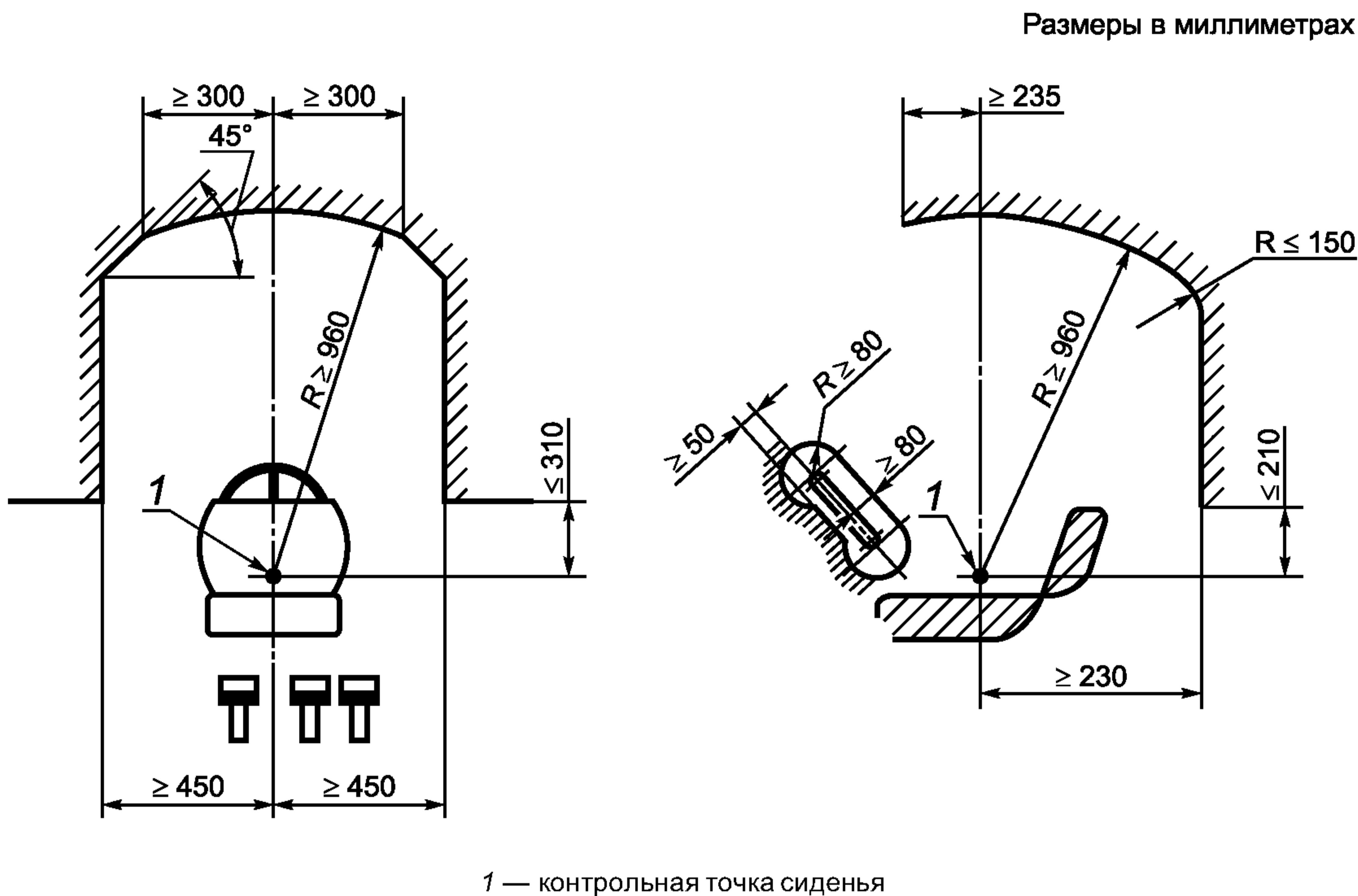
Рисунок 7 — Размеры внутреннего пространства кабины
