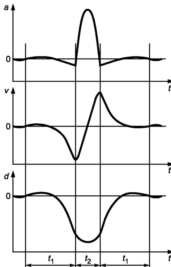
$a$  — ускорение ударного импульса;  $v$  — скорость;  $d$  — перемещение;  $t$  — время;  $t_1$  — длительность предупредного (послеударного) импульса;  $t_2$  — длительность импульса (основной части)
