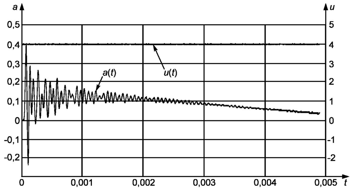
$a(t)$  — ускорение на столе вибростенда;  $u(t)$  — напряжение на входе усилителя мощности вибростенда;  $t$  — время, с
