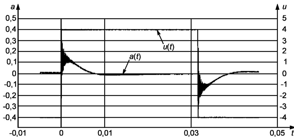
$a(t)$  — ускорение на столе вибростенда;  $u(t)$  — напряжение на входе усилителя мощности вибростенда;  $t$  — время, с
