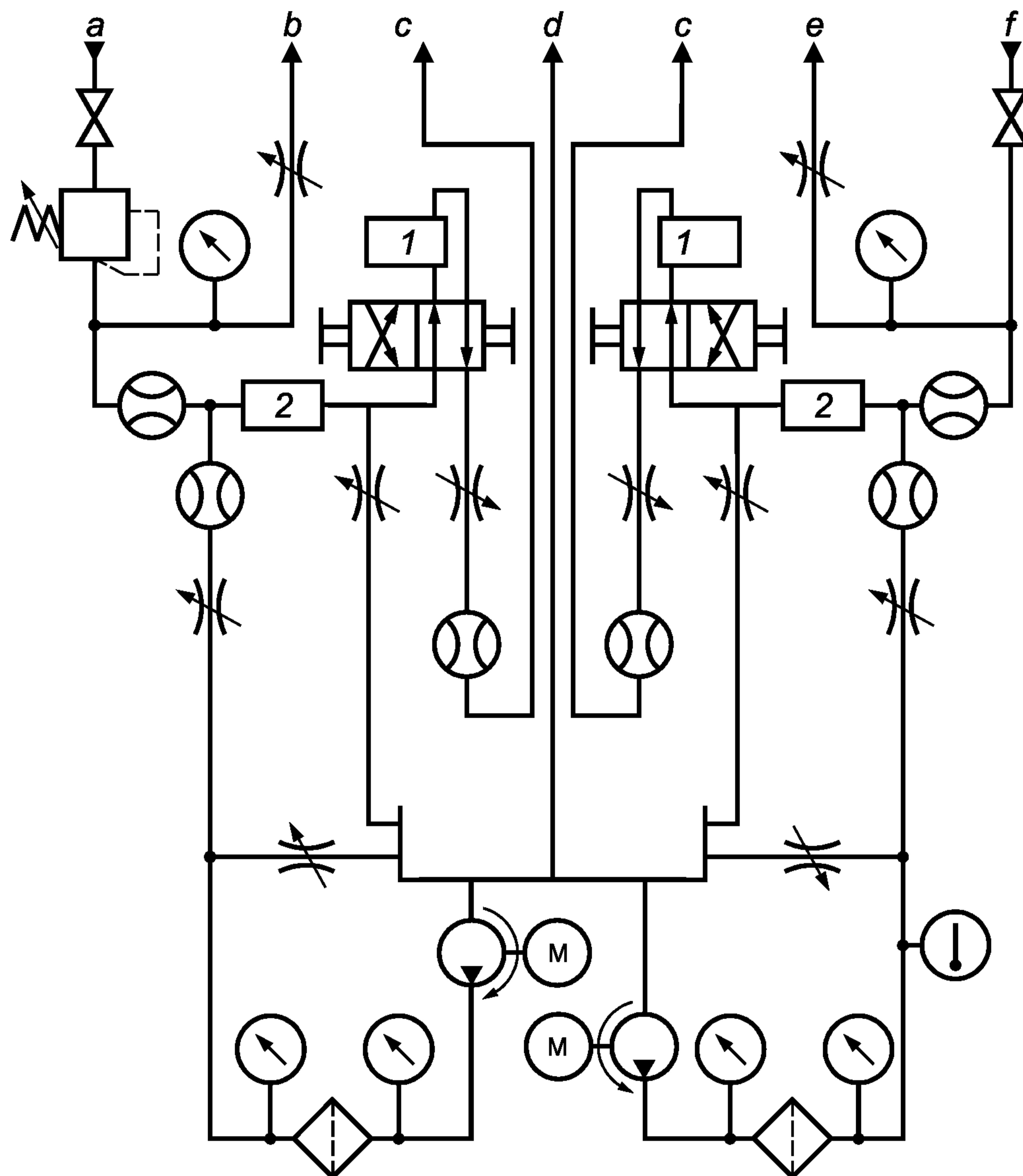
*a* — подача пробы выше по потоку; *b* — отвод пробы выше по потоку; *c* — отвод жидкости от датчиков АСЧ; *d* — слив; *e* — отвод пробы ниже по потоку; *f* — подача пробы ниже по потоку;
