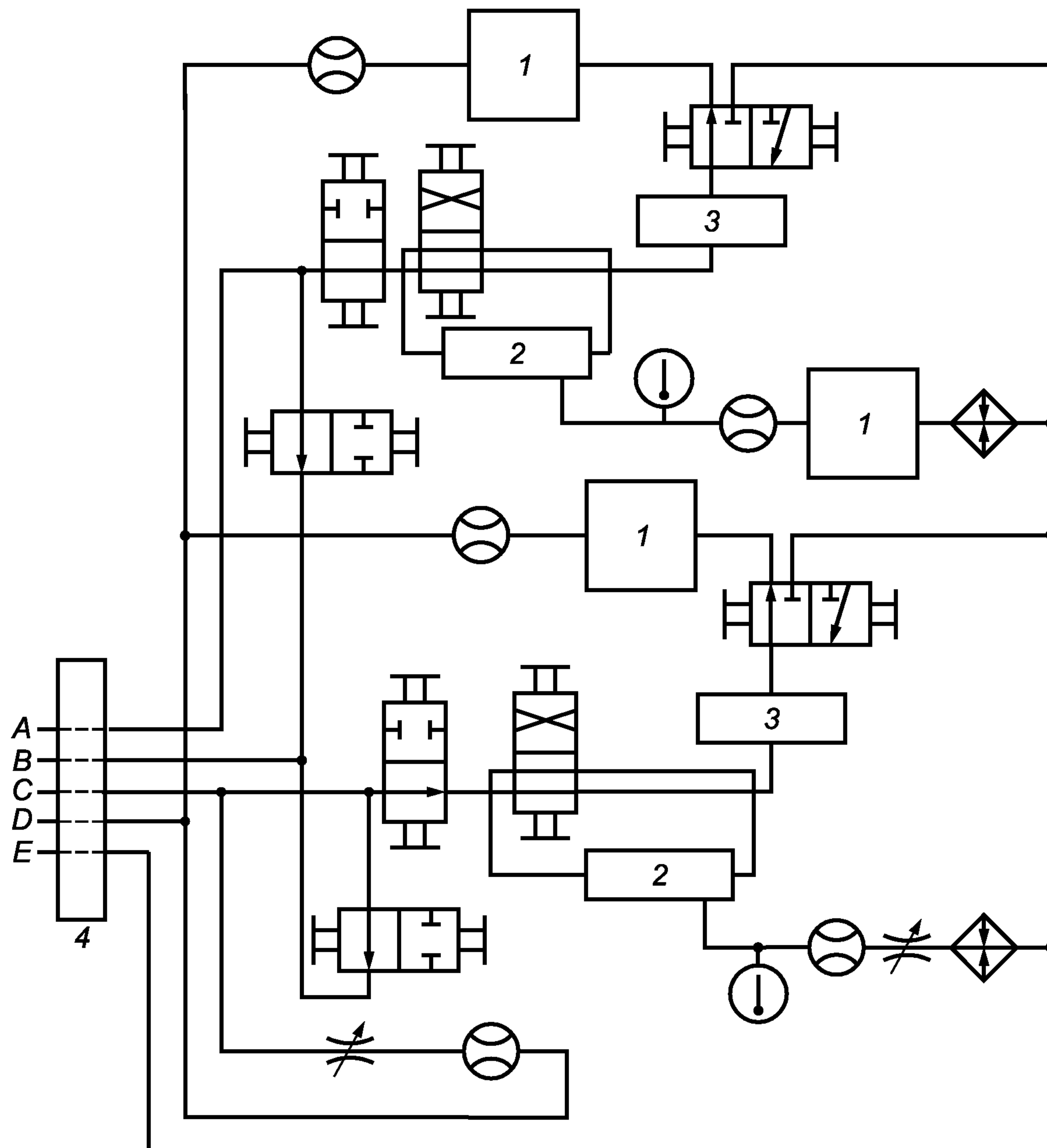
1 — регулятор расхода; 2 — смеситель; 3 — датчик АСЧ; 4 — подсоединение к испытательному стенду;
