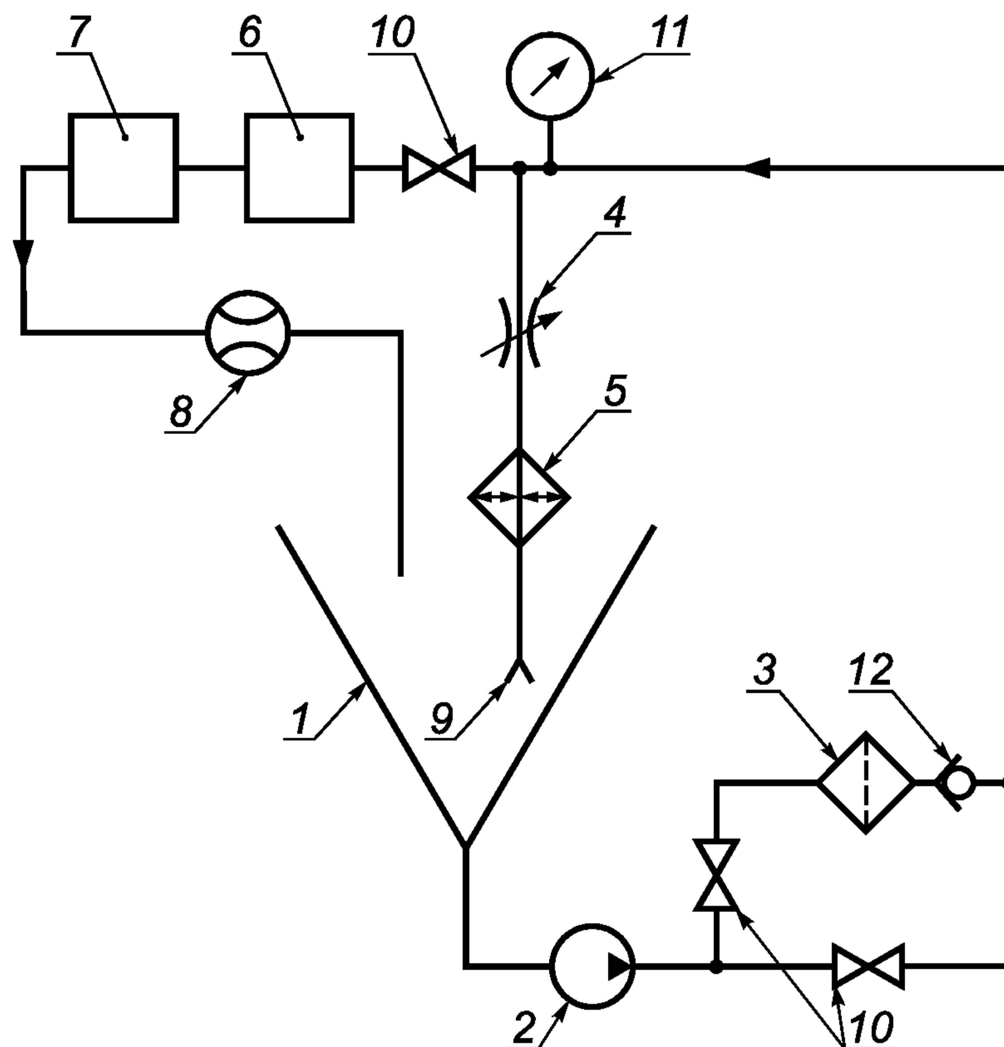
1 — конический гидробак (с углом конуса от 60° до 90°) с точно контролируемым объемом жидкости; 2 — центробежный насос; 3 — очистительный фильтр; 4 — клапан регулировки противодавления; 5 — теплообменник/нагреватель; 6 — датчик АСЧ; 7 — датчик АСЧ; 8 — расходомер; 9 — диффузор; 10 — шаровой кран (не используют для регулирования потока); 11 — манометр; 12 — обратный клапан
