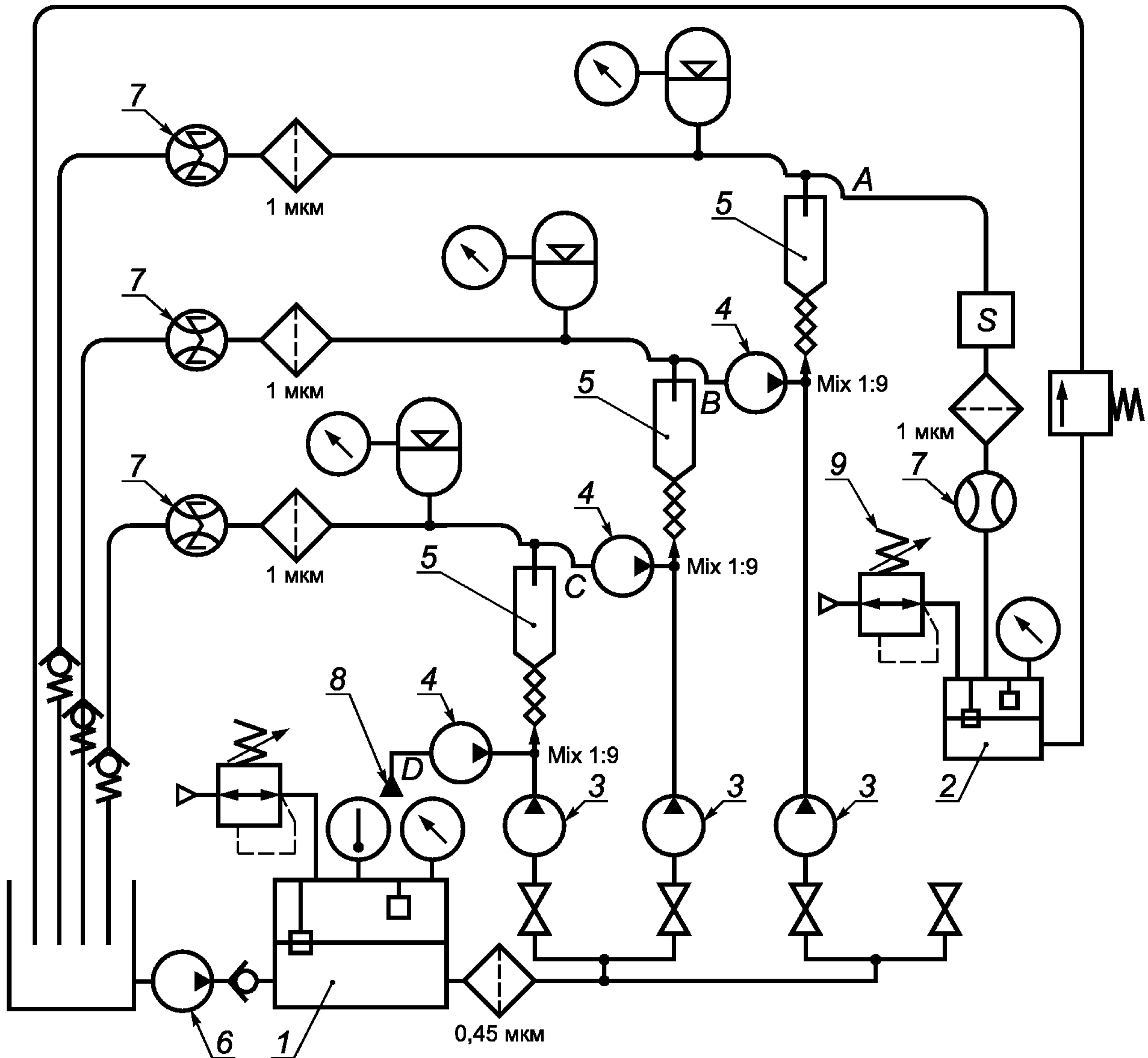
1, 2 — камеры с автоматической настройкой уровня жидкости (герметичные); 3 — сдвоенные перистальтические насосы для разбавления пробы; 4 — сдвоенные перистальтические насосы для пробы; 5 — статические смесители и камера расширения; 6 — перекачивающий насос (включающийся автоматически); 7 — суммирующие микрорасходомеры с овальными шестернями; 8 — подача жидкости от многопроходного стенда; 9 — регулируемая подача воздуха;
