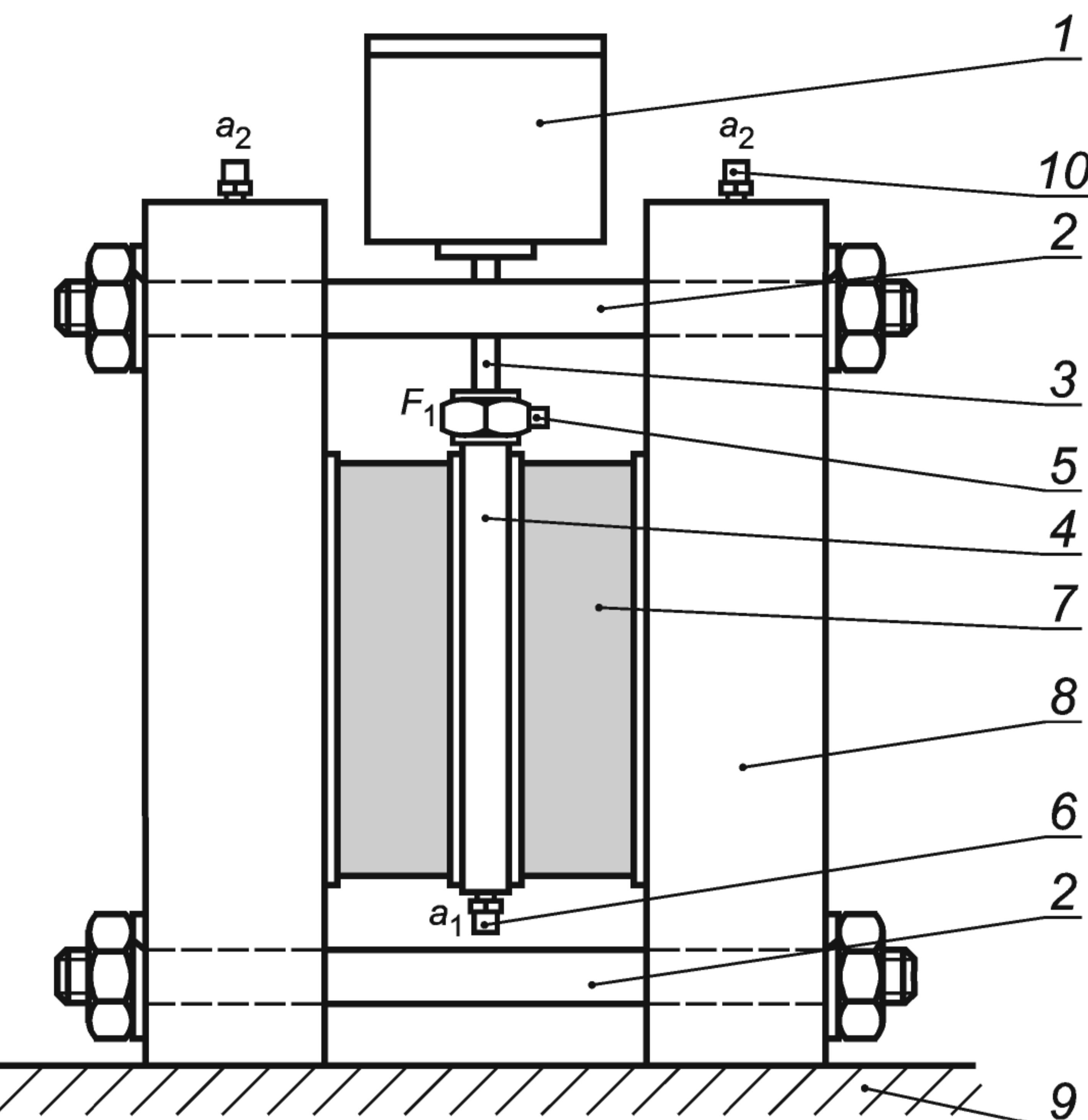
1 — вибровозбудитель; 2 — устройство предварительного статического нагружения; 3 — толкатель; 4 — плита распределения вынуждающей силы; 5 — датчик силы (измерение  $F_1$ ); 6 — акселерометр (измерение  $a_1$ ); 7 —名义ально идентичные упругие опоры; 8 — жесткие вертикальные стойки; 9 — жесткий фундамент; 10 — акселерометр (измерение  $a_2$ )
