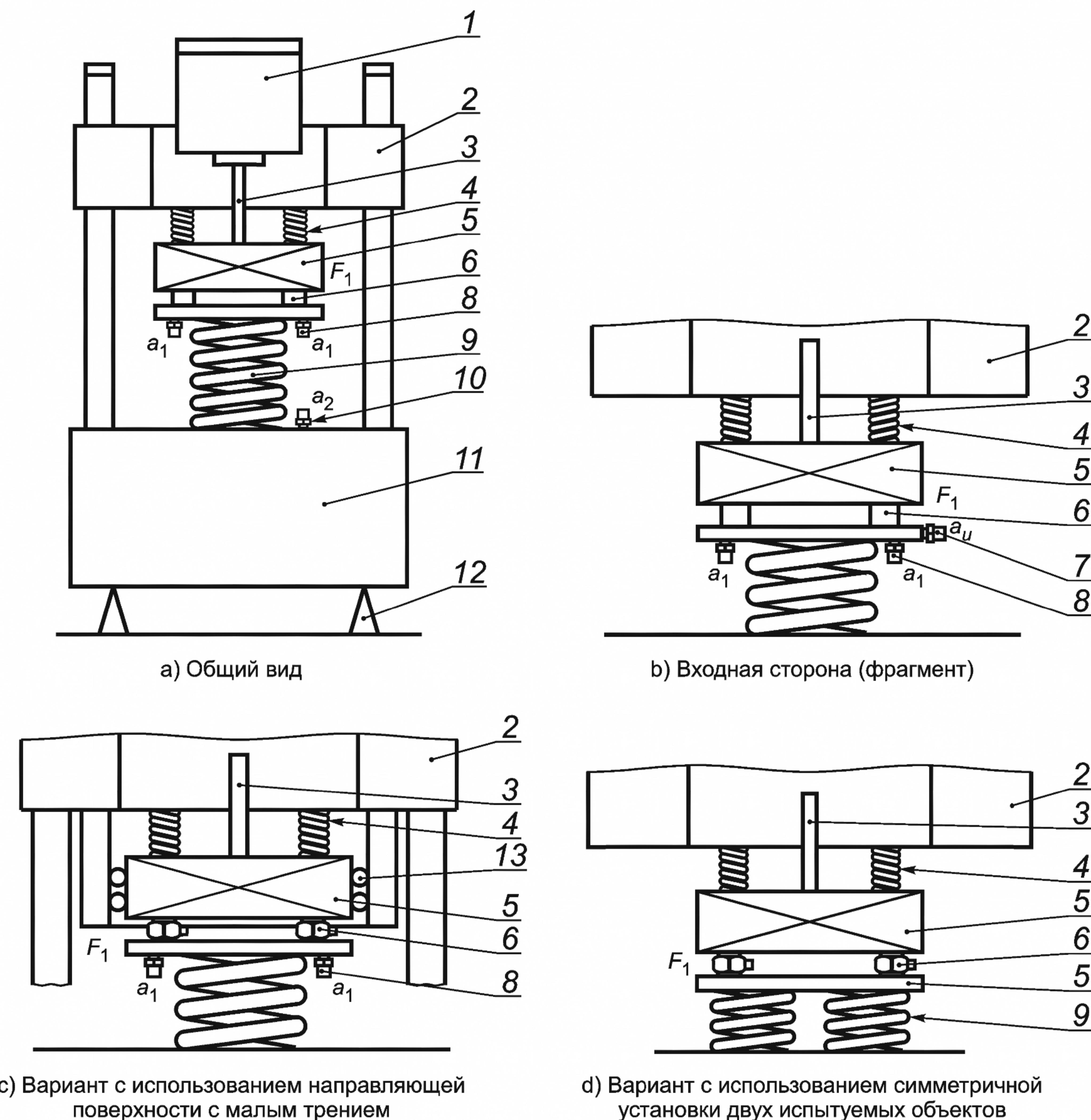
1 — вибровозбудитель; 2 — траверса; 3 — толкатель; 4 — вспомогательные виброизоляторы (статическая нагрузка); 5 — плита распределения вынуждающей силы; 6 — датчик силы (измерение  $F_1$ ); 7 — акселерометр (измерение ускорения  $a_u$  в направлении нежелательного возбуждения); 8 — акселерометр (измерение  $a_1$ ); 9 — испытуемый объект; 10 — акселерометр (измерение  $a_2$ ); 11 — жесткий фундамент; 12 — подвеска; 13 — направляющая поверхность с малым трением
