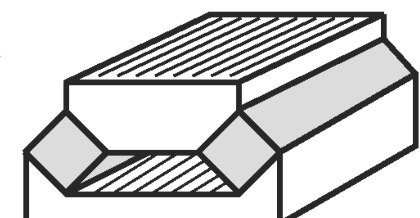
**Пример 2 — Три ортогональные плоскости симметрии (10 ненулевых элементов; 8 различных значений)**
