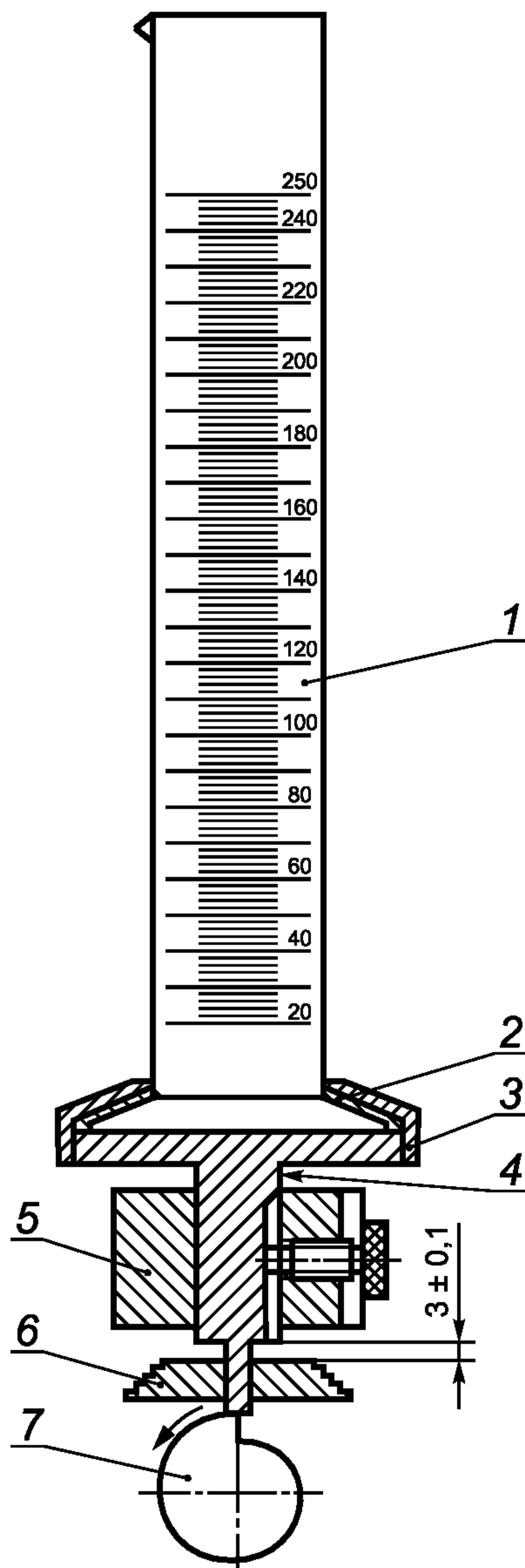
4.3 Установка для измерения насыпной плотности (см. рисунок 1) с компонентами.
