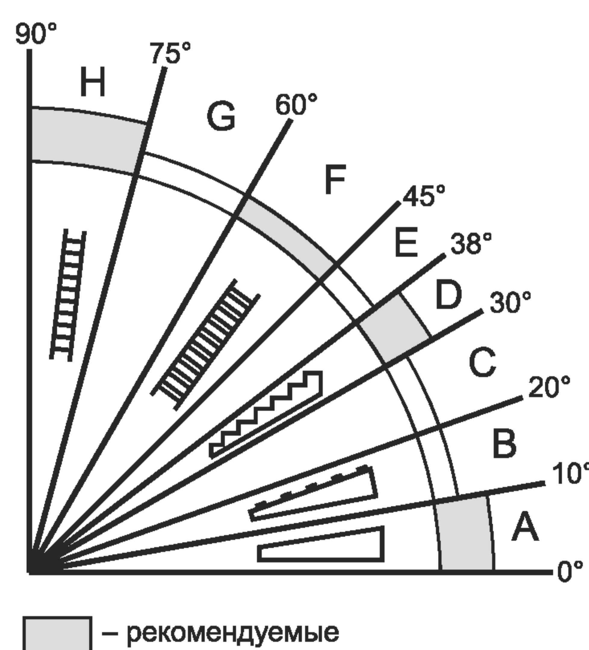
А — пандус рекомендуемый; В — пандус с повышенным сопротивлением скольжению; С — лестница с углом наклона от 20° до 30°; Д — лестница с углом наклона от 30° до 38°, рекомендуемая; Е — лестница с углом наклона от 38° до 45°; Ф — лестница с углом наклона от 45° до 60°, рекомендуемая; Г — лестница с углом наклона от 60° до 75°; Н — лестница вертикальная рекомендуемая
