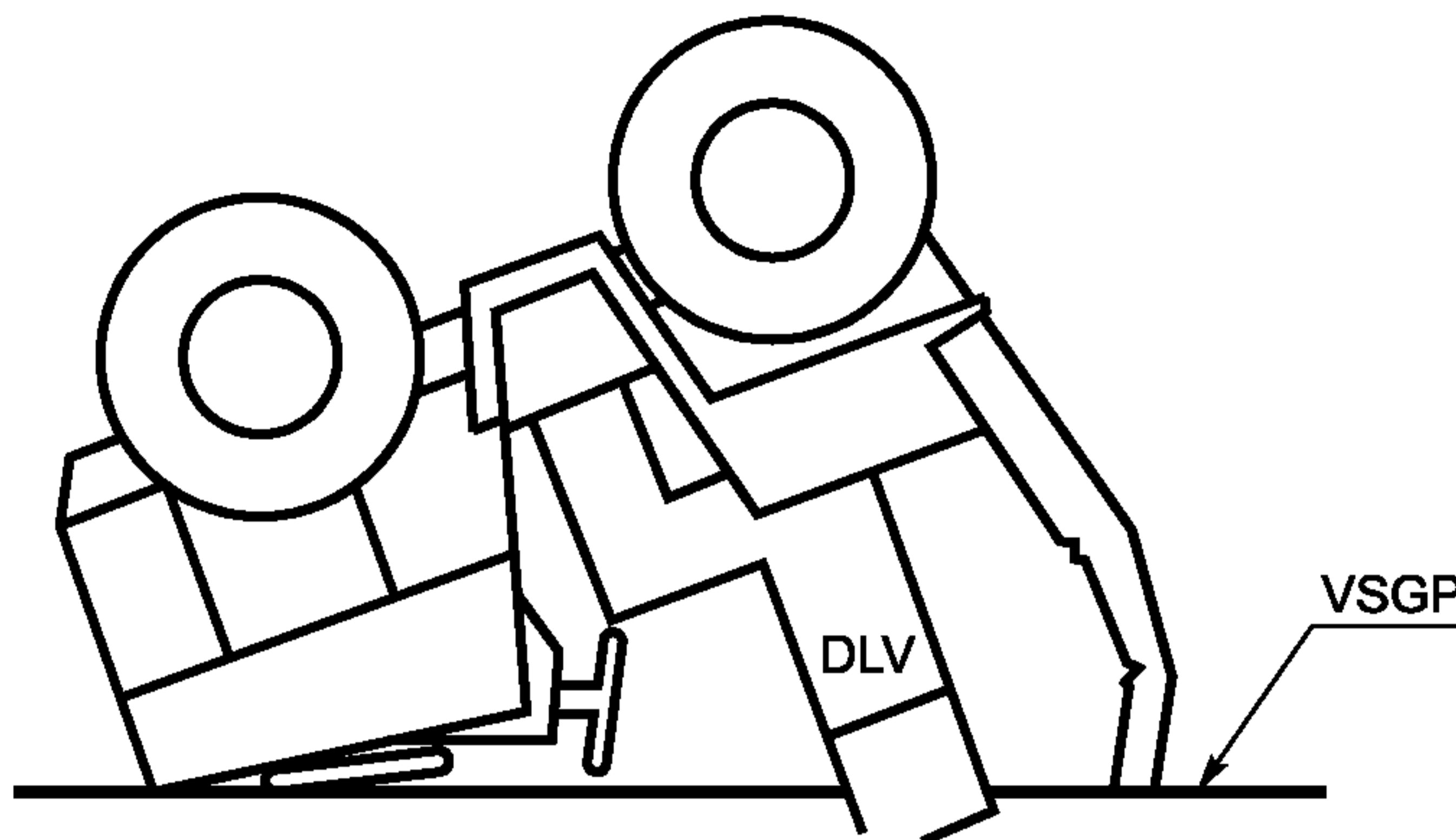
Рисунок 16 — Пример неприемлемого проникновения VSGP в DLV
