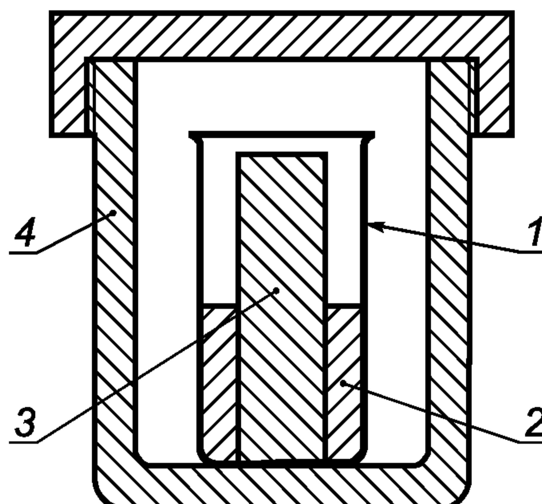
1 — химический стакан; 2 — пенетрант; 3 — испытательная пластина; 4 — калориметр
