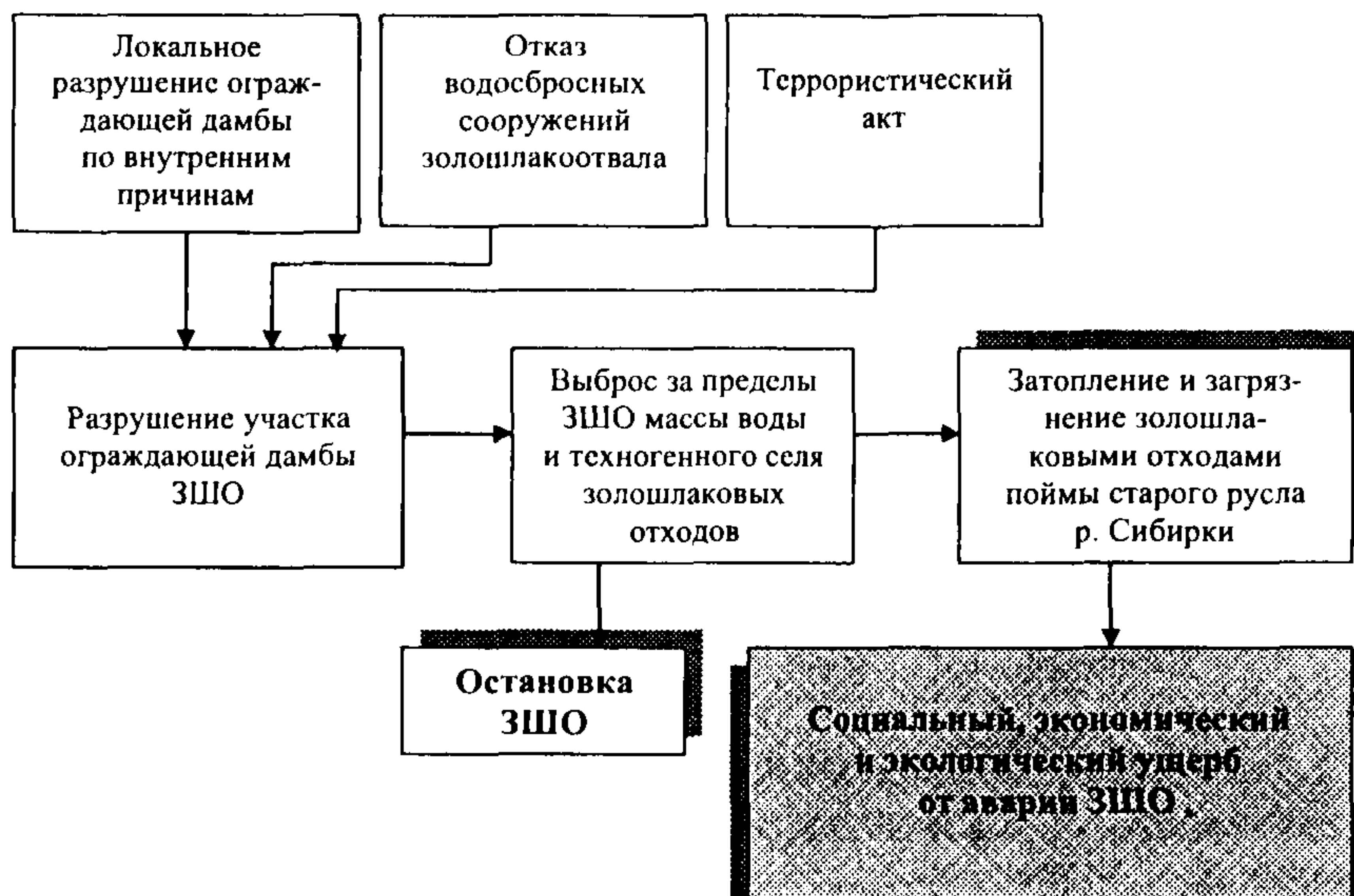
Рис. П2.12. Блок-схема анализа условий возникновения и развития аварий на золошлакоотвале № 2 Верхне-Тагильской ГРЭС.
