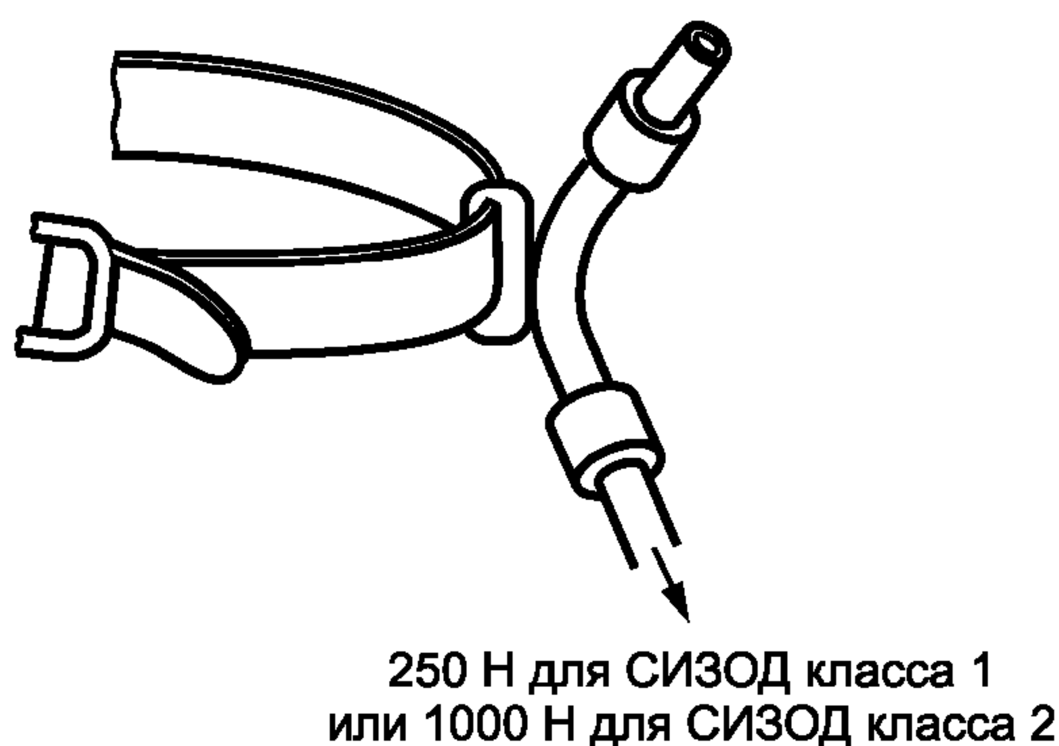
Рисунок 6 — Схема испытания прочности шланга подачи воздуха
