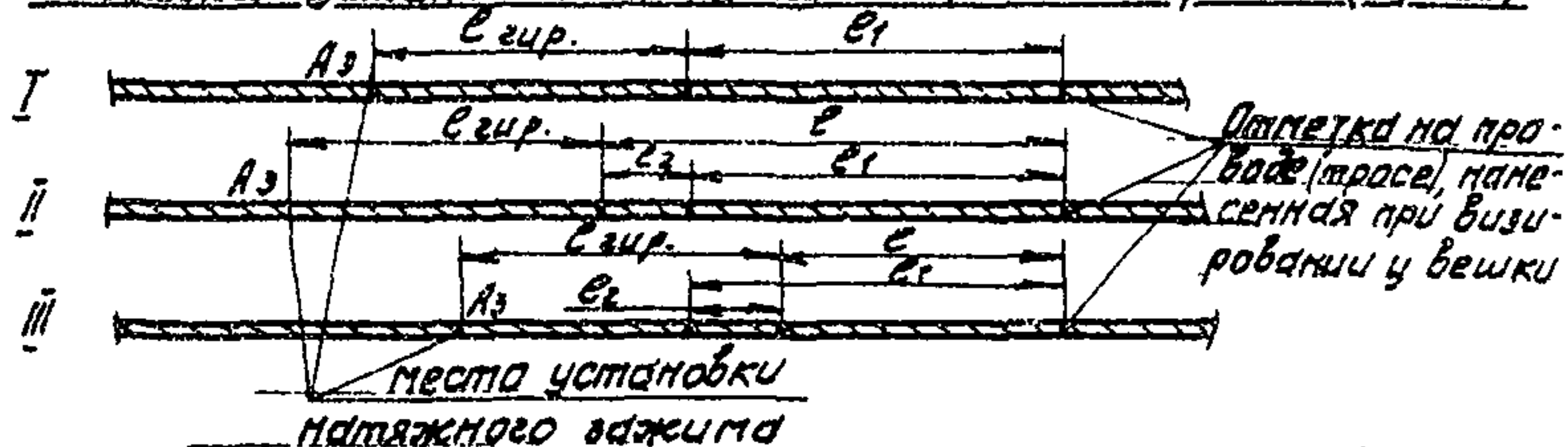
Рис. 12. Нанесение отметок на проводах (тросе) при визировании их без подъема на якорно-угловую опору
