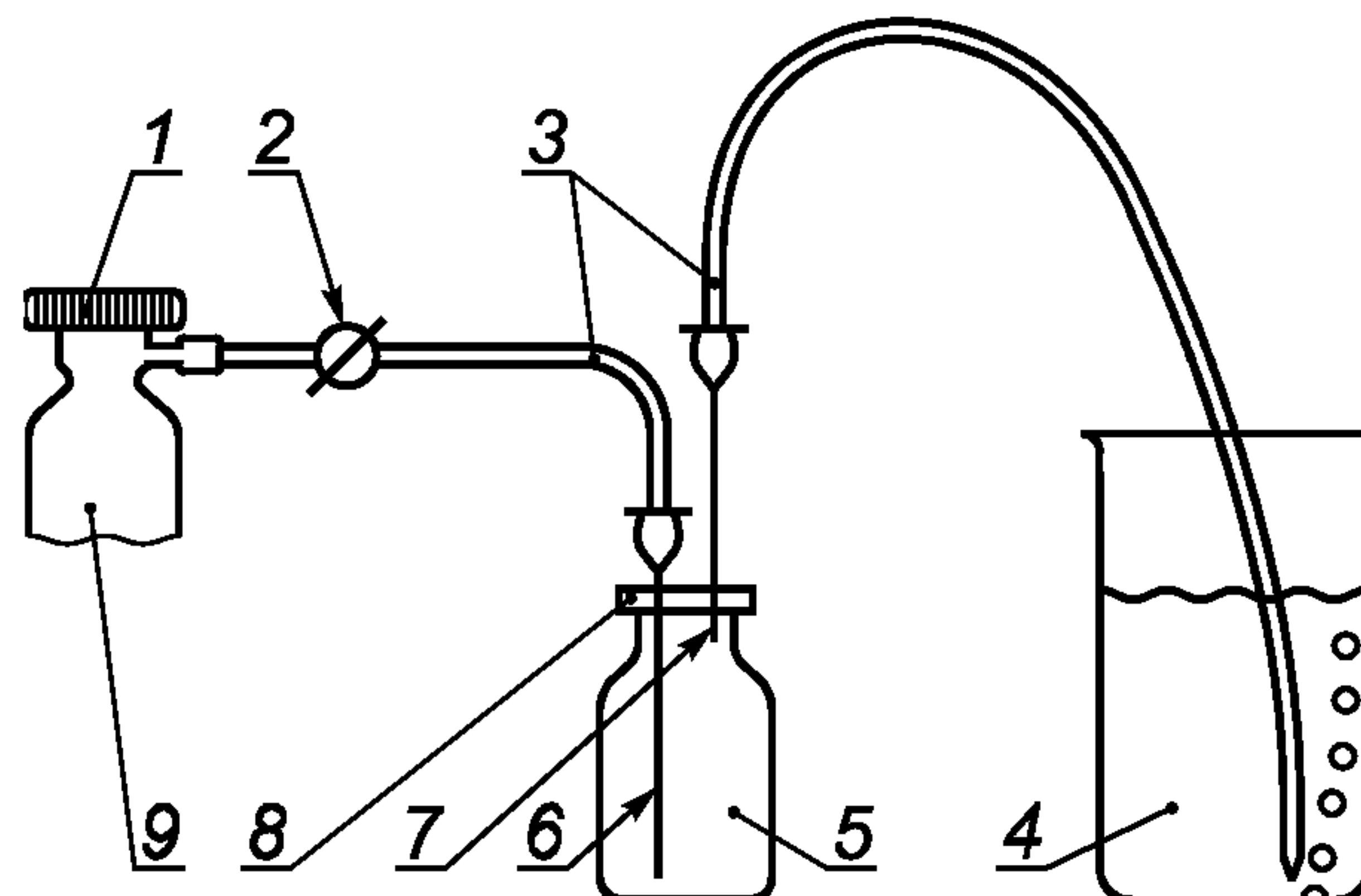
1 — клапан; 2 — регулятор; 3 — трубы ПВХ; 4 — стакан с водой; 5 — флякон; 6 — входная игла 1; 7 — выходная игла 2; 8 — завинчивающаяся крышка с ПТЭФ прокладкой; 9 — баллон с газообразным ЭО
