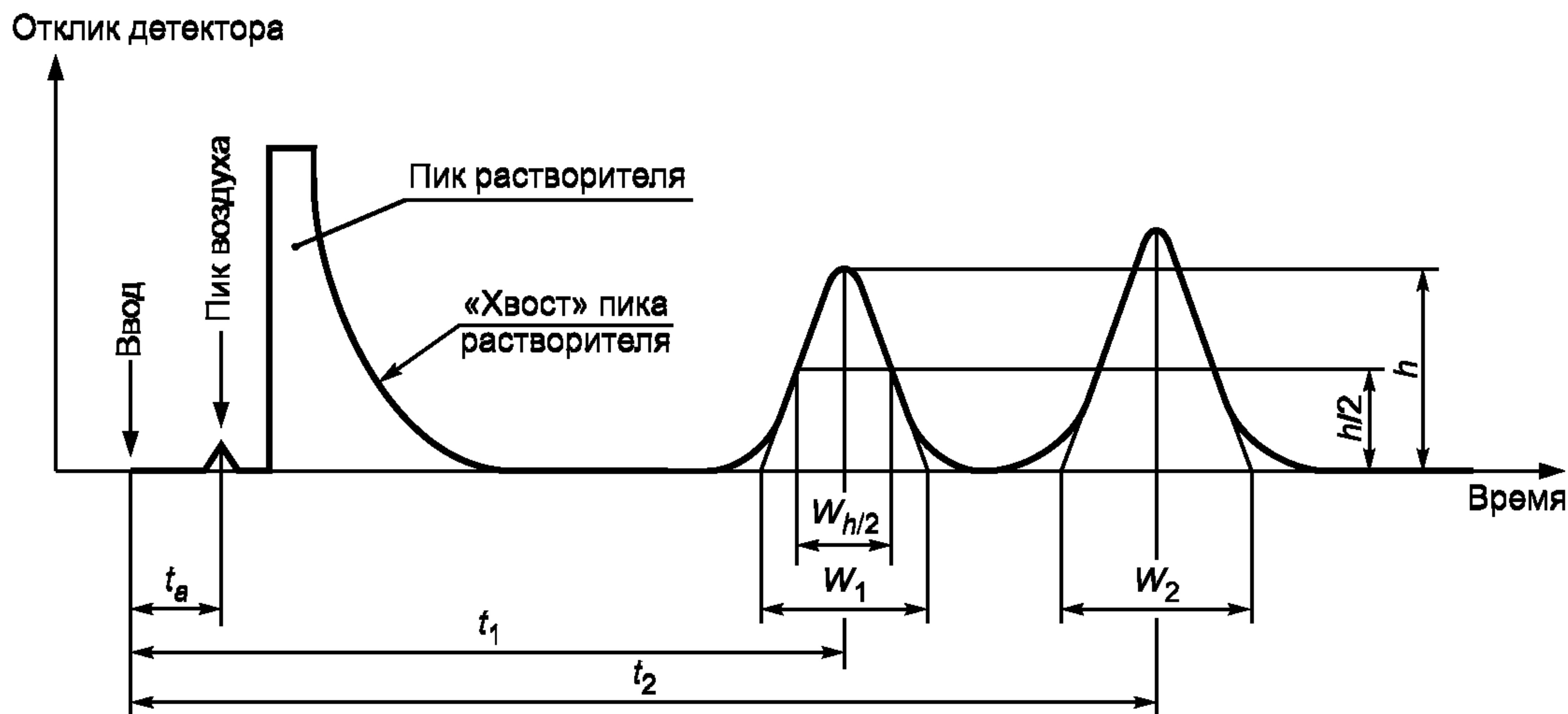
Рисунок А.1 — Хроматографическое разделение двух веществ
