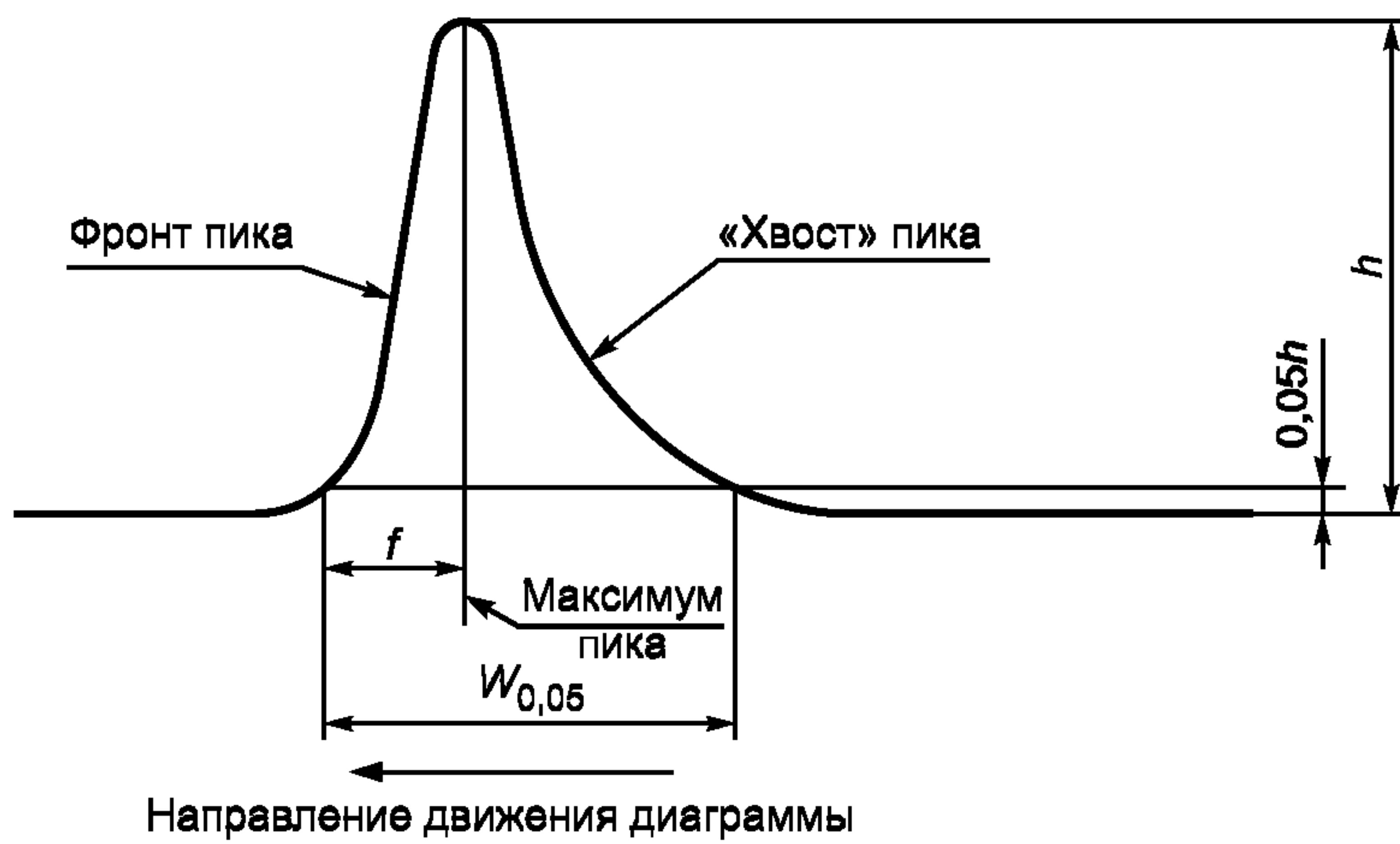
Рисунок А.2 — Асимметричный хроматографический пик
