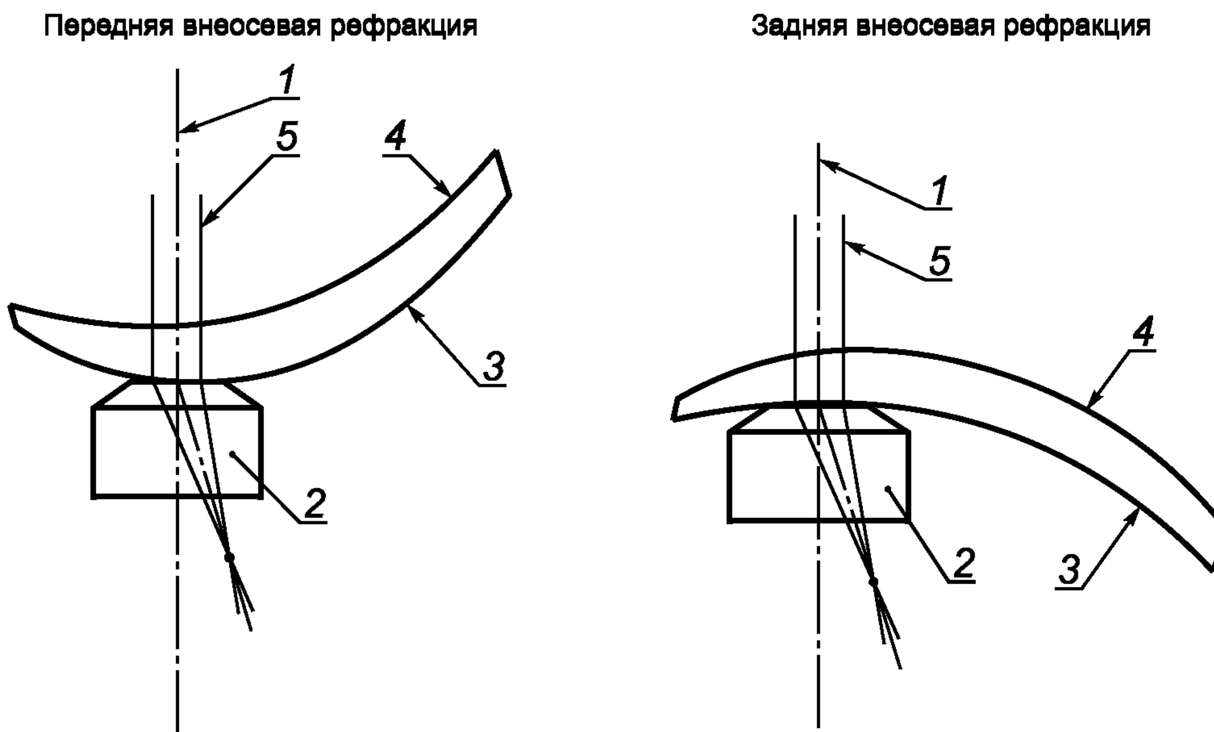
1 — ось диоптиметра, перпендикулярная к базовой поверхности; 2 — упор; 3 — базовая поверхность, равная передней поверхности при измерении передней внеосевой рефракции и равная задней поверхности при измерении задней внеосевой рефракции; 4 — противоположная поверхность линзы; 5 — фокус пучка, находящийся на оси диоптиметра (1)
