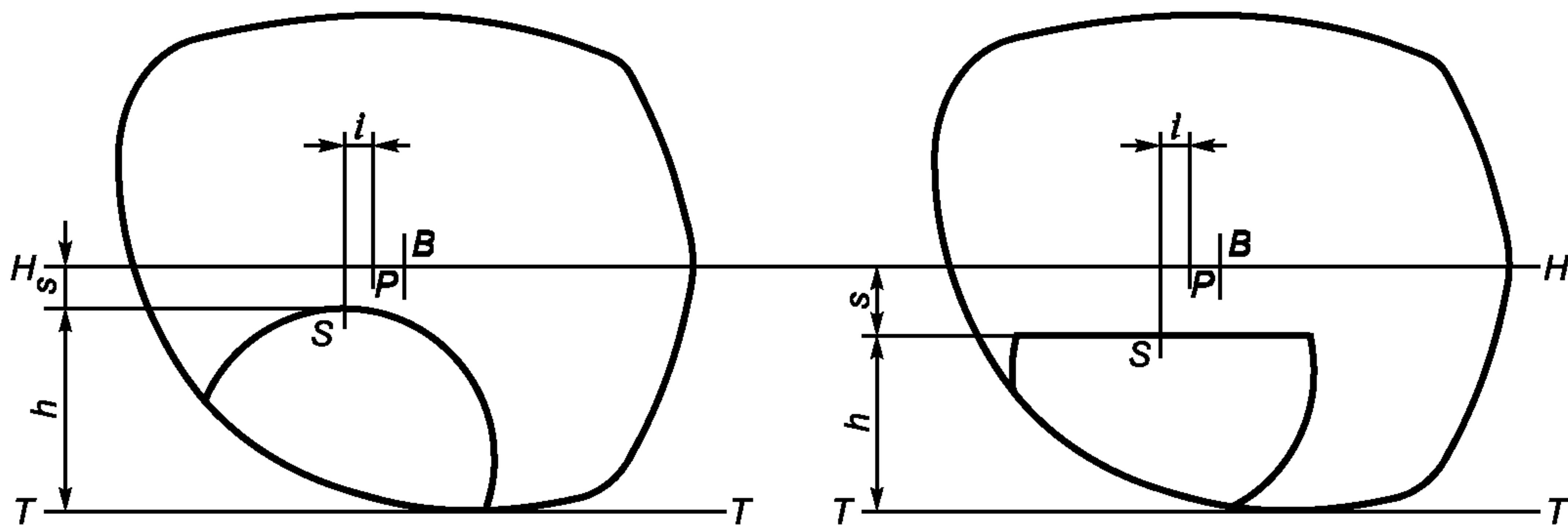
$B$  — центр габаритного прямоугольника фасетированной линзы;  $HH$  — горизонтальная средняя линия;  $P$  — точка центровки для дали;  $S$  — крайняя точка сегмента;  $TT$  — горизонтальная касательная к краю фаски (при ее наличии) кромки линзы в ее нижней точке;  $h$  — высота сегмента;  $i$  — геометрическое смещение центра;  $s$  — положение крайней точки сегмента
