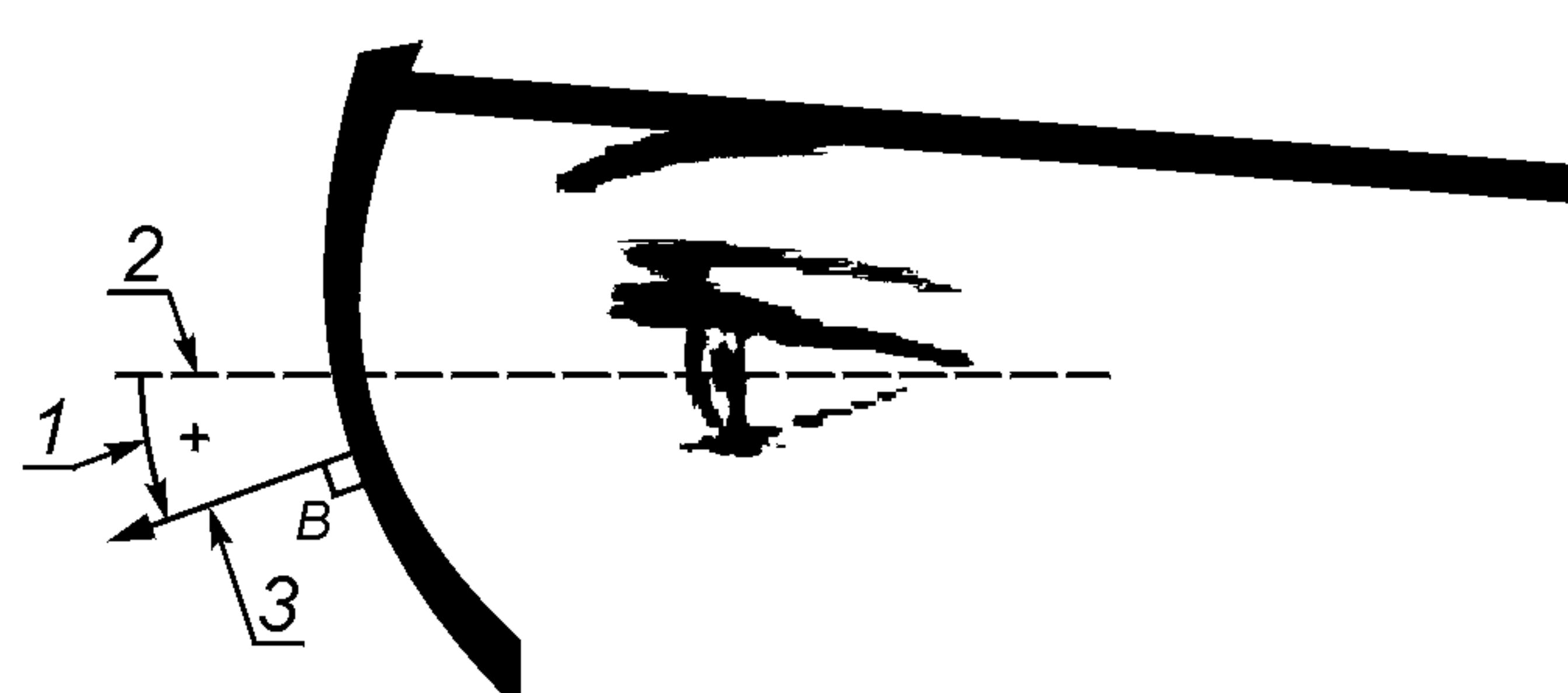
1 — пантоскопический угол носящего очки; 2 — исходное положение, принимаемое за горизонтальное; 3 — оптическая ось очковой линзы; В — горизонтальная средняя линия
