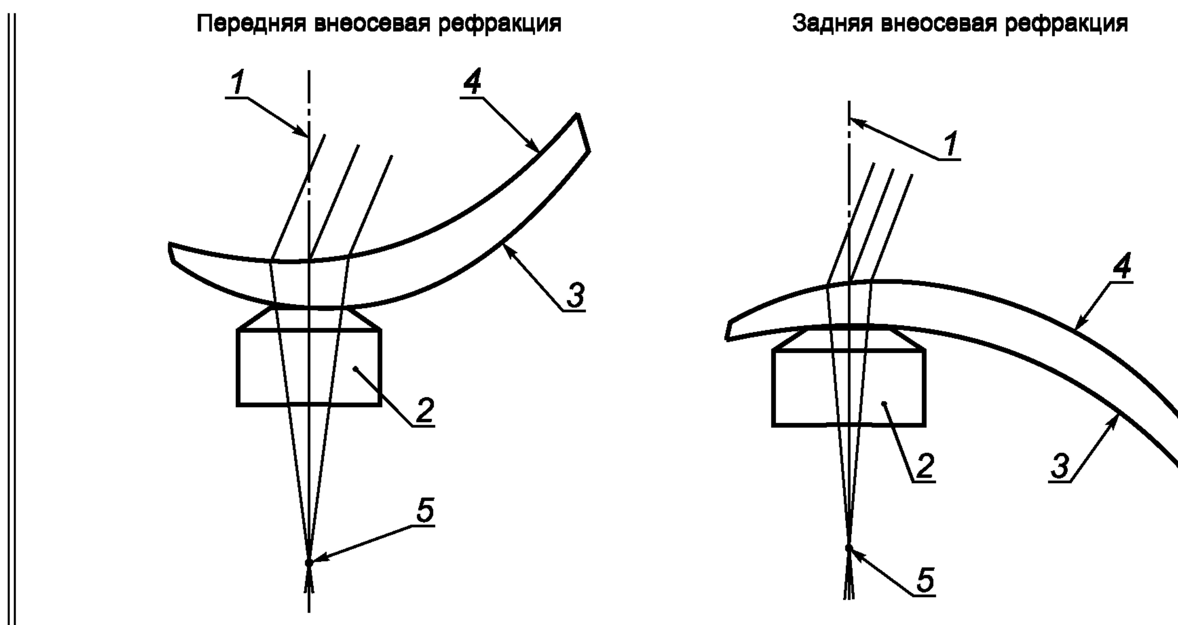
1 — ось диоптиметра, перпендикулярная к базовой поверхности; 2 — упор; 3 — базовая поверхность, равная передней поверхности при измерении передней внеосевой рефракции и равная задней поверхности при измерении задней внеосевой рефракции; 4 — противоположная поверхность линзы; 5 — фокус пучка, находящийся на оси диоптиметра (1)
