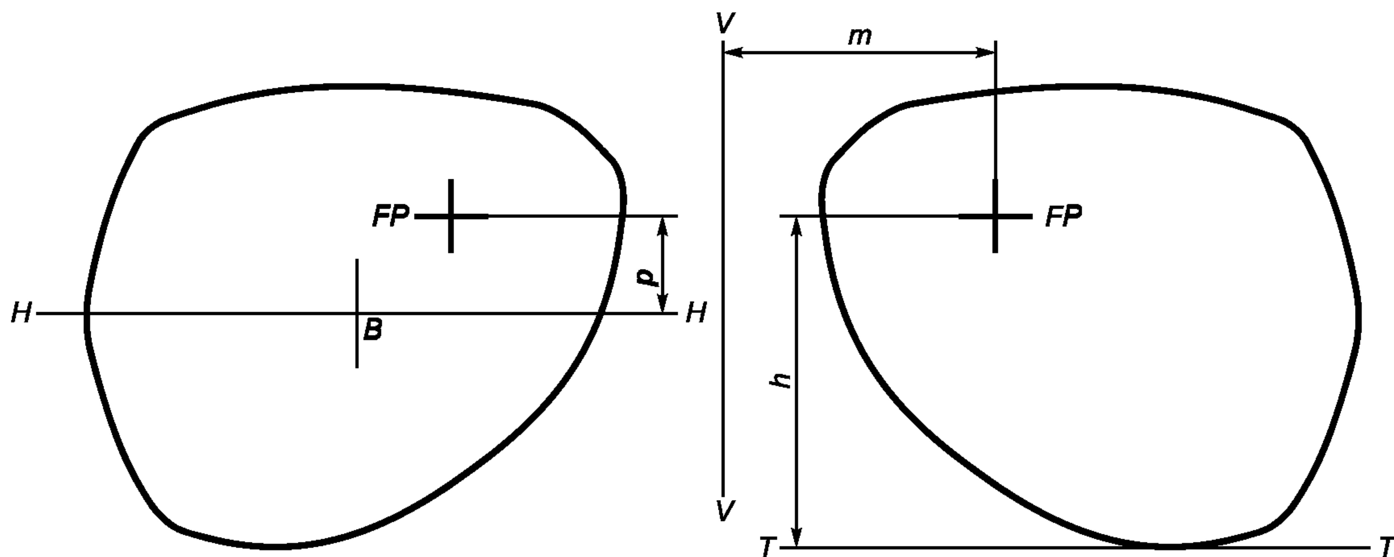
*B* — центр габаритного прямоугольника; *FP* — точка фиксации; *HH* — горизонтальная средняя линия; *TT* — касательная к линзе в ее нижней точке; *VV* — вертикальная ось симметрии; *h* — высота точки фиксации; *m* — монокулярное центровое расстояние; *p* — вертикальная составляющая положения точки фиксации
