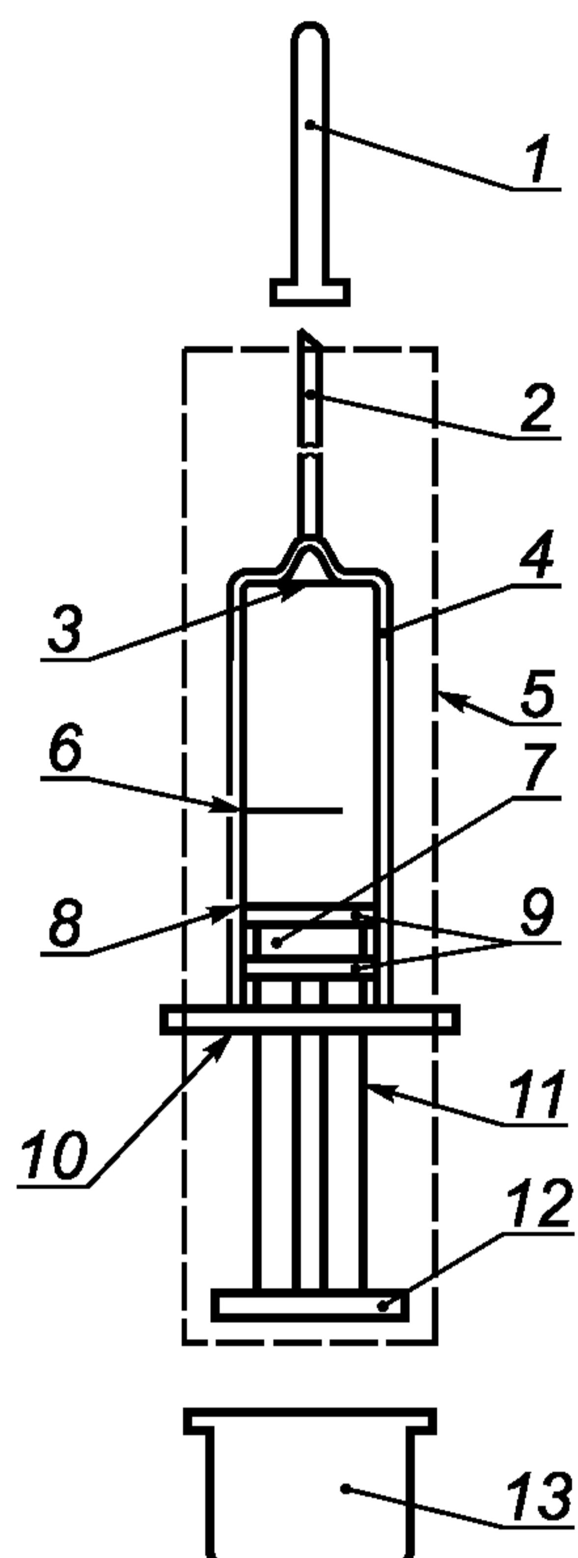
1 — колпачок (если используется); 2 — игла; 3 — нулевая линия градуировки; 4 — цилиндр; 5 — устройство, препятствующее повторному применению; 6 — линия номинальной вместимости; 7 — поршень; 8 — основная линия; 9 — уплотнитель; 10 — упоры для пальцев; 11 — шток; 12 — упор штока; 13 — защитный задний колпачок
