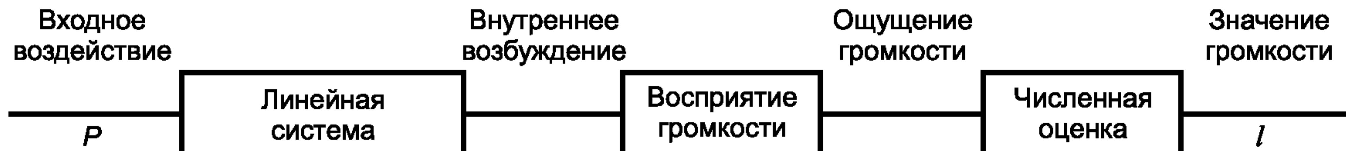
Рисунок С.1 — Блок-схема модели процесса оценки громкости
