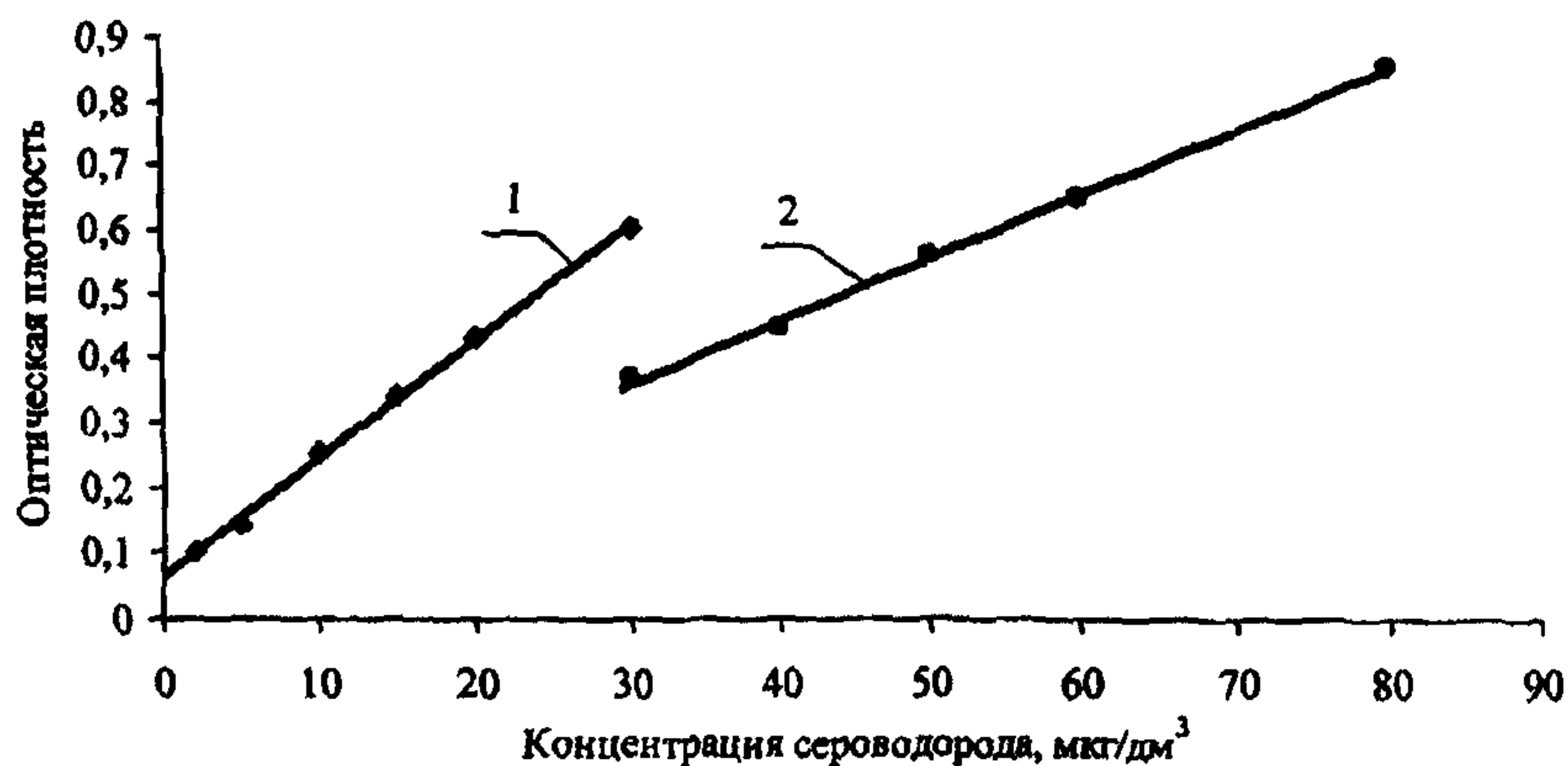
Рисунок Г.1 - Градуировочные зависимости для экстракционно-фотометрических измерений на спектрофотометрах или фотометрах с непрерывной разверткой спектра при длине волны 656 нм
