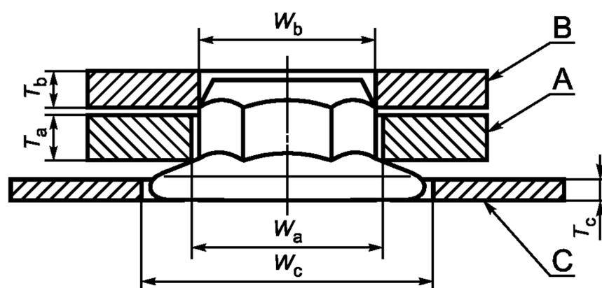
Рисунок А.1 — Схема контроля шестигранника и фланца
