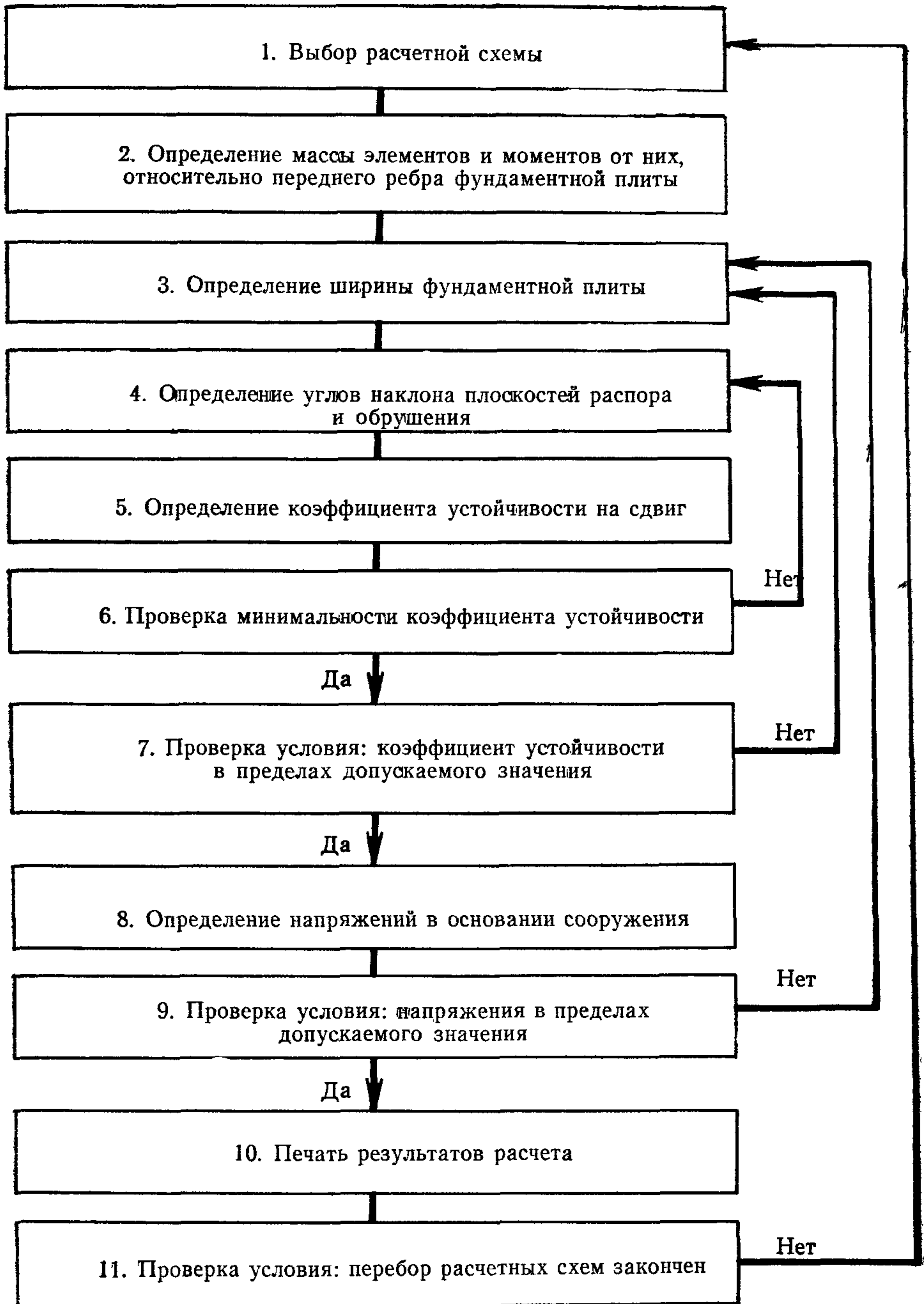
Рис. П.3.1. Блок-схема программы «Сдвиг» расчета ширины фундаментной плиты
