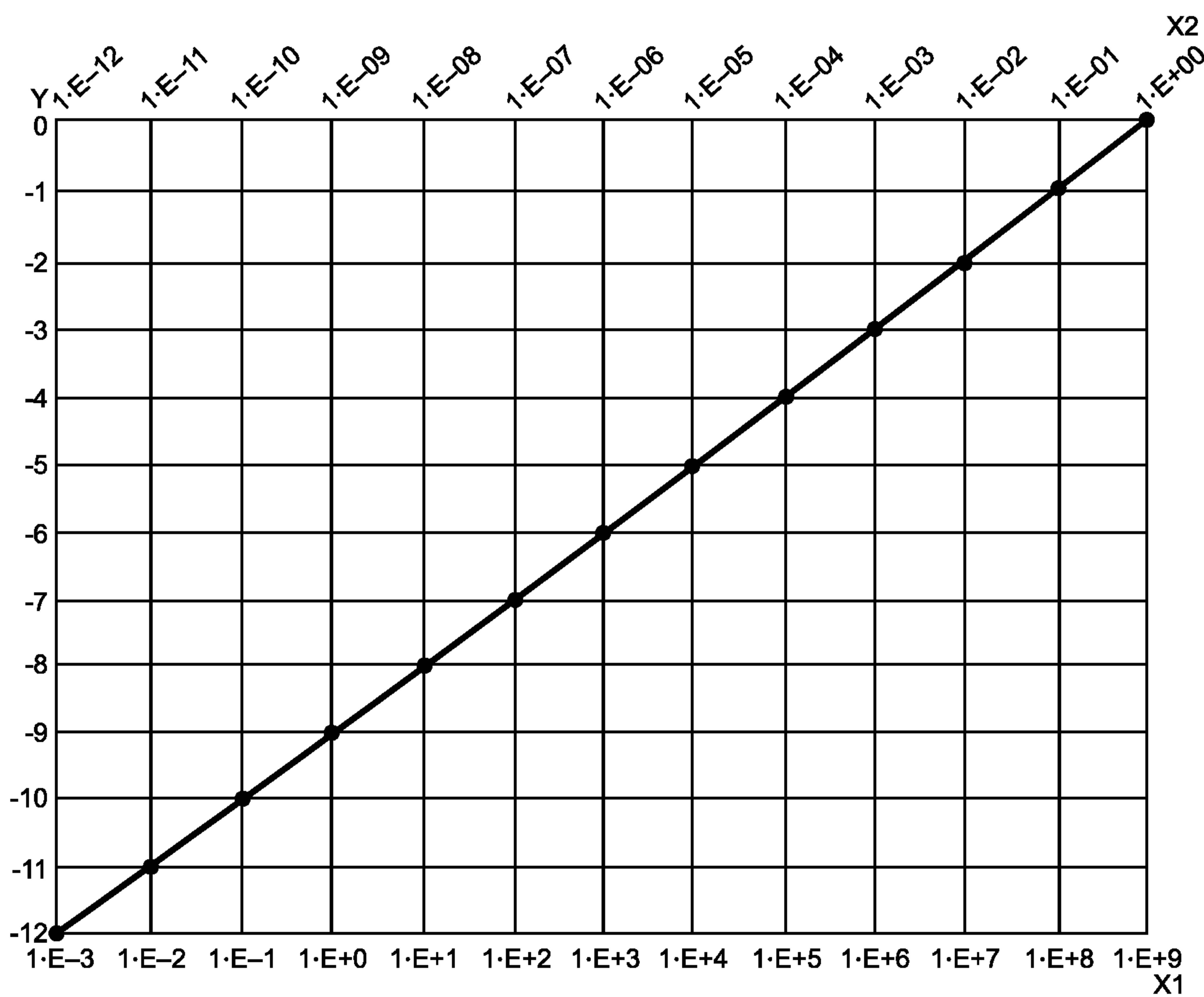
X1 — концентрация (нг/м<sup>3</sup>), X2 — концентрация (г/м<sup>3</sup>), Y — класс ИСО-АМС
