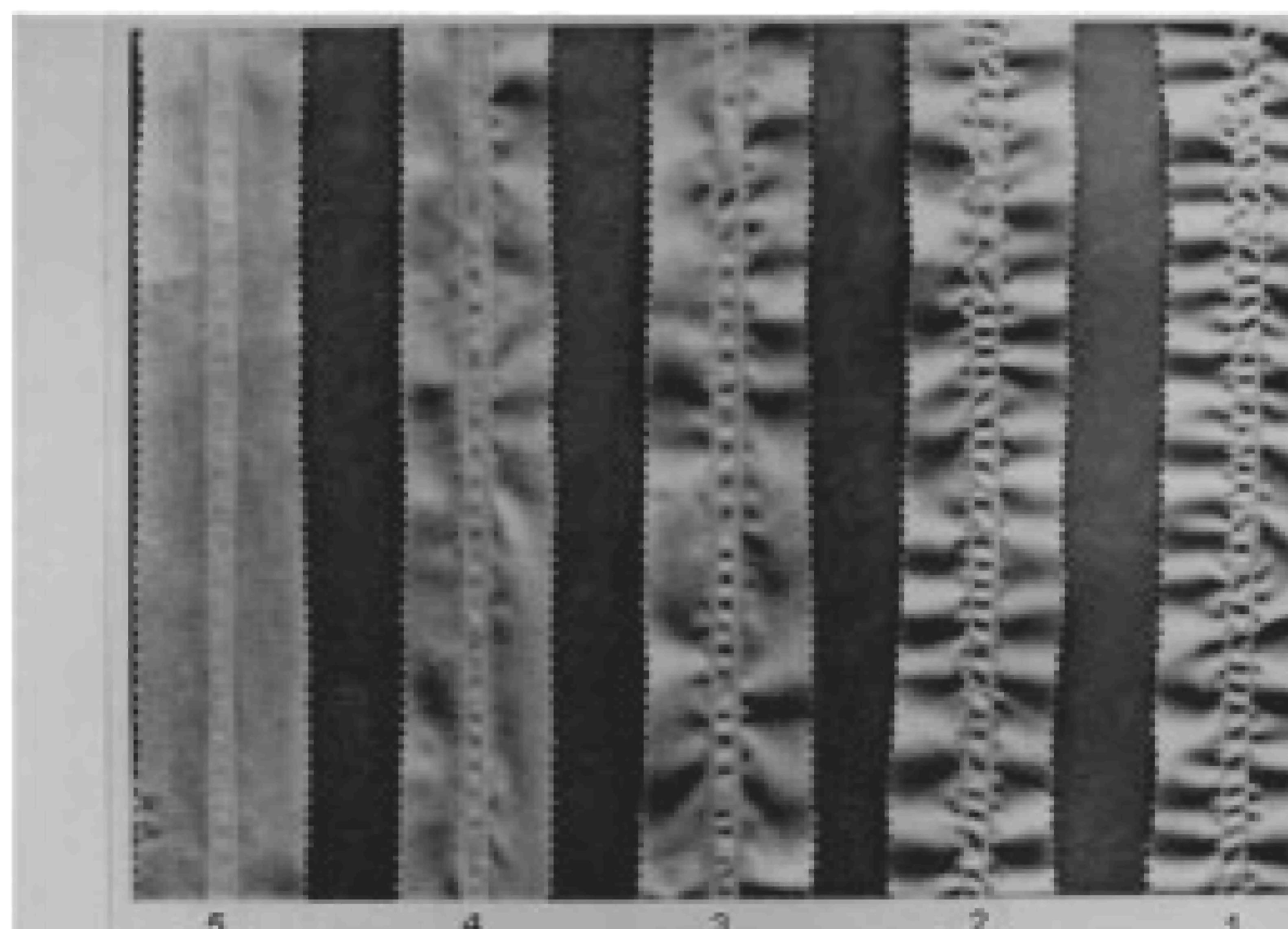
Рисунок 3 — Фотография сравнительной шкалы для двойных швов
