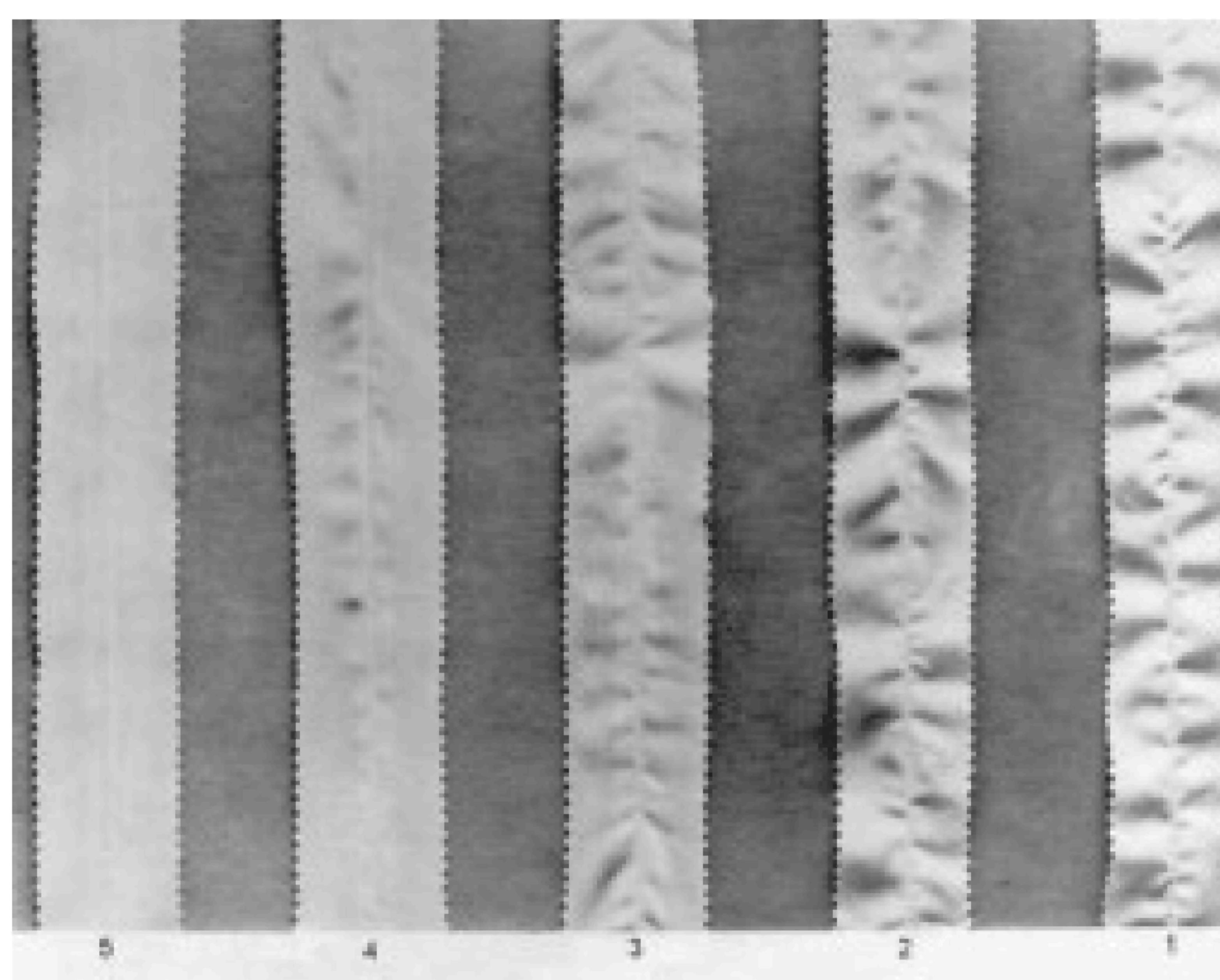
Рисунок 2 — Фотография сравнительной шкалы для одинарных швов
