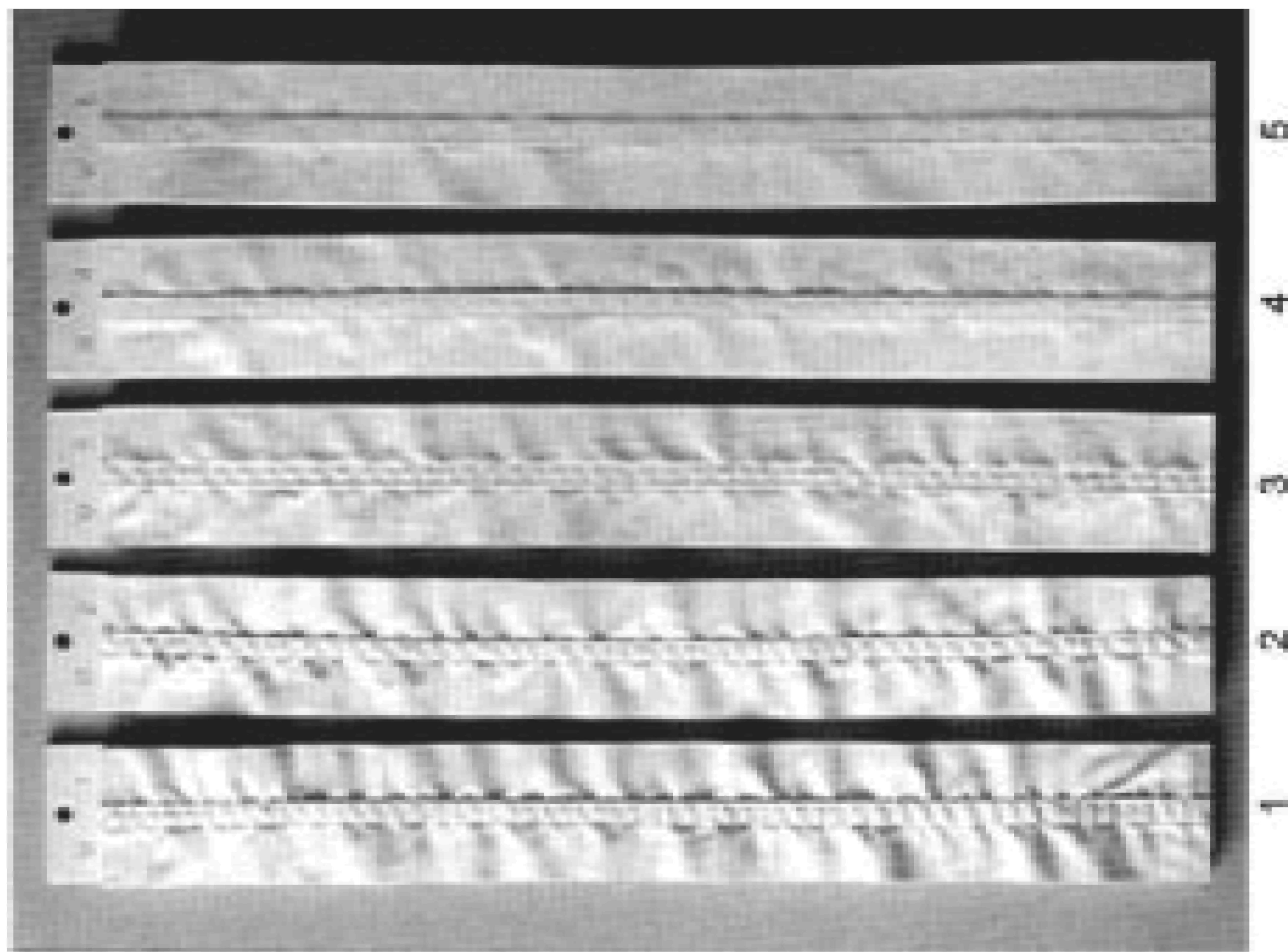
Рисунок 5 — фотография сравнительной шкалы на пластмассовых эталонах для двойных швов
