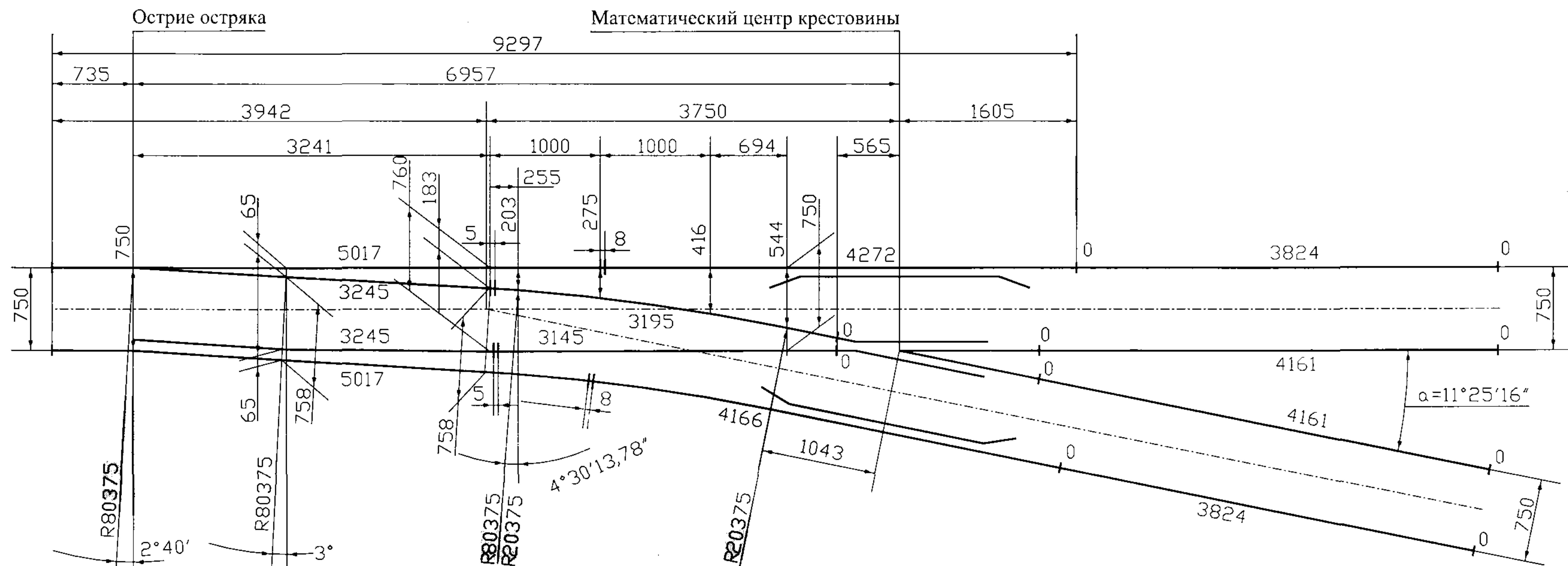
Схема геометрических размеров стрелочного перевода т.Р50 м.1/5 колеи 750мм. пр. 2673.00.000
