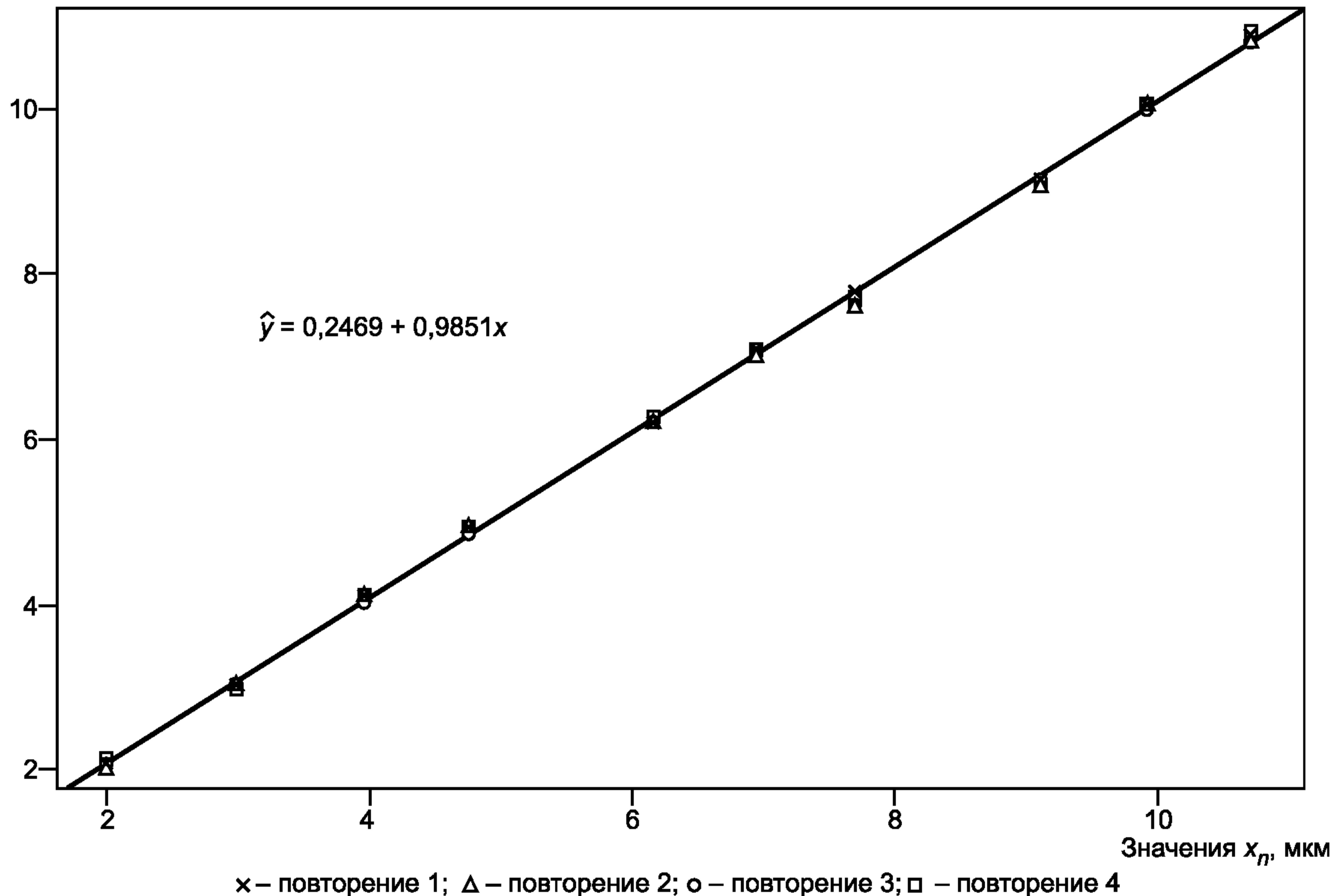
Рисунок 10 — Функция калибровки в предположении о пропорциональности стандартного отклонения остатков
