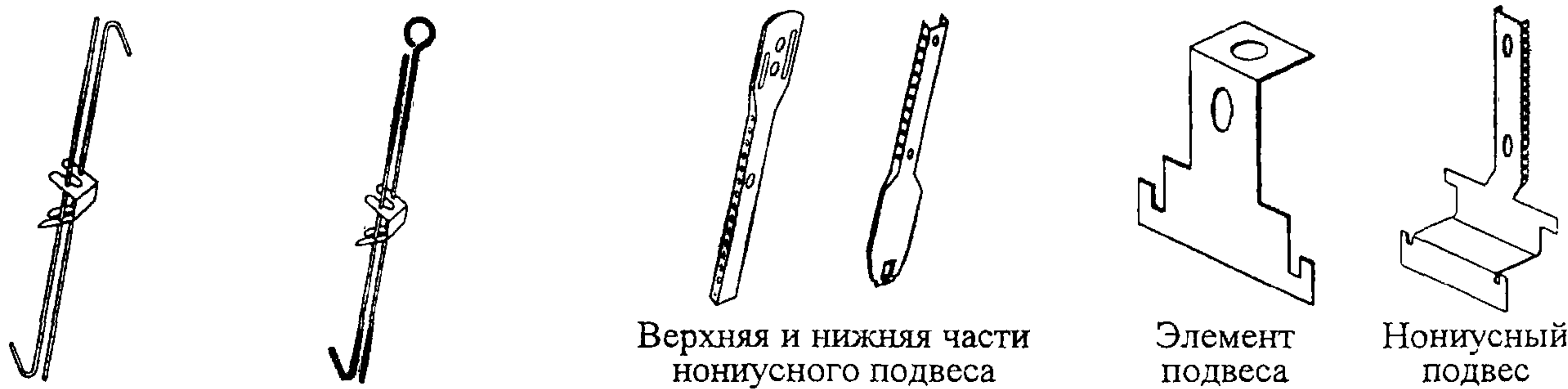
Рисунок 13 – Варианты подвесов системы Trulok
