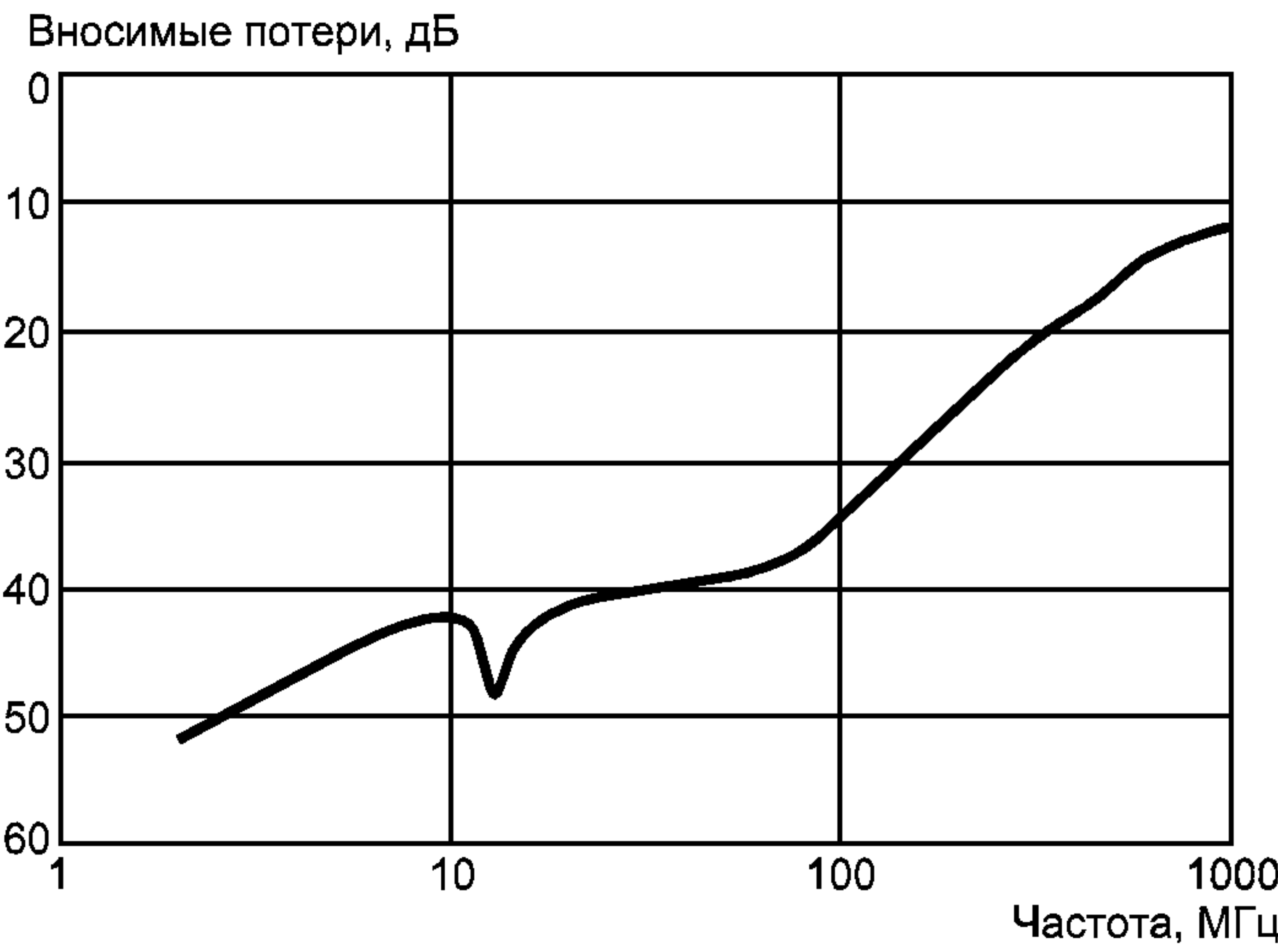
Рисунок Б.8 — Потери, вносимые коаксиальным адаптером, нагруженным на сопротивление 50 Ом с расположенным внутри токосъемником. Токосъемник также нагружен на сопротивление 50 Ом
