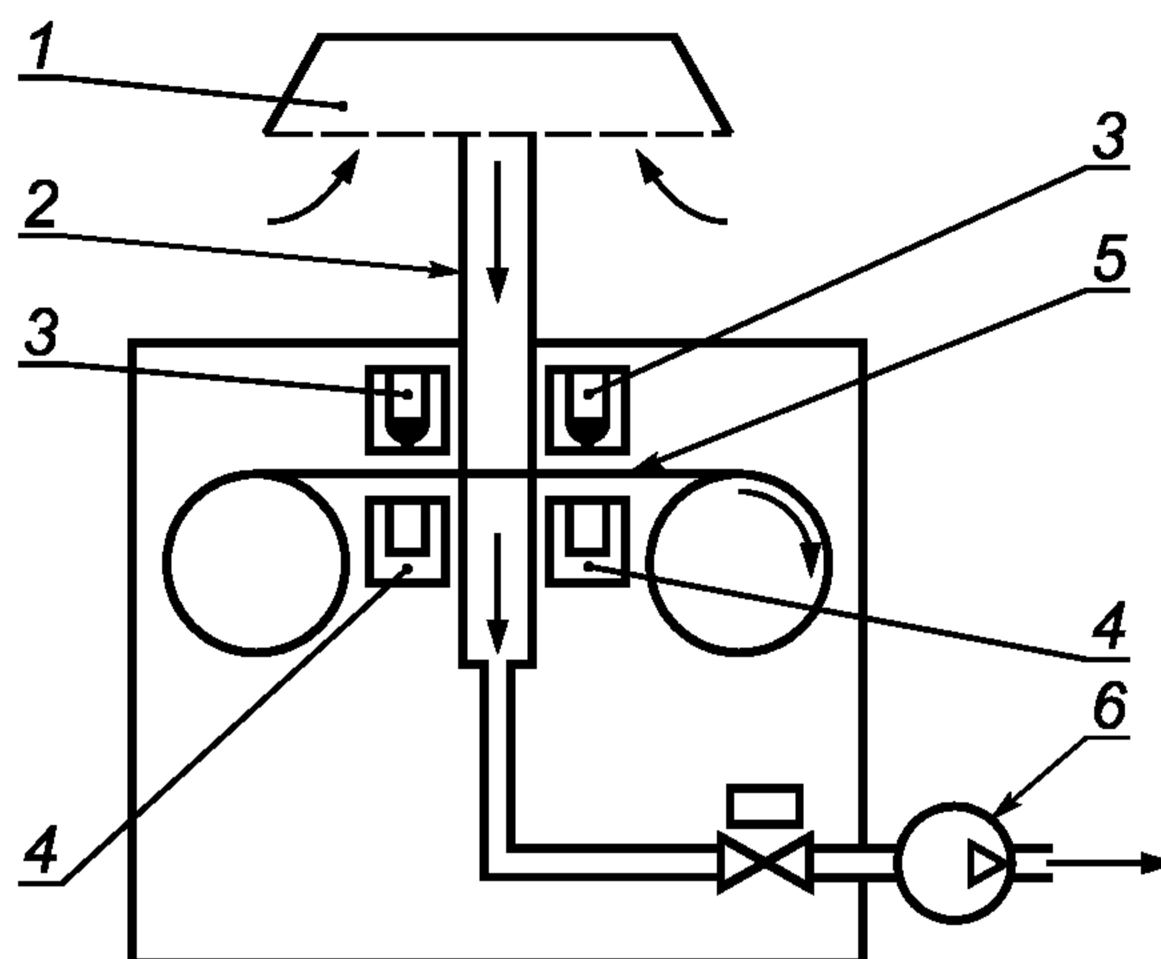
1 — устройство для фракционного разделения частиц пробы; 2 — трубка для отбора проб; 3 — блок источника бета-излучения;
