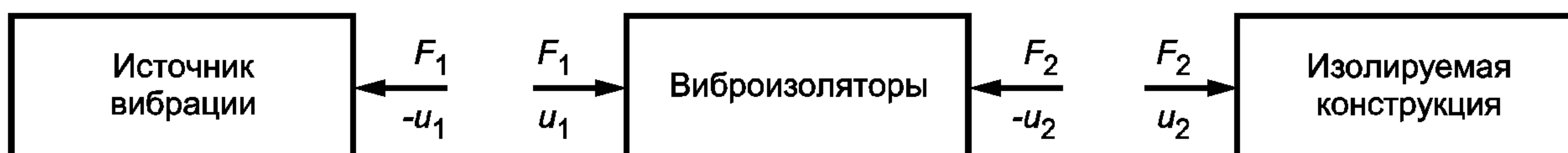
Рисунок 1 — Блок-схема системы «источник вибрации — виброизоляторы — изолируемая конструкция»
