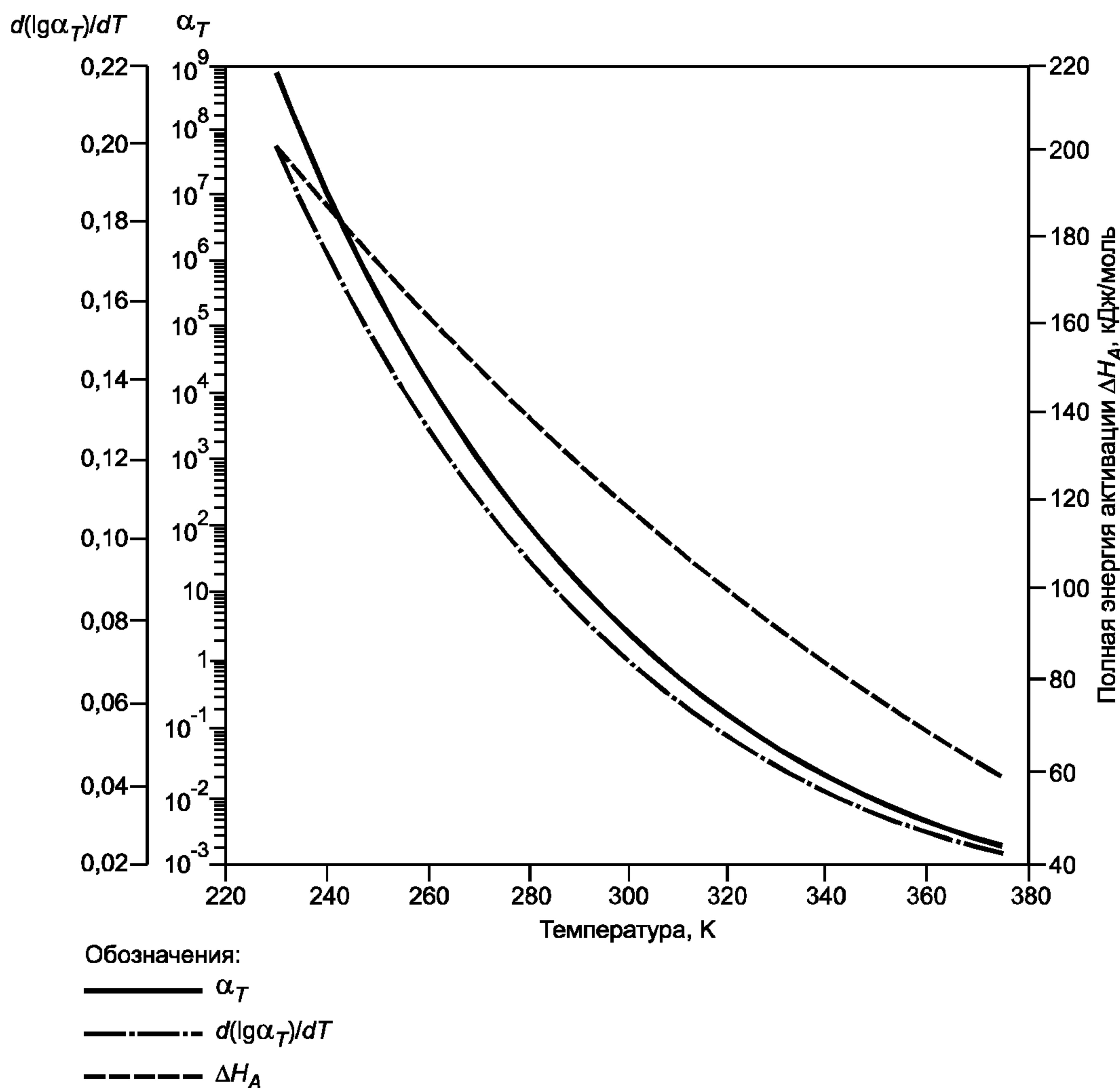
Рисунок 2 — Функция температурного смещения
